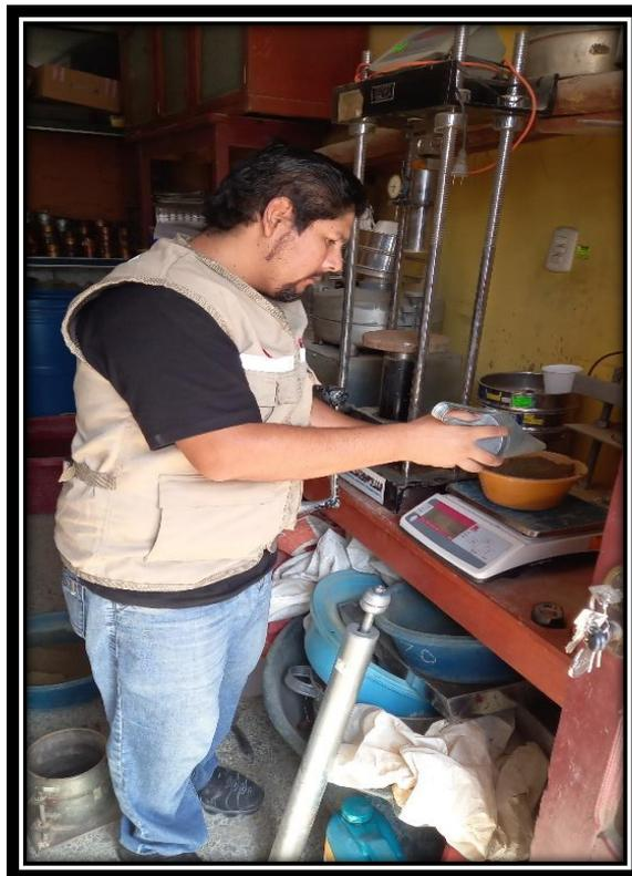
**Foto N° 13:** Pesando una de las 5 partes de la muestra
