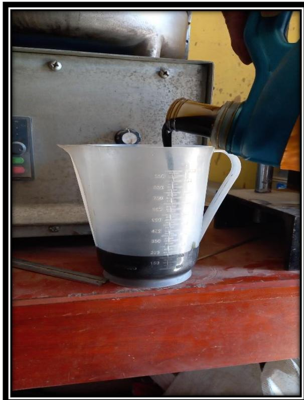
**Foto N° 11:** Dosificación del aceite reciclado de motor
