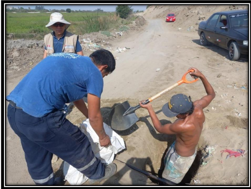
**Foto N° 03:** Extracción de la muestra de la C-2
