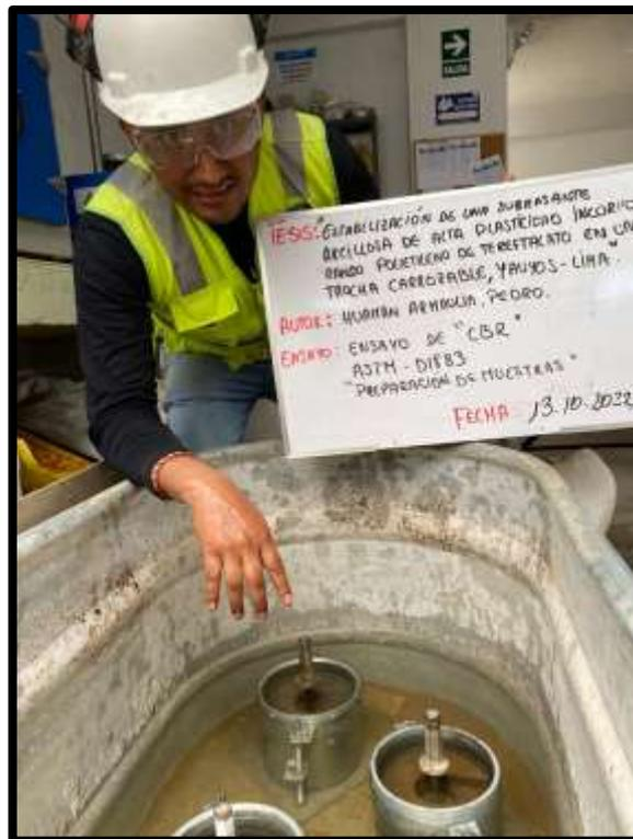
Figura 32. CBR, Saturación de Material.
