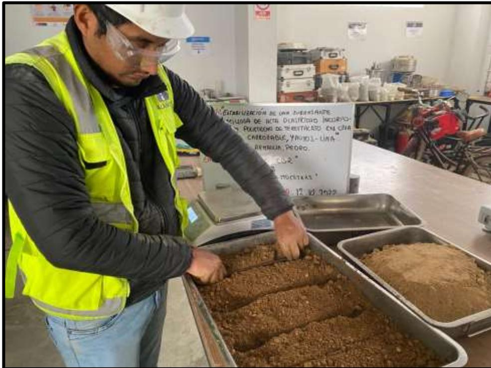
Figura 26. Proctor para CBR, material húmedo separado en 5 partes iguales.
