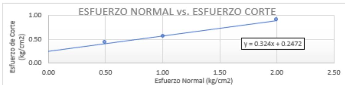
Figura 68. Deformación N. vs. Esfuerzo C. (C-2, M-1) + 5% de fibra.
