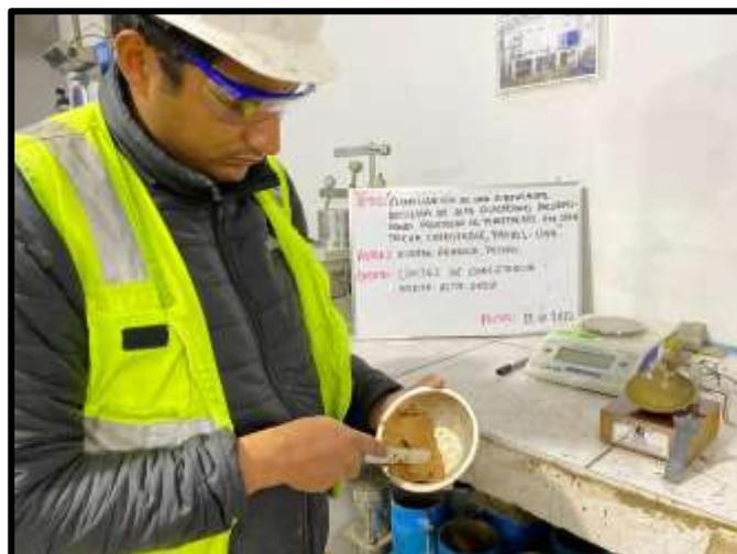
Figura 20. Pasta para hallar Limite Liquido y plástico.
