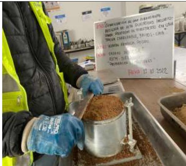
Ensayo de CBR, material compactado
