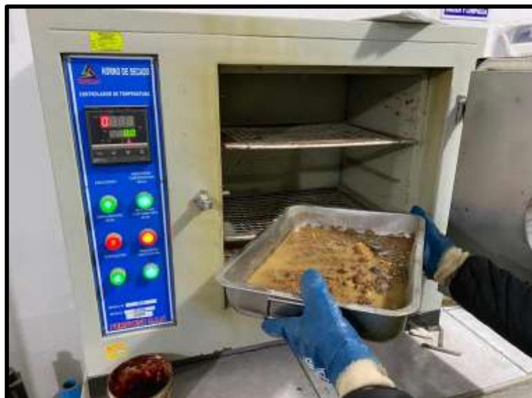
Figura 18. Secado de muestra en horno.
