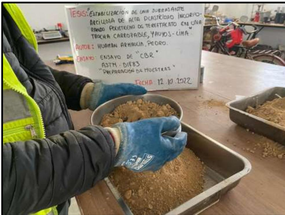
Figura 25. Proctor para CBR, tamizado por malla  $\frac{3}{4}$ ".
