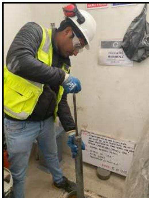
Figura 27. Proctor para CBR, compactación con el pisón.
