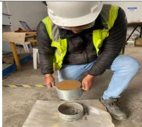
Ensayo de CBR, material compactado
