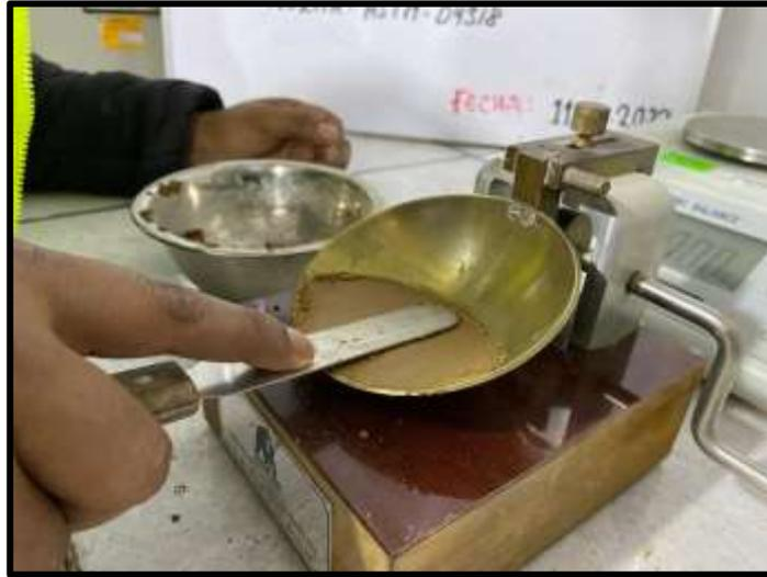
*Figura 21. Ensayo de limite liquido – Copa Casagrande.*
