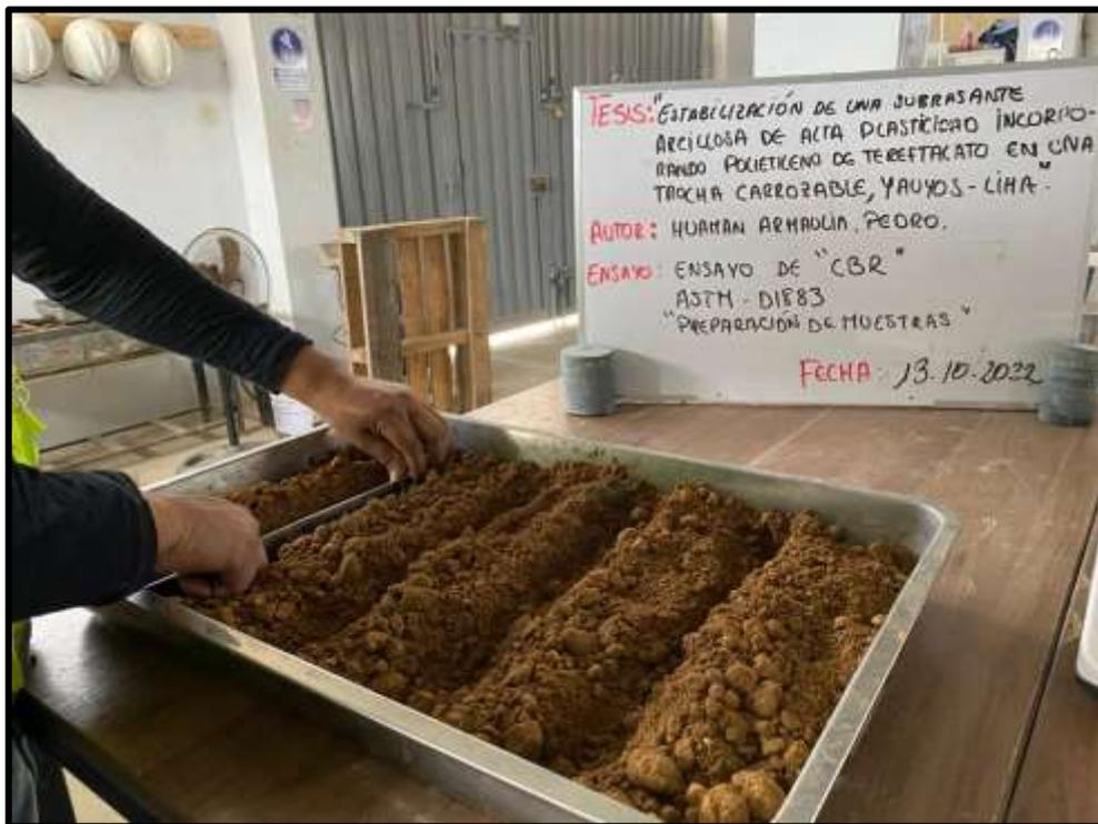
Figura 30. CBR, material húmedo separado en 5 partes iguales.
