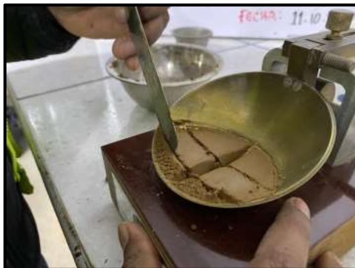
*Figura 22. Muestra ensayada – Copa Casagrande.*
