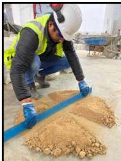
*Figura 16.* Técnica del cuarteo para clasificación.
