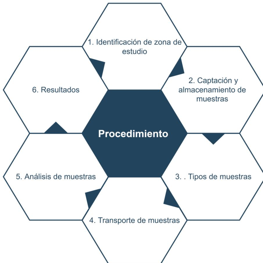
**Figura 3.** Diagrama del procedimiento para la recolección de muestras.
