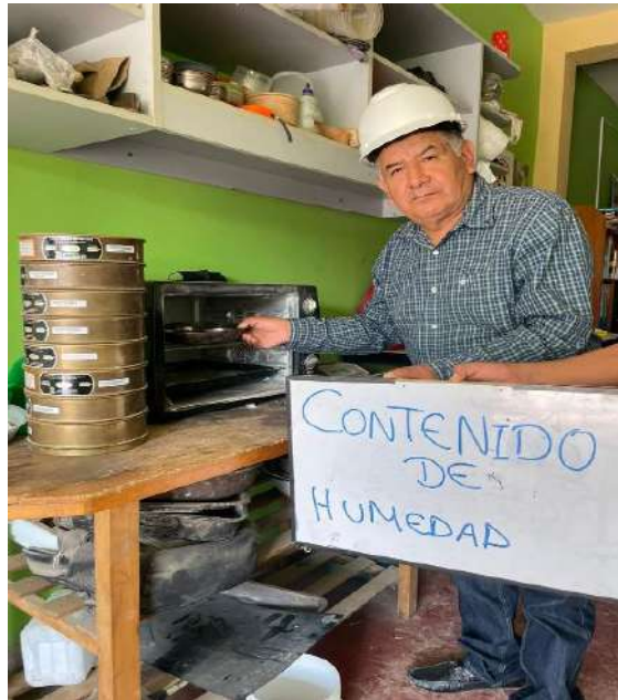
Figura 1. Llevando muestras al horno para el ensayo de Contenido de Humedad, C-1.
