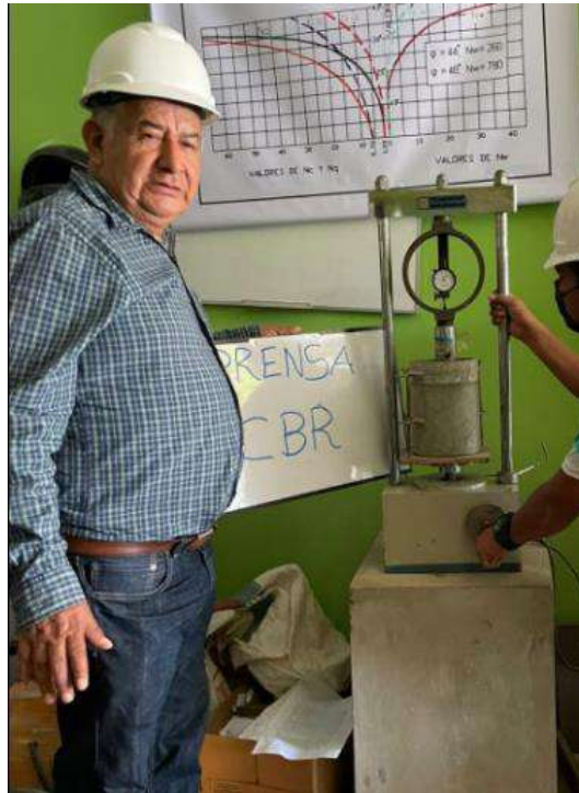
Figura 5. Realizando el ensayo del CBR Fuente: Elaboración propia.
