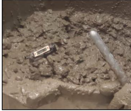
Figura 8: Temperatura del concreto
