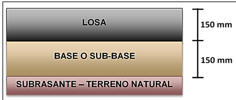
Figura 19: Estructura del pavimento rígido elegida
