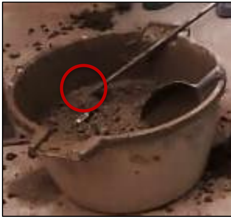
Figura 31: Colocación del termómetro en el concreto fresco
