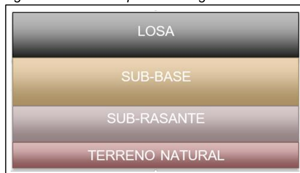
Figura 1: Sección de pavimento rígido.
