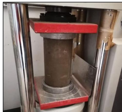
Figura 34: Rotura de las briquetas de concreto
