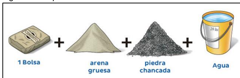
Figura 4: Componentes del concreto
