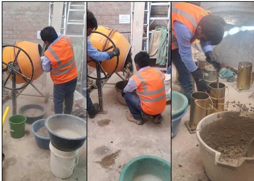
Figura 12: vaciado de concreto en dosificación AG+AGR20%.
