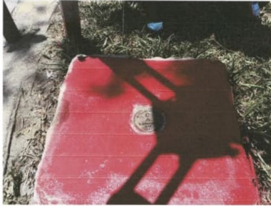
FOTO N° 02: Vista de acercamiento al Punto Geodésico PG-1, señalizado con un punto dentro de un círculo enmarcado en un cuadrado de 30x30cm.
