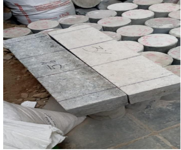
Vigas de concreto para rotura de flexión
