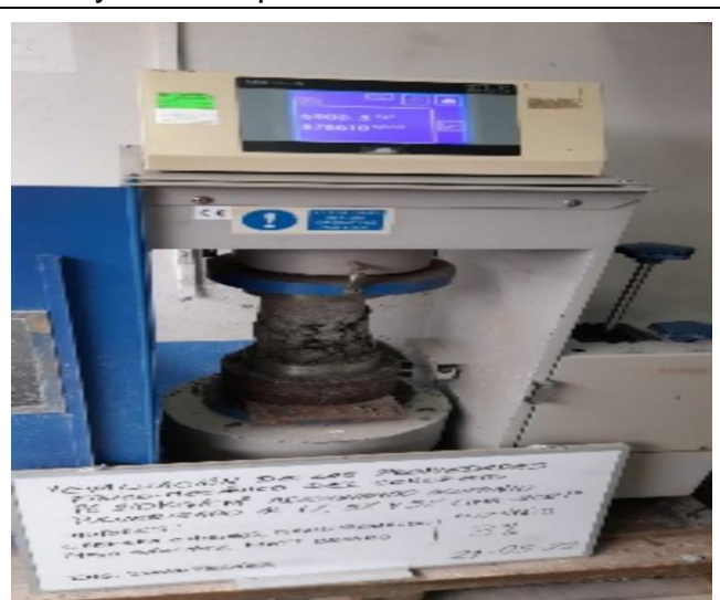
Ensayo de compresión
