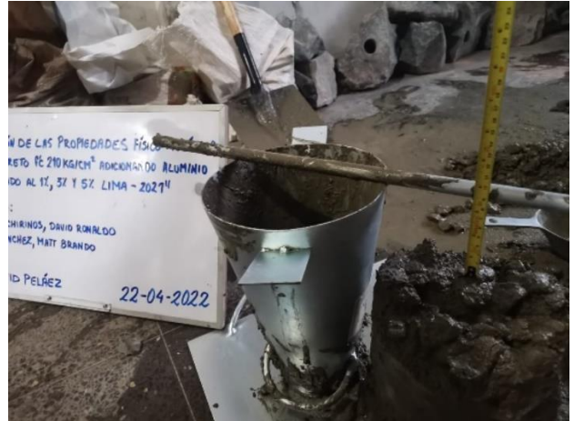
Realización de ensayo de consistencia con el cono de Abrams
