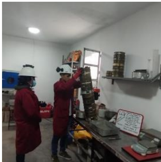
Figura 37. Vibrado de los tamices para la correcta prueba granulométrica.
