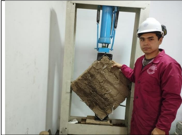
15. Ensayo a compresión en muretes de adobe.
