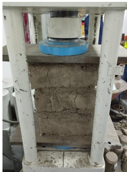
Figura 64. Ensayo de compresión en pilas de adobe.
