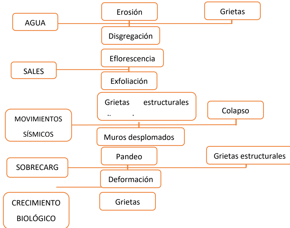
Figura 6. Principales daños en las construcciones de adobe
