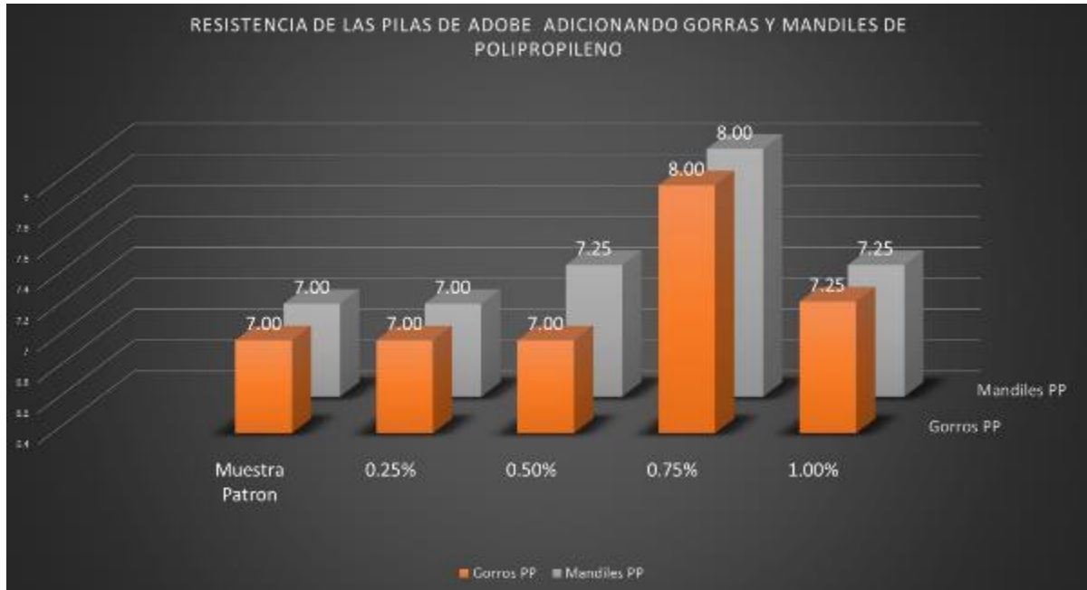
Figura 90. Resistencia a compresión diagonal de muretes según Ochoa
