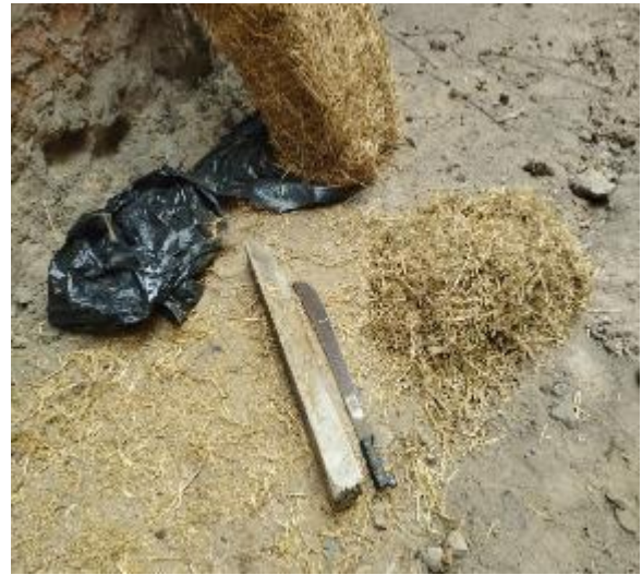
Figura 19. Paja de arroz picada medida para la adición al adobe.
