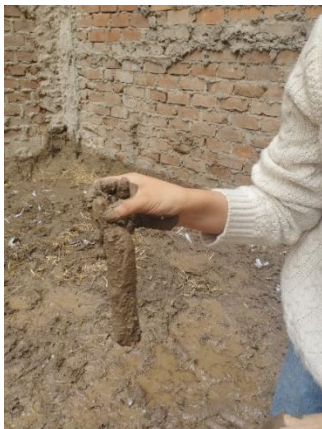
Figura 40. Elaboración de la cinta de barro.
