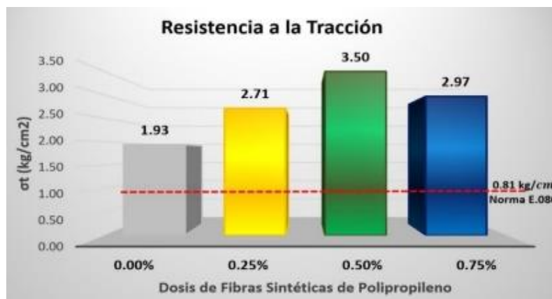
Figura 95. Resistencia a tracción indirecta obtenido por Alfaro
