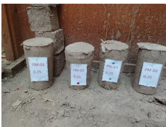
Figura 59. Muestras de probetas de adobe con el 0.25% de mandiles de polipropileno.
