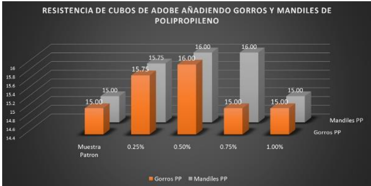
Figura 88. Resistencia a compresión de cubos adicionando gorros y mandiles de polipropileno
