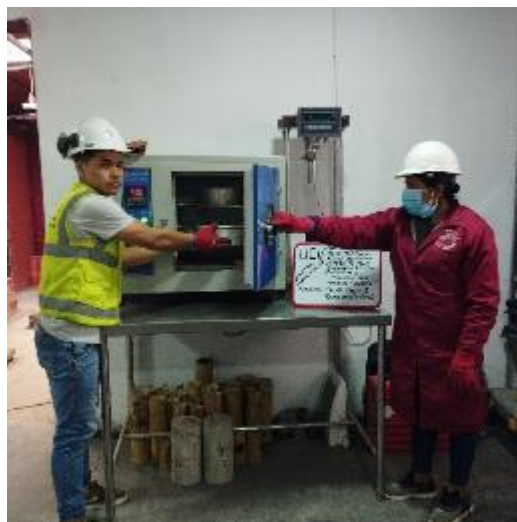
Figura 27. Horno a alta temperatura para registrar el porcentaje de humedad.
