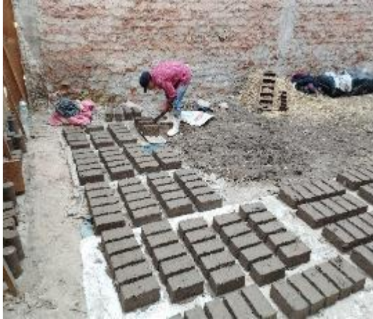
Figura 31. Bloques de adobe en pleno secado al sol.
