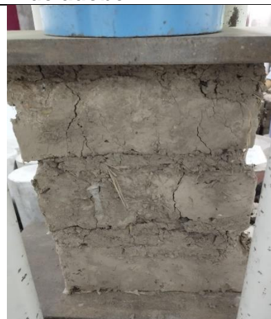
14. Ensayo de compresión a pilas.
