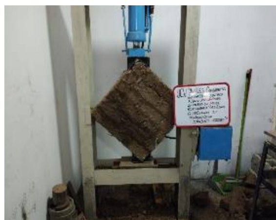
Figura 68. Ensayo a compresión diagonal en muretes de adobe.
