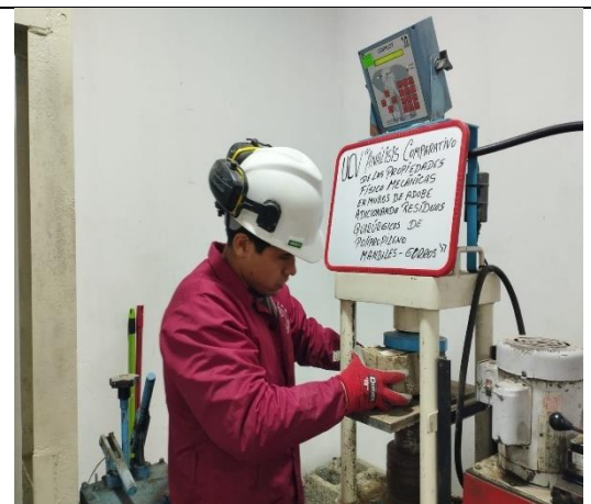
12. Ensayo a flexión de bloques de adobe.
