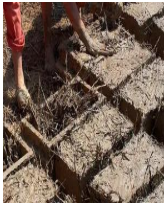
Figura 8. Agregado de paja a la elaboración del adobe
