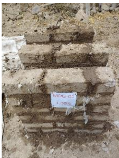
Figura 67. Muestras de muretes de adobe con el 1.00% de gorras de polipropileno
