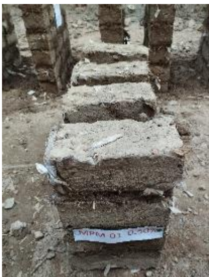
Figura 63. Muestras de pilas de adobe con el 0.50% de mandiles de polipropileno
