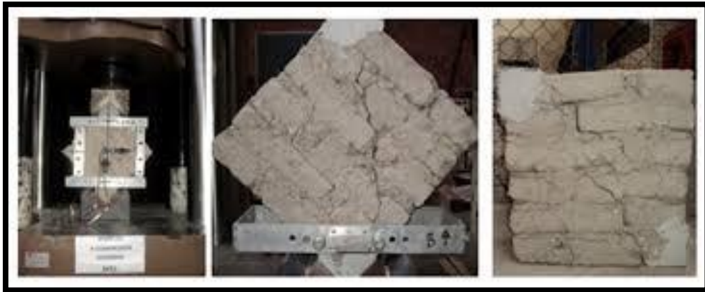
Figura 14. Ensayo de muretes de adobe
