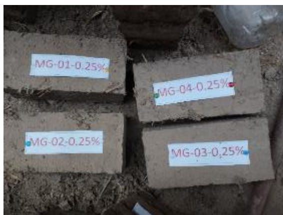
Figura 55. Muestras de adobe adicionando 0.25% gorros de polipropileno para prueba de flexión
