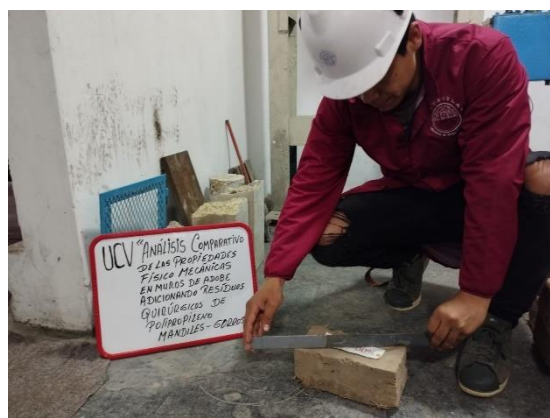
Figura 45. Ensayo de alabeo
