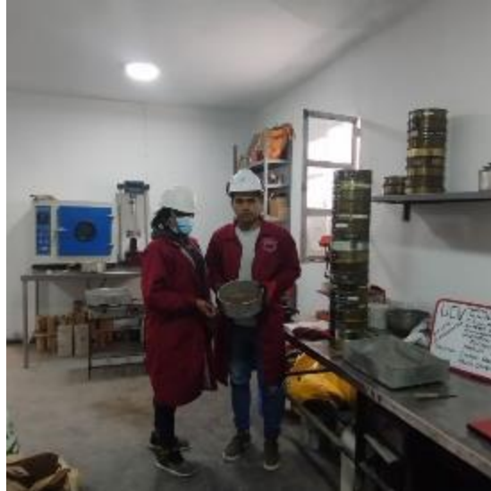
Figura 26. Tamices colocados en orden correcto para un ensayo granulométrico correcto.
