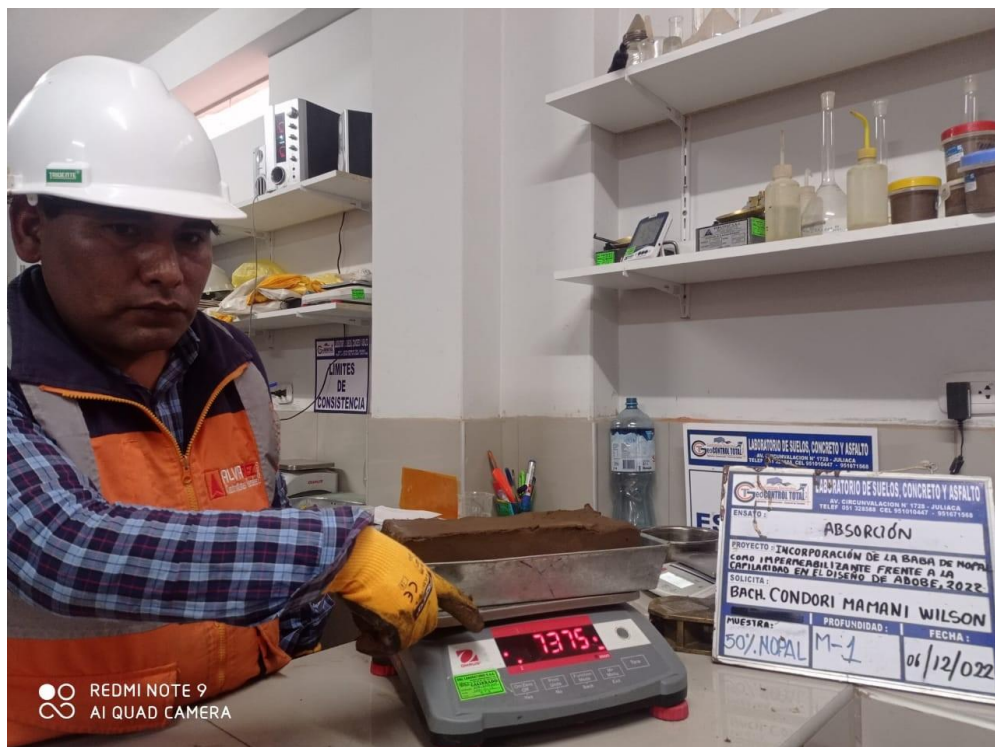
Figura 46. Peso húmedo del adobe sumergido por 24 horas para determinar su absorción.
