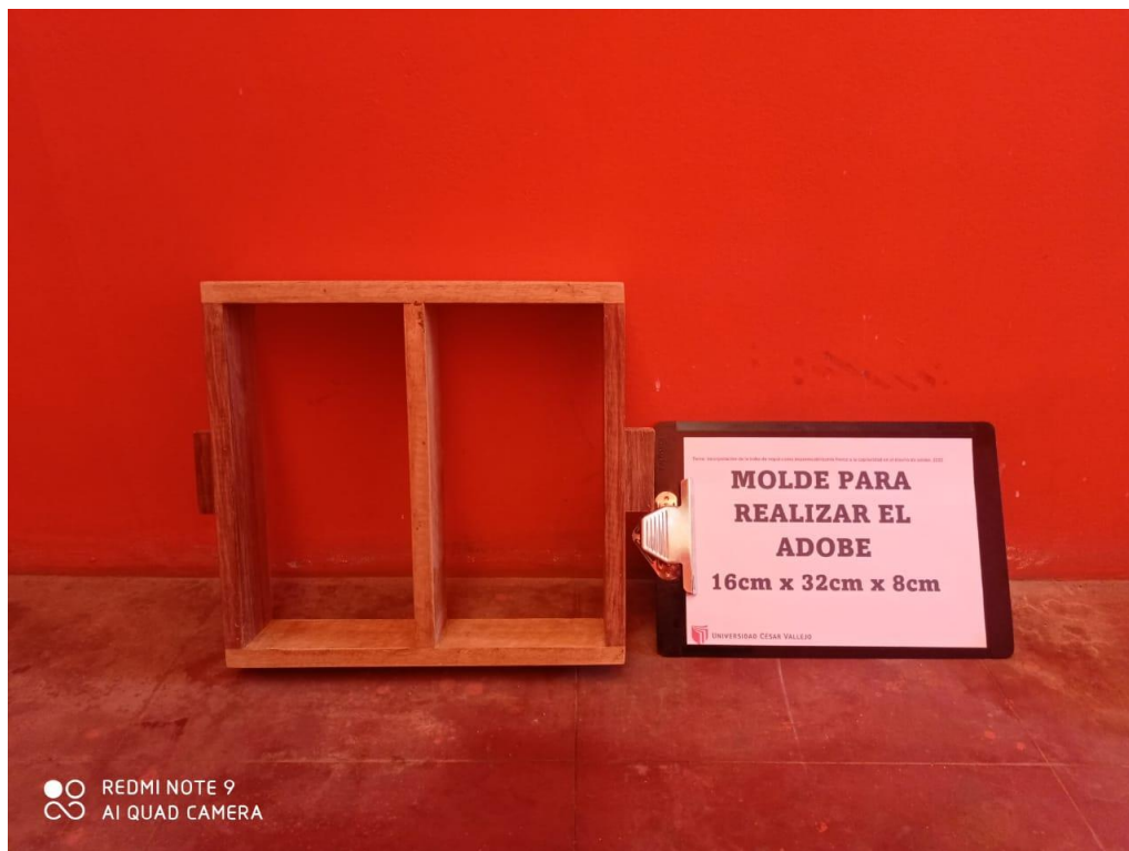
Figura 38. Se tiene el molde para moldear los adobes con dimensión de 32x16x8cm.
