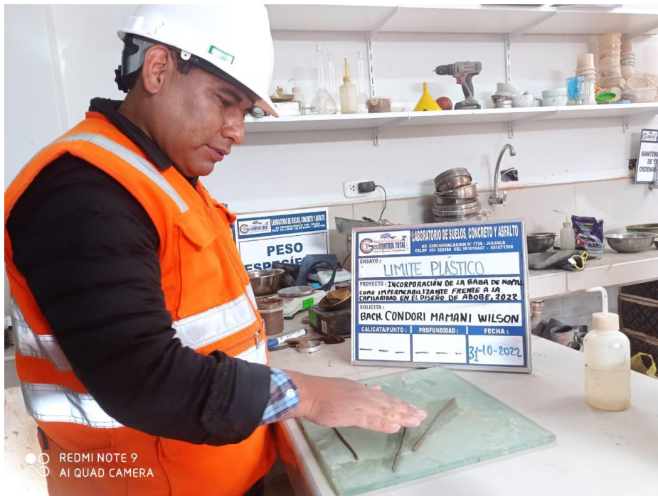
Figura 20. Ensayo de limite plástico para la muestra cantera 01
