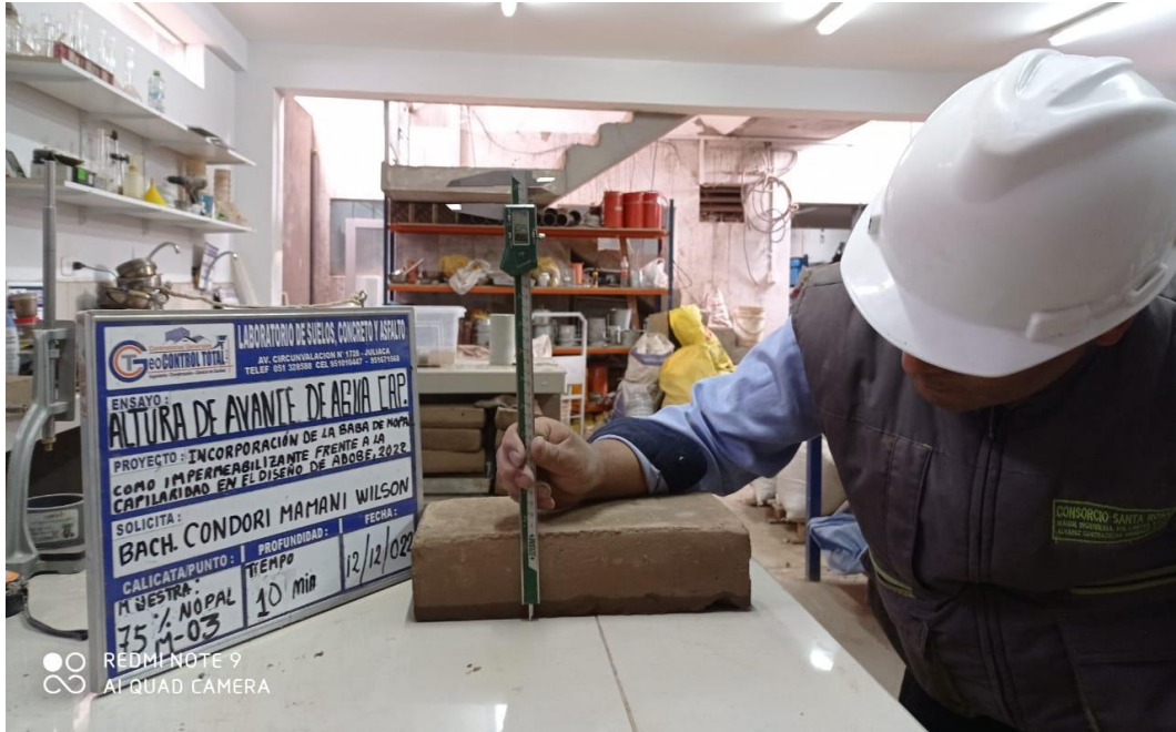
Figura 59. Medición del avance de agua por capilaridad a los 30 min con 75% de baba de nopal.
