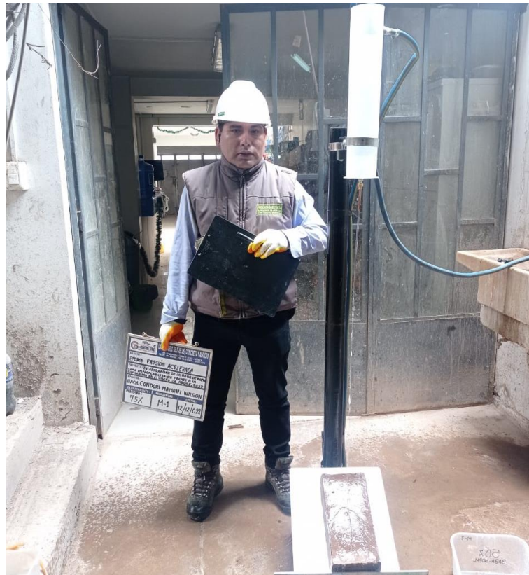
Figura 60. Prueba a la erosión acelerada SWINBURNER.
