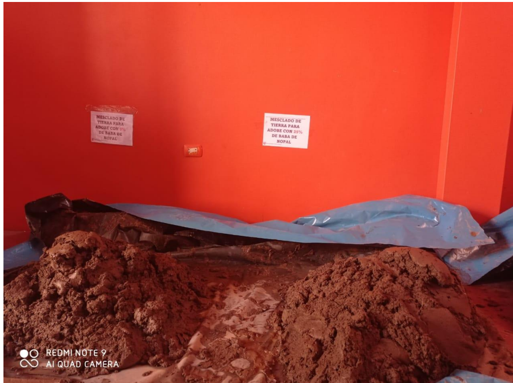
Figura 37. Mezcla de barro para la muestra patrón y baba de nopal de 25%.
