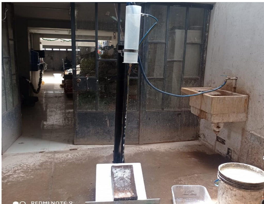
Figura 64. Adobe sometido a la prueba de erosión acelerada SWINBURNER.
