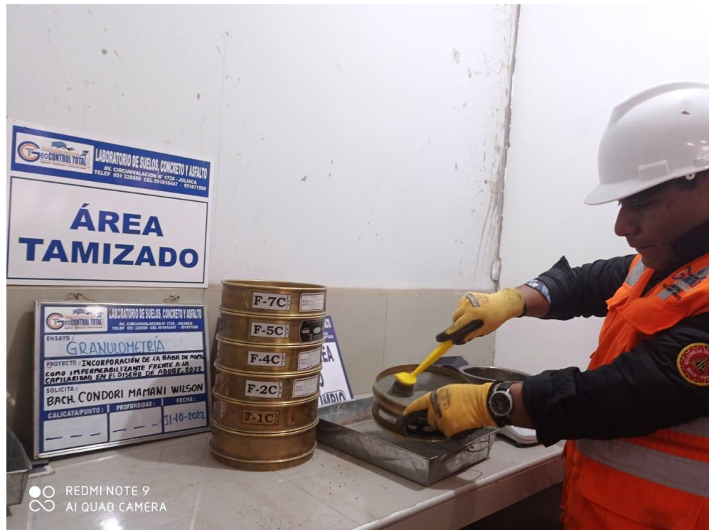
Figura 18. Tamizado de la muestra de suelo para la granulometría
