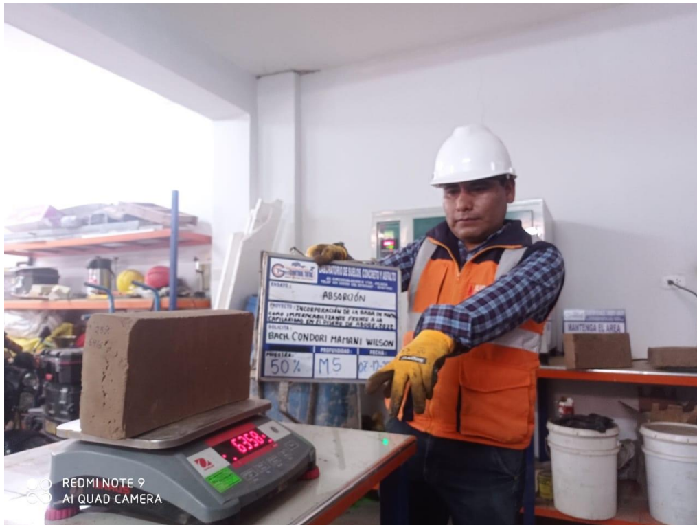
Figura 50. Peso de la muestra de adobe con 25% de baba de nopal seco.
