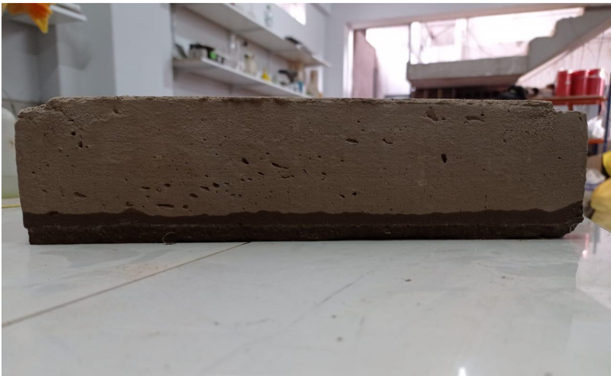
Figura 58. Avance de agua por capilaridad del adobe a los 30 min.
