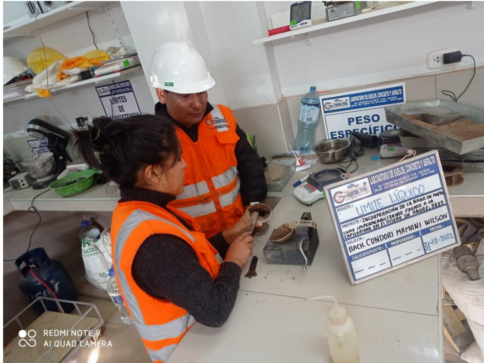
Figura 19. Ensayo de limite liquido de la muestra cantera 01
