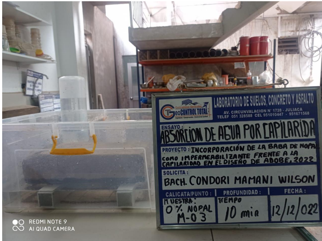
Figura 55. Absorción de agua por capilaridad en muestra de adobe patrón.
