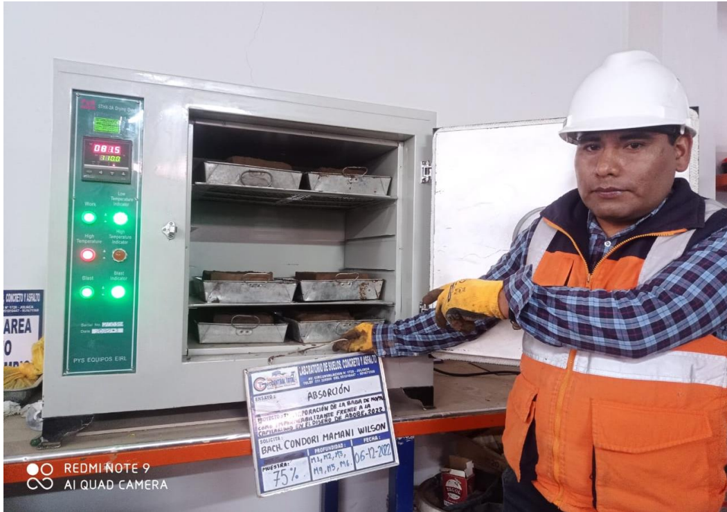
Figura 49. Secado de muestras saturadas de adobes con 75% de baba de nopal.
