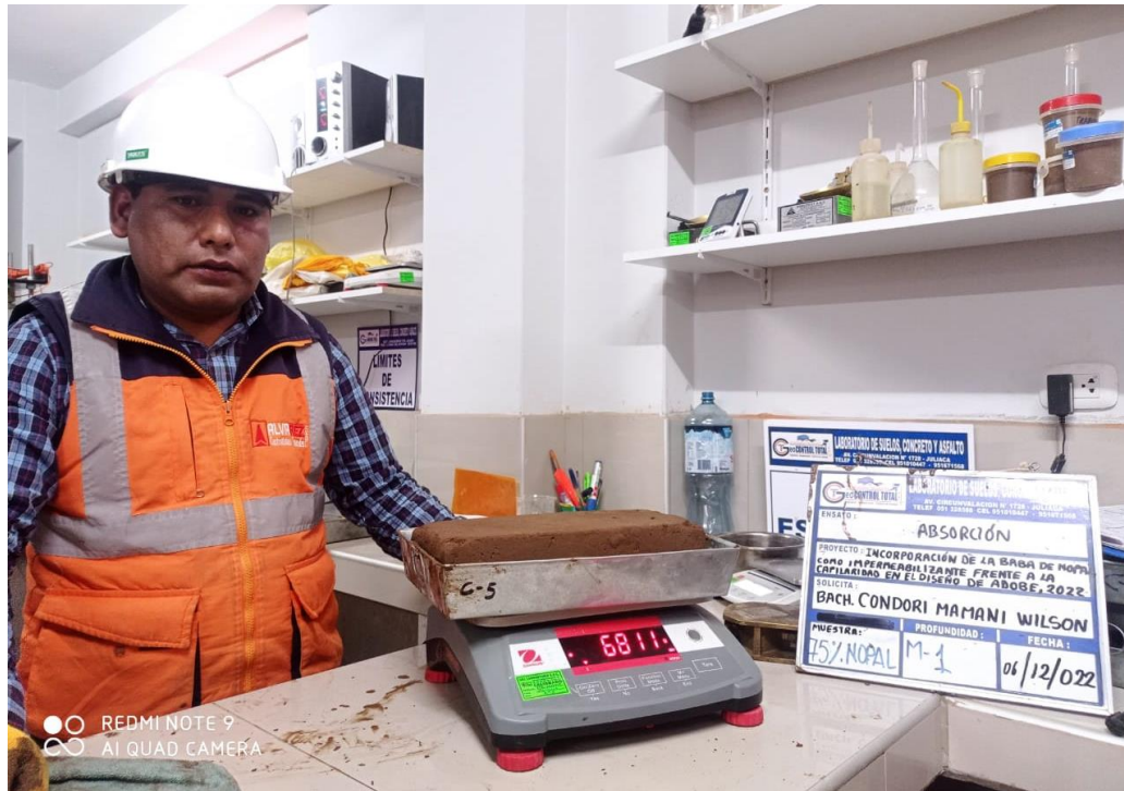
Figura 47. Pesado de muestra saturada por 24 para la obtención de la absorción.
