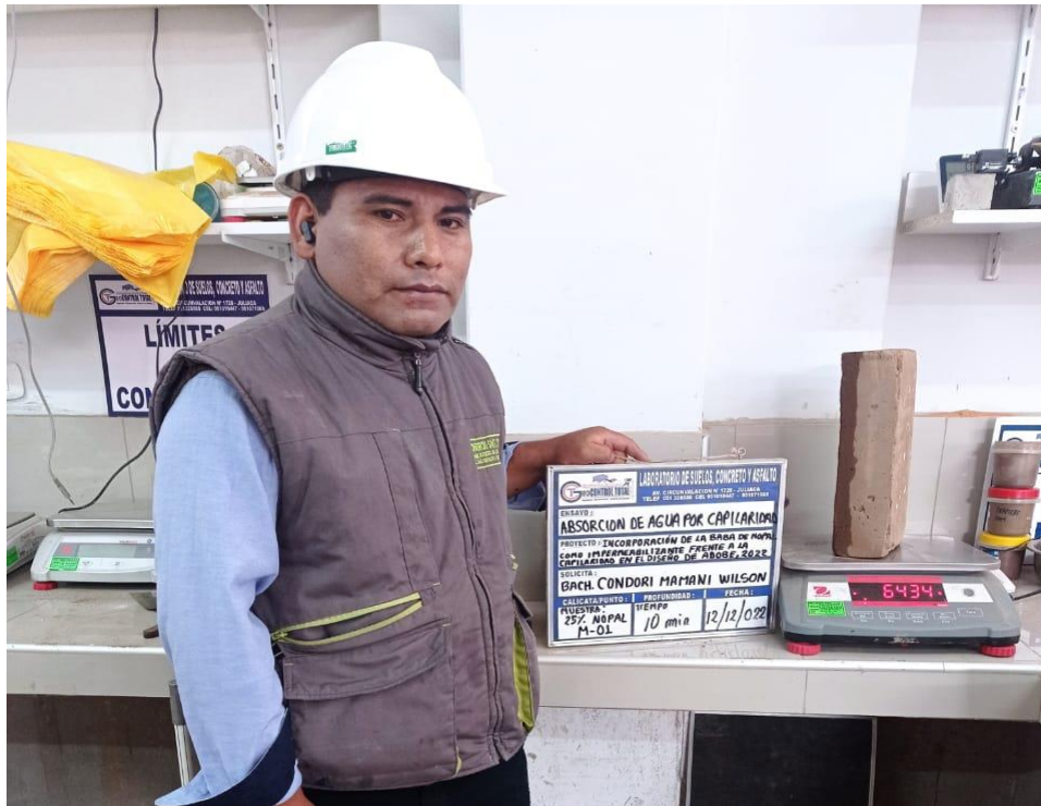
Figura 53. Peso de la muestra sumergida por 10 min para obtener la absorción de agua por capilaridad.
