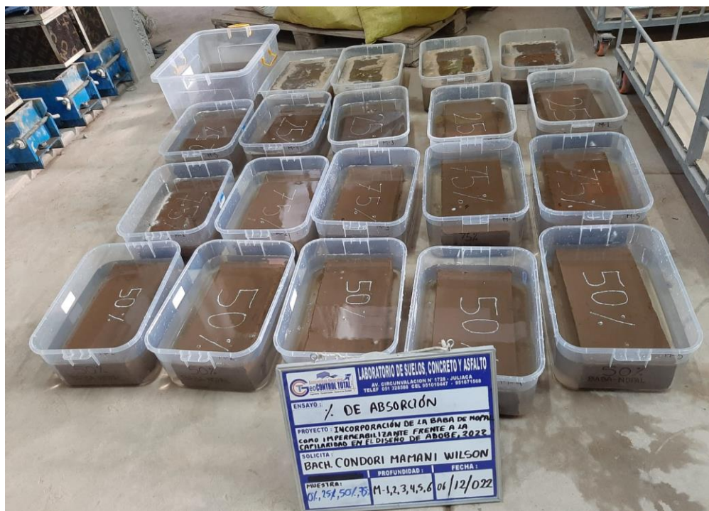
Figura 44. Se aprecia la sumersión en agua las muestras para la prueba de absorción.
