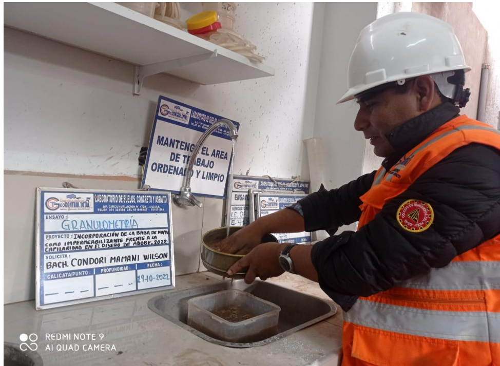
Figura 17. Proceso de lavado de la muestra para la determinación de la granulometría
