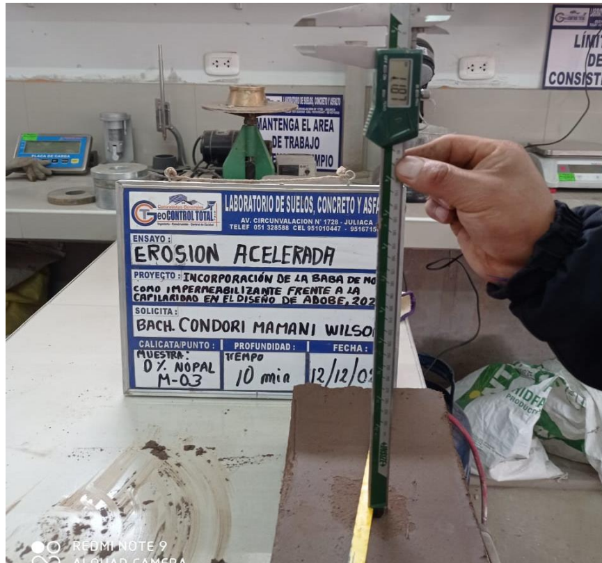
Figura 61. Medición de la oquedad por la erosión acelerada.
