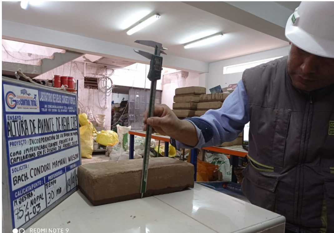
Figura 57. Medición de avance de agua por capilaridad a los 30 min.
