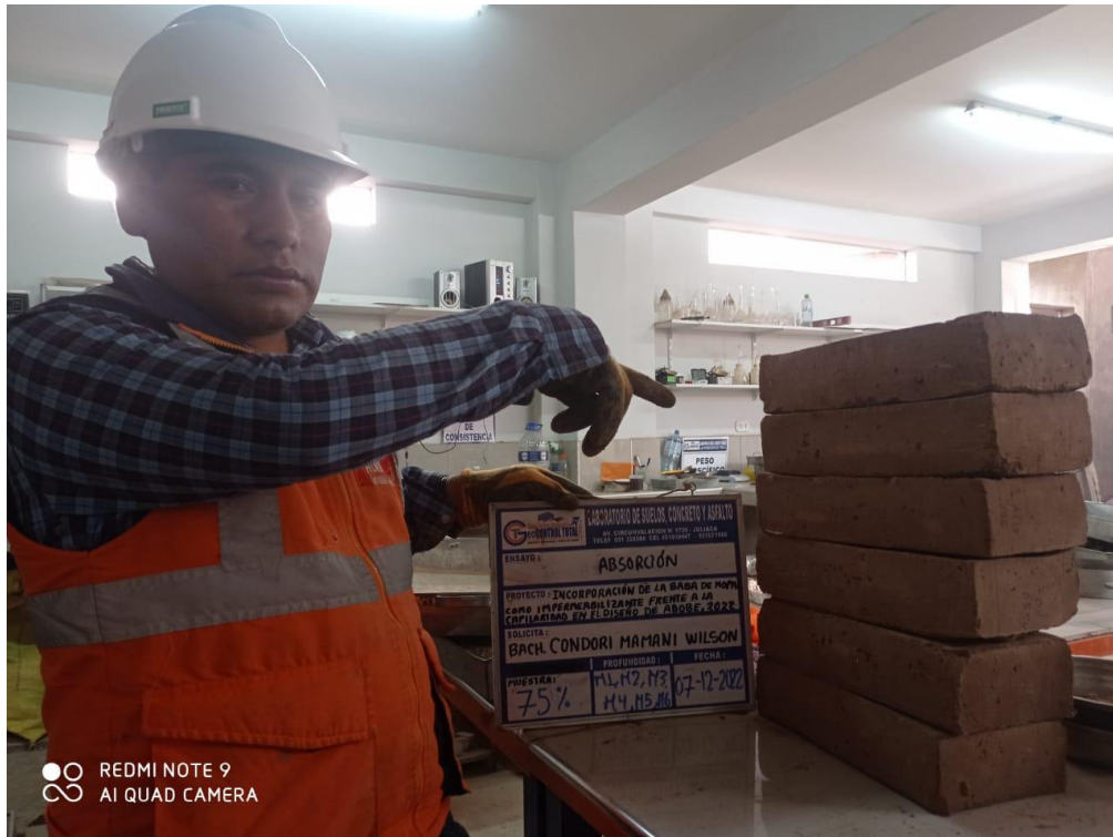
Figura 51. Muestras de adobes con 75% de baba de nopal ensayadas para la absorción.
