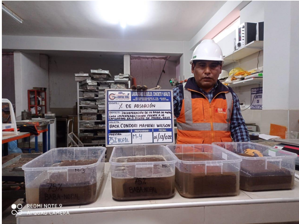
Figura 45. Muestras sumergidas por 24 horas adobe con baba de nopal de 75%.
