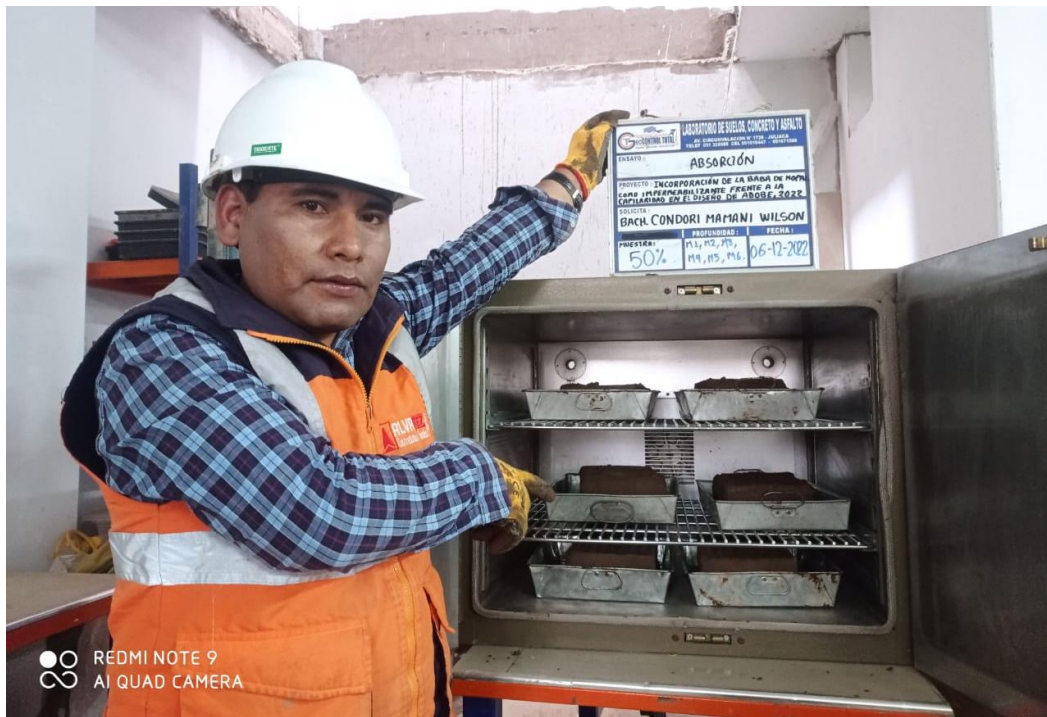
Figura 48. Colocado de las muestras al horno para obtener el peso seco y determinar el % de absorción.
