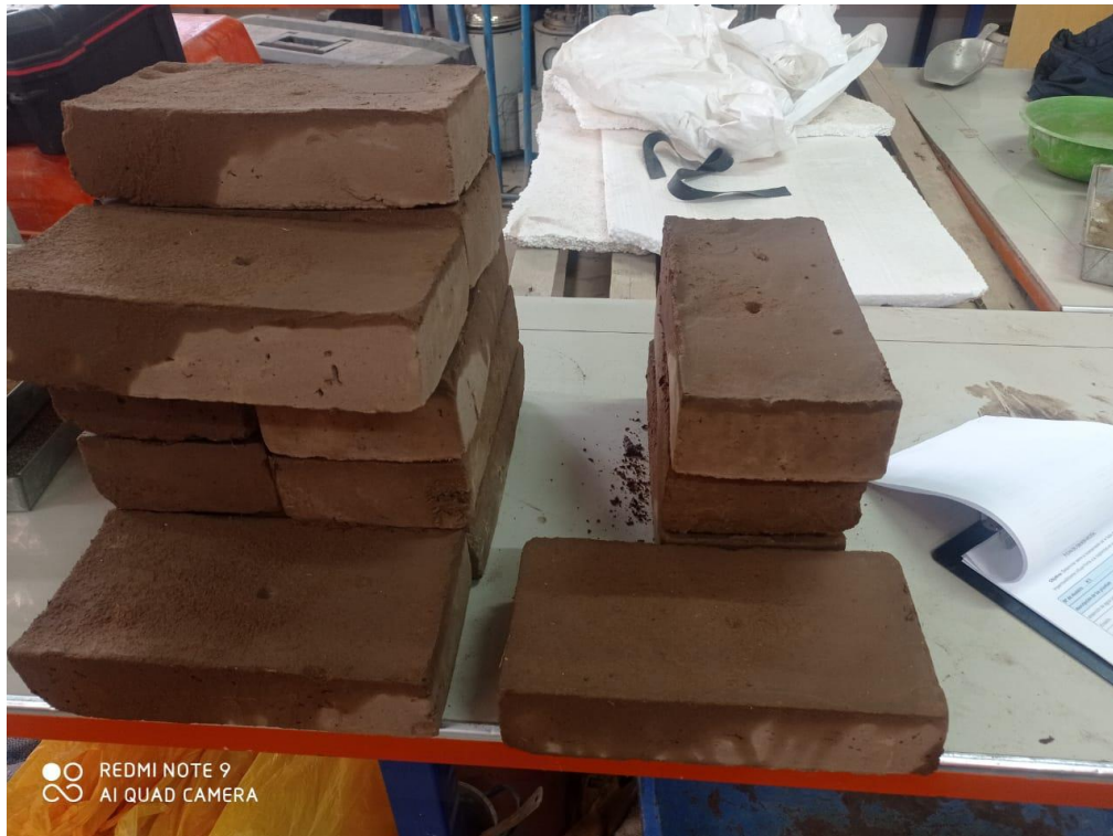
Figura 63. Muestras de adobes ensayadas para la erosión acelerada SWINBURNER.
