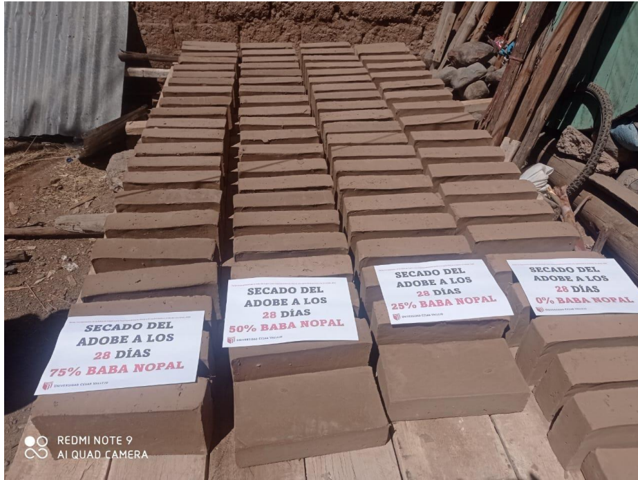
Figura 41. Se puede apreciar los adobes secándose en el sol a temperatura ambiente.
