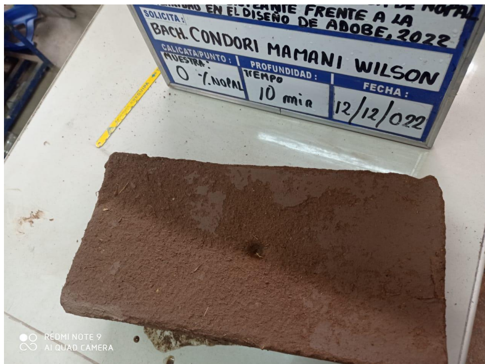
Figura 62. Aquedad que sufre la muestra de adobe por la prueba de erosión acelerada.
