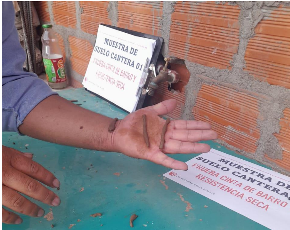
Figura 13. Prueba de cinta de barro para determinar el contenido de arcilla cantera 02
