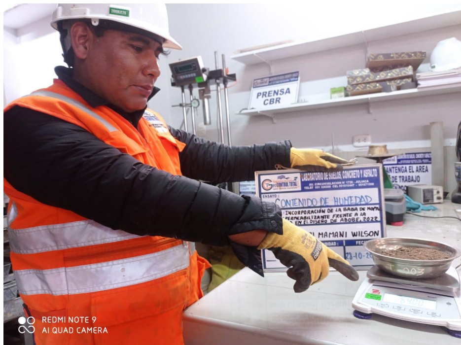
Figura 16. Determinación de contenido de humedad del suelo
