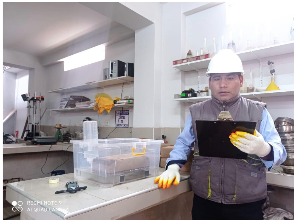
Figura 52. Prueba de absorción de agua por capilaridad (Cb)
