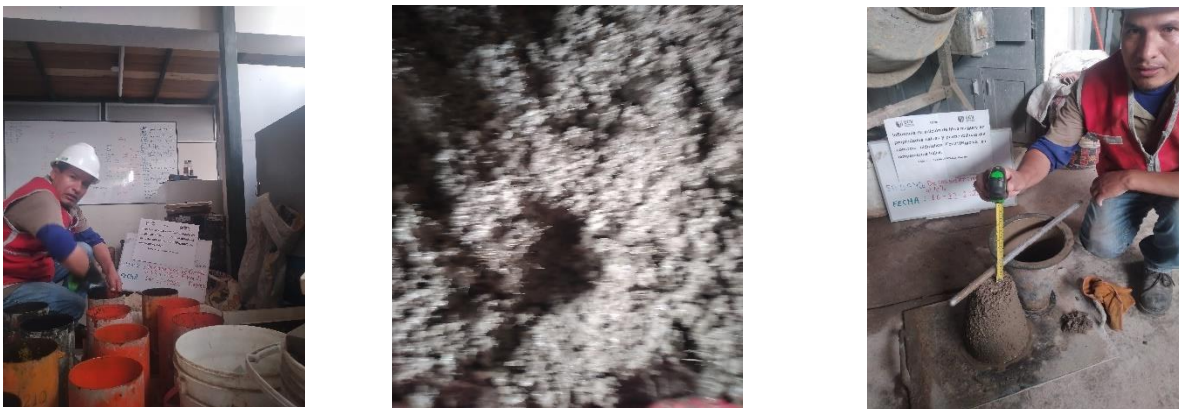
FOTO 15: Ensayo del concreto hidráulico con AFM al 10% al patrón
