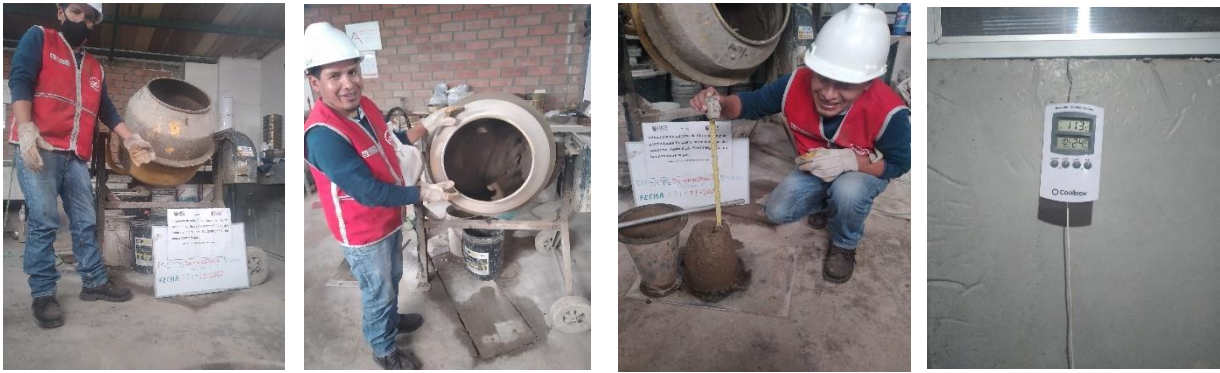
FOTO 13: Preparacion del concreto hidraulico diseño patrón
