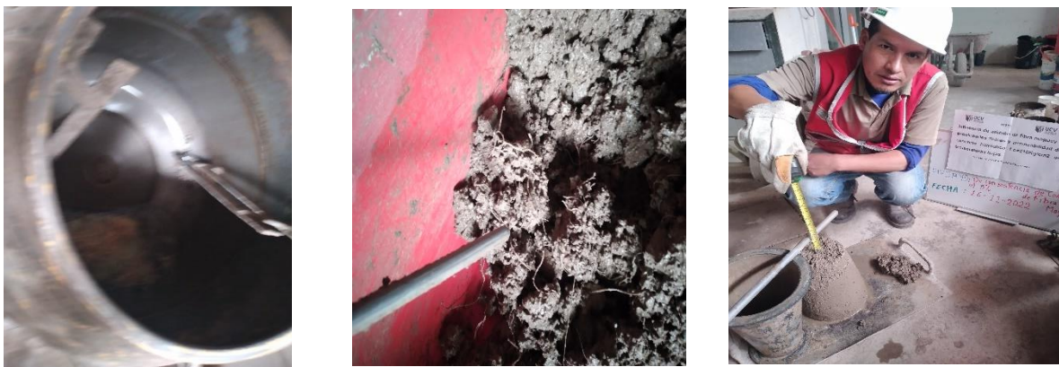
FOTO 14: Ensayo del concreto hidráulico con AFM al 5% al patrón
