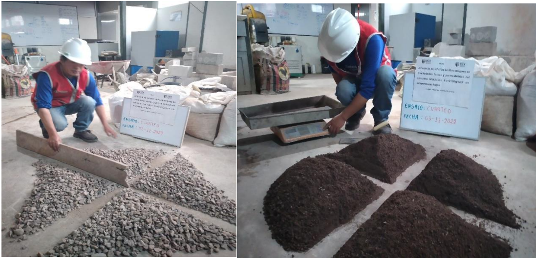
FOTO 05: Ensayo de cuarteo de los agregados grueso y fino. Fuente: Autor
