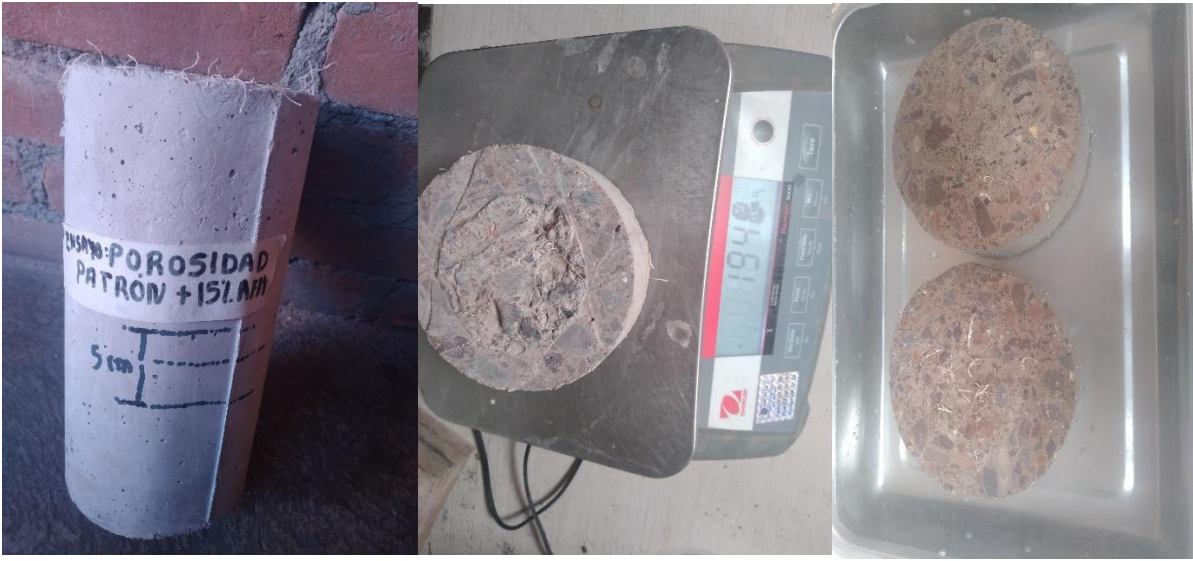
FOTO 18: Ensayo de la porosidad
