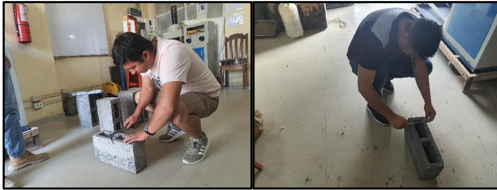
Figura 5: Mediciones del bloque de concreto 02 huecos (altura, ancho y longitud)
