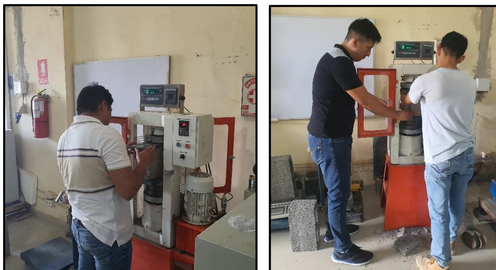
Figura 6: Ensayos de resistencia a la compresión de bloques de concreto 02 huecos
