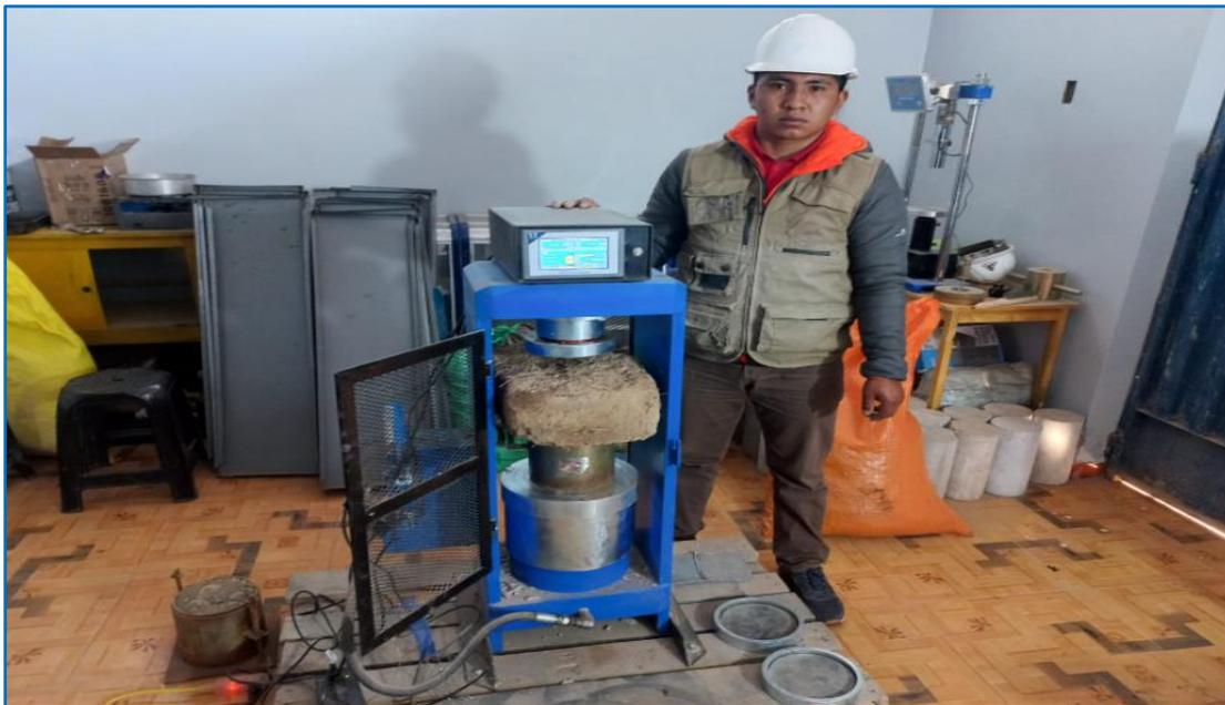
**FOTO N° 16:** Ensayo de resistencia a compresión.
