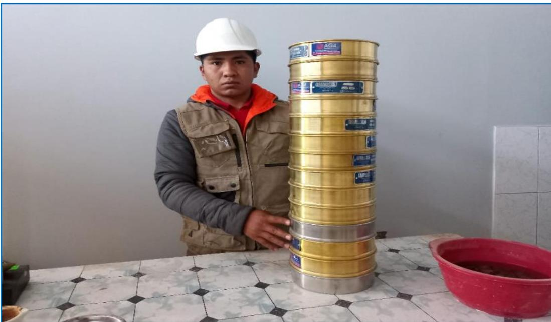
**FOTO N° 10:** Realización de ensayo granulométrico.
