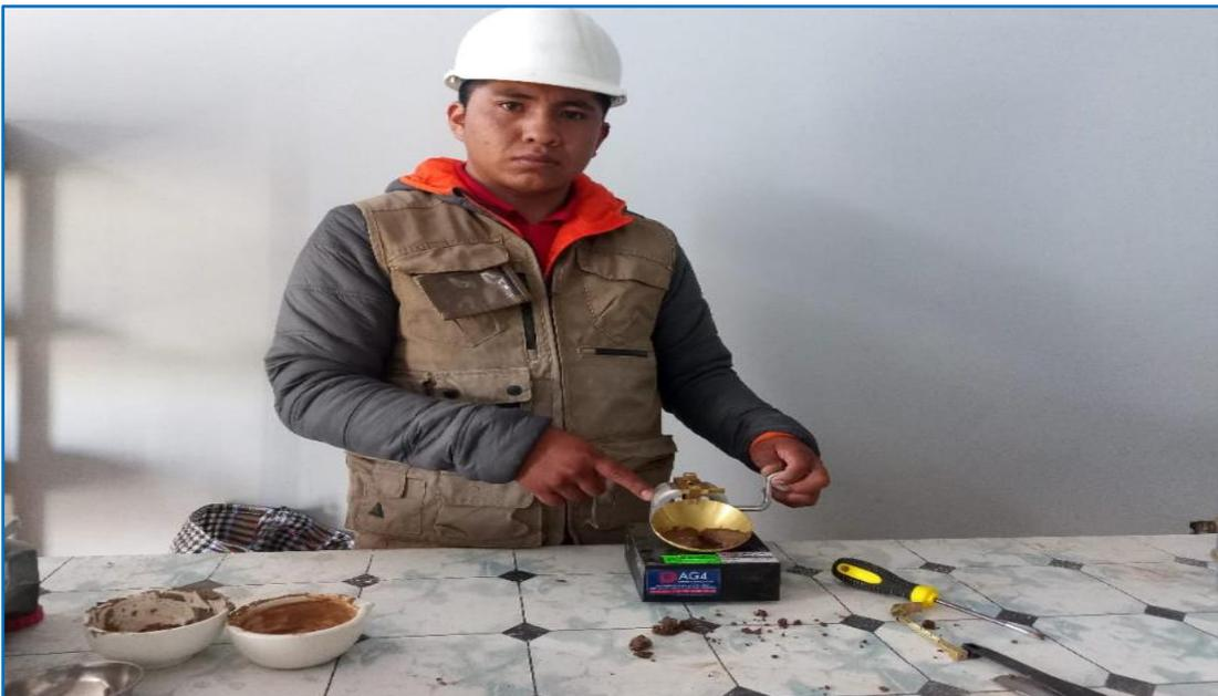
**FOTO Nº 11:** Ensayo de la copa de Casagrande.
