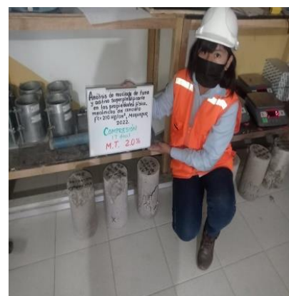
Figura 41. Rotura de probetas de concreto
