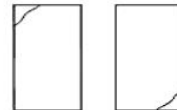
TIPO 5 Fractura en los lados en las partes superior o inferior (ocurre comúnmente con cabezales no adheridos).
