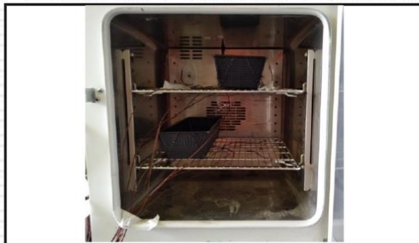
Foto de distribución de los sensores de temperatura y carga durante la calibración
