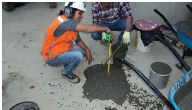
Figura 7. Ensayo de asentamiento en aditivo superplastificante
