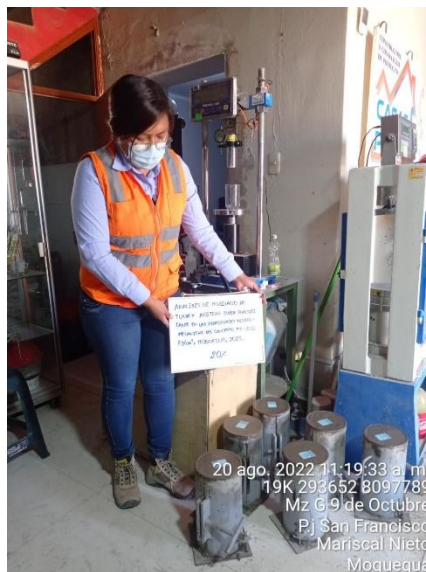
Figura 27. Elaboración de probetas con mucílago de tuna
