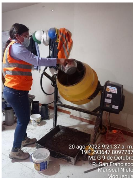
Figura 25. Elaboración de concreto f'c=210 kg/cm 2 con mucílago de tuna
