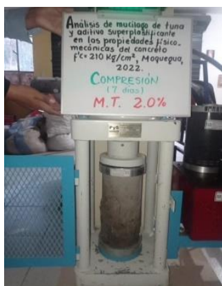
Figura 40. Ensayo a la compresión
