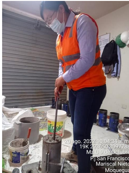
Figura 26. Compactado de probetas con mucílago de tuna
