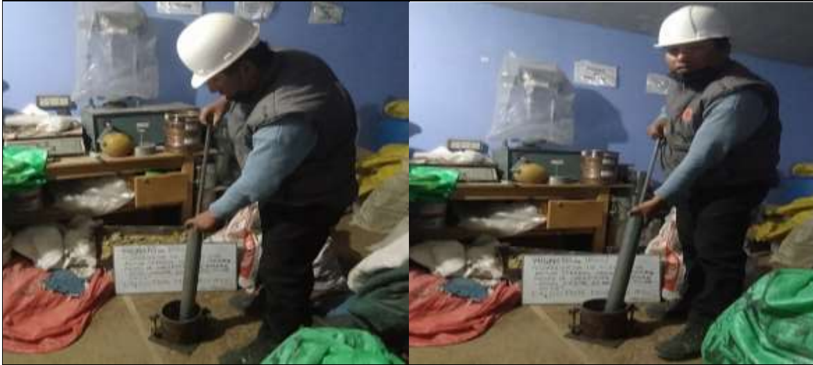
Foto 12 compactación del proctor
