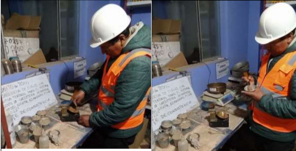
Foto 7 Ensayo en del límite liquido con equipo casa grande
