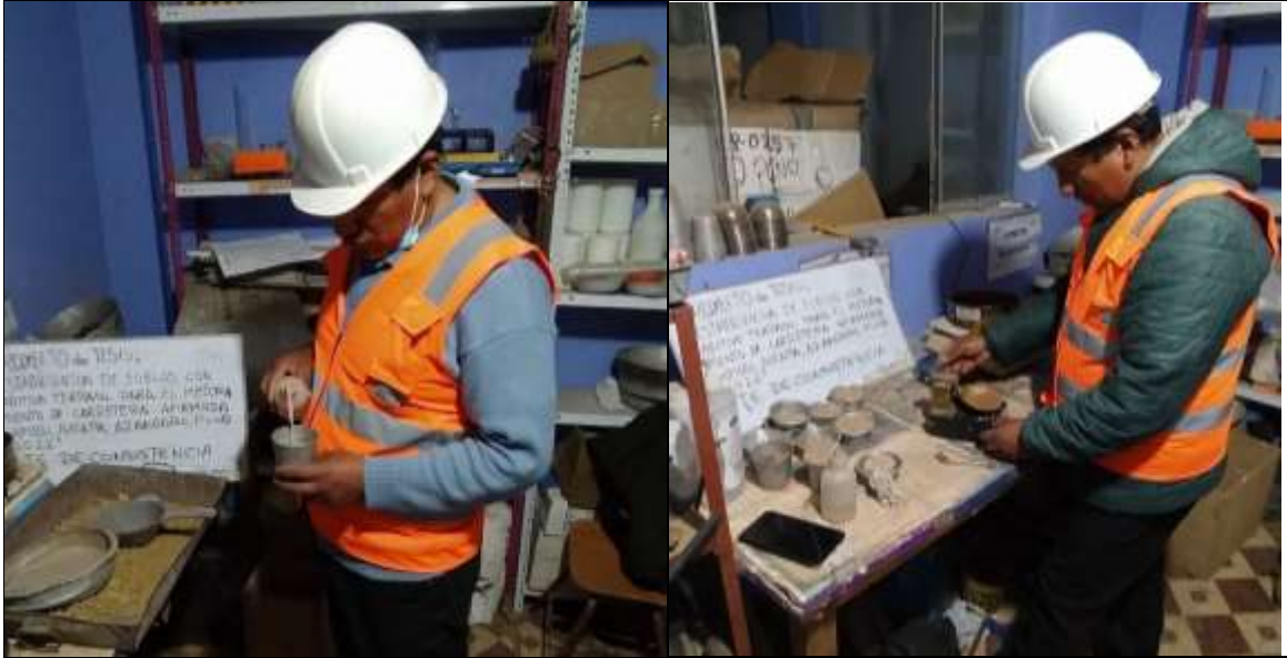
Foto 6 adición de agua para el cálculo del límite de líquido con equipo casa grande
