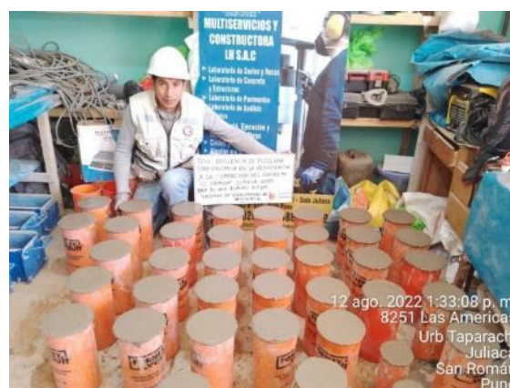
Figura 19:elaboracion de probetas cilíndricas
