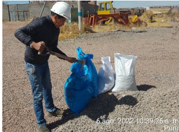
Fotografía 1; extracción de piedra chancada como agregado grueso
