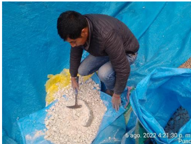
Fotografía 2: chancado de puzolana para su posterior molienda
