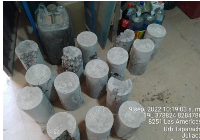
Fotografía 24: tipo de fallas que se suscitaron a los 28 días.
