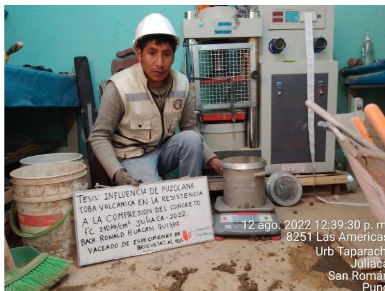
Figura 24: ensayo de peso unitario del concreto
