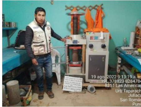
Figura 27:rotura de briquetas a los 7 días con incorporación de puzolana toba volcánica en 0%,5%,10% y 15%.
