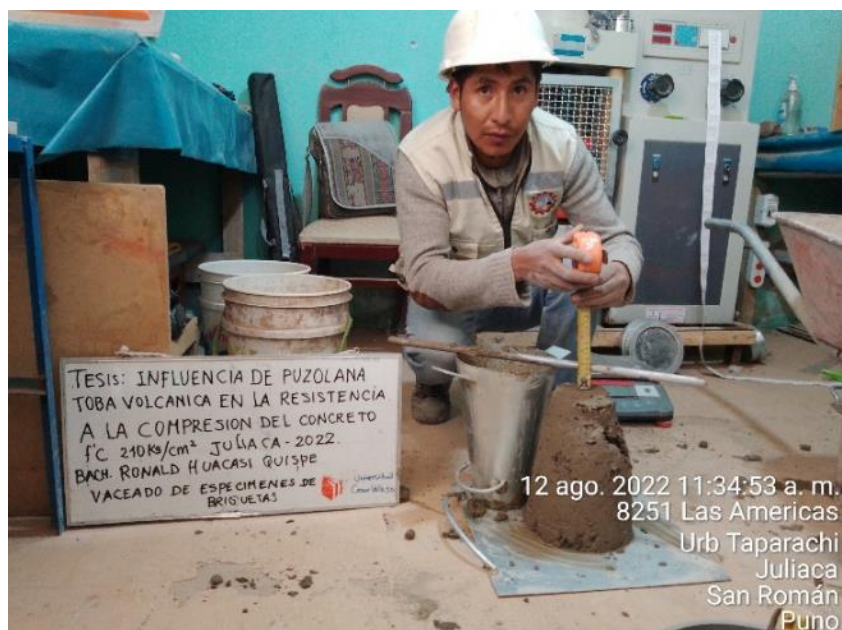
Figura 22: Medicion del asentamiento del concreto fuente: fotografía propia
