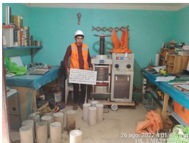
Figura 29: rotura de briquetas a los 14 días con incorporación de puzolana toba volcánica en 0%, 5%, 10% y 15%.
