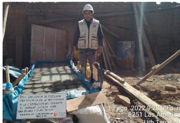
Fotografía 17: curado de especímenes
