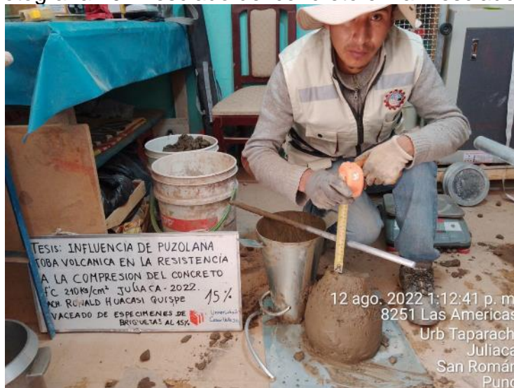
Fotografía 11: medición de asentamiento con adición de 5%
