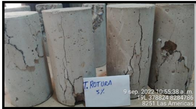
Figura 34: tipo de falla que se dieron a los 28 días Tipos de fallas que se presentaron en el concreto patrón sin adición de puzolana toba volcánica son de tipo 5 y 3
