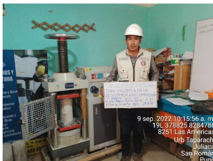
Figura 31: rotura de briquetas a los 28 días con incorporación de puzolana toba volcánica en 0%, 5%, 10% y 15%.
