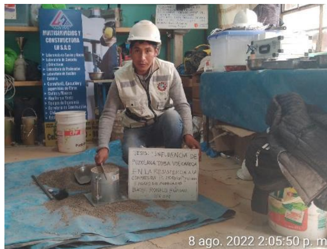
Fotografía 3: cálculo de peso unitario de los agregados
