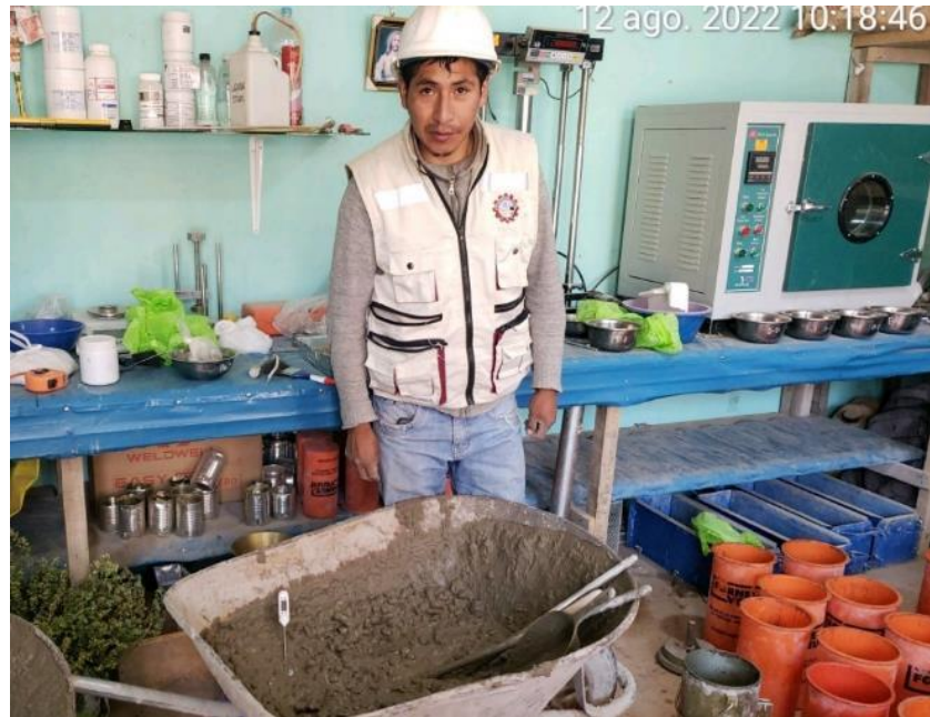
Fotografía 13: ensayo de medición de temperatura del concreto
