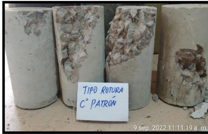
Figura 34: tipo de falla que se dieron a los 28 días Tipos de fallas que se presentaron en el concreto patrón sin adición de puzolana toba volcánica son de tipo 5 y 3
