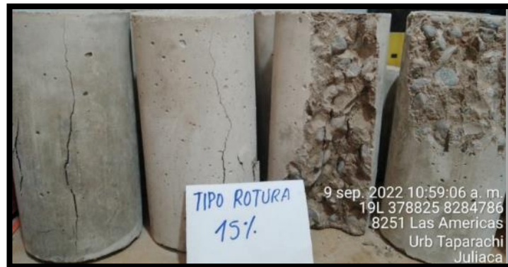
Figura 37: tipo de falla en remplazo de 15%
