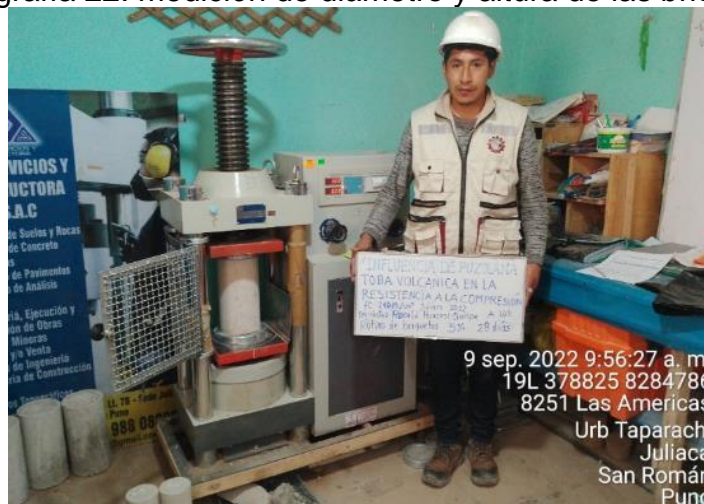
Fotografía 23: Rotura de briquetas resistencia ala compresión a los 28 días
