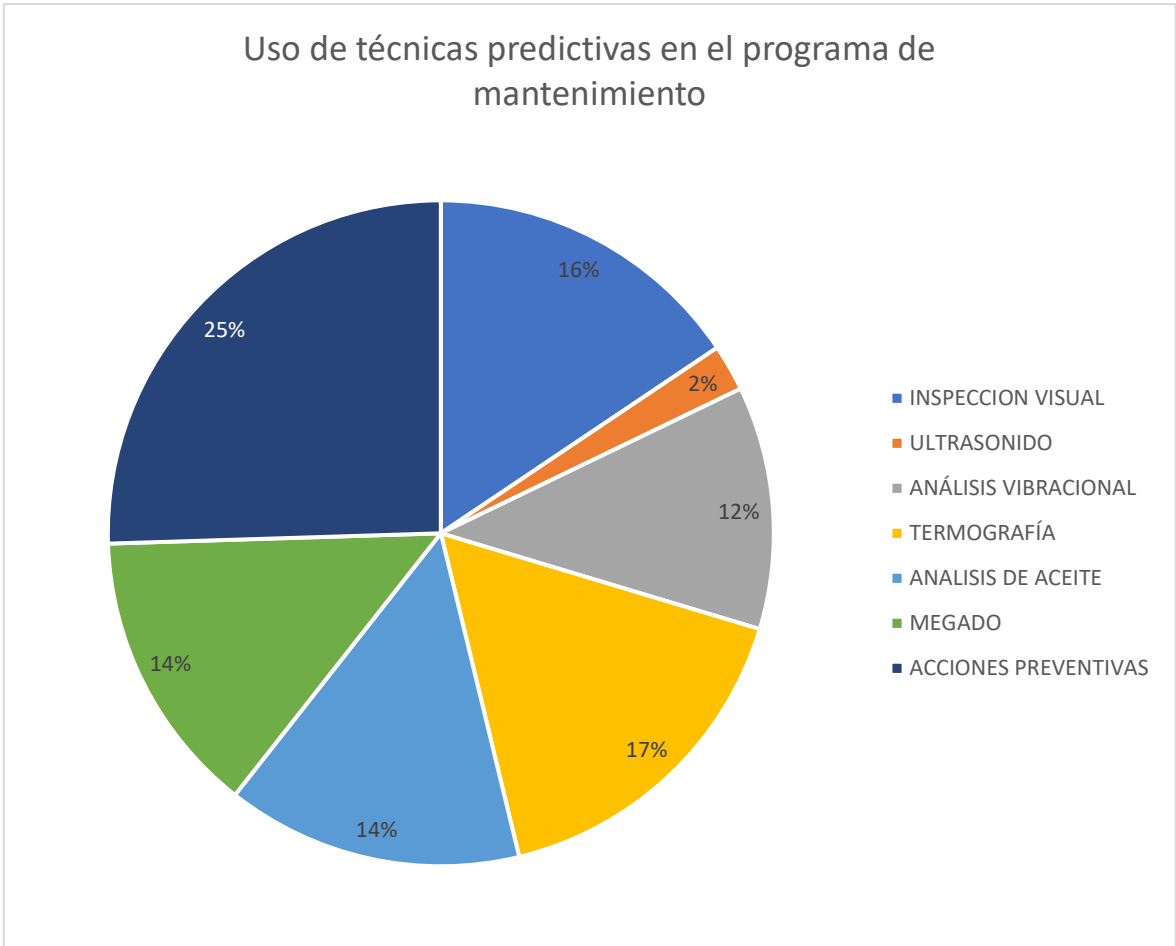
Figura 12. Uso de técnicas predictivas en el programa de mantenimiento en proceso Rendering.
