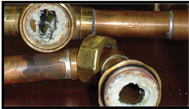
Imagen 3: "Incrustación de minerales en tuberías debido a la alta concentración de dureza de agua"
