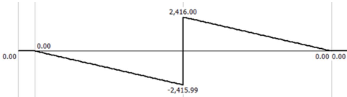
Figura 9: Diagrama de momentos flectores, plano yz.
