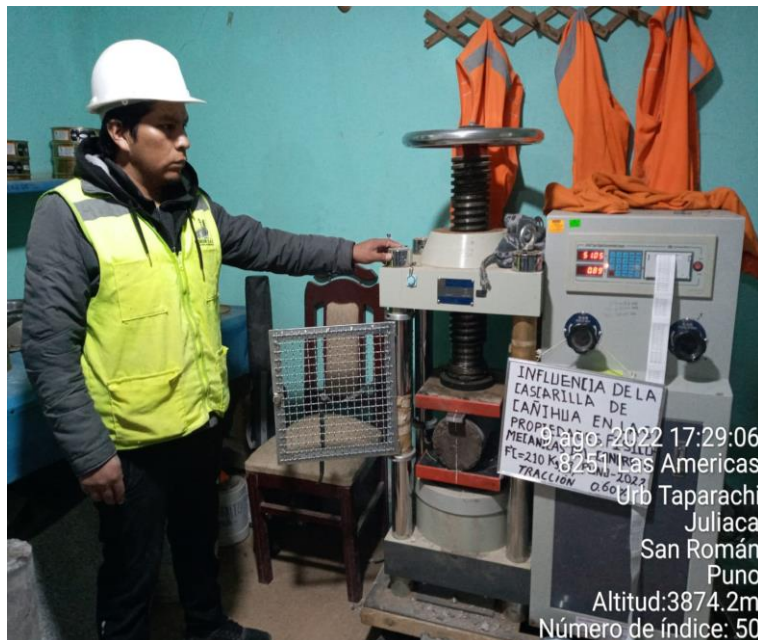
Figura 28: Rotura a la tracción
