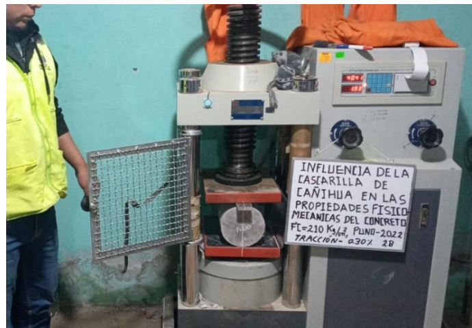
Fotografía N°47: resistencia a la tracción a los 28 días –muestra con adición al 0.30%
