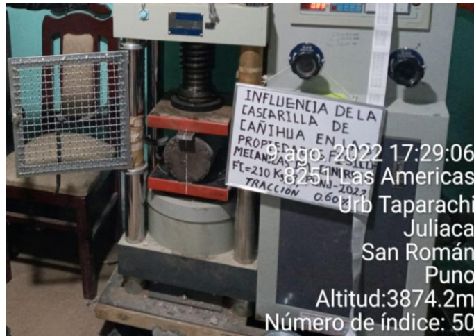
Fotografía N°28: resistencia a la tracción a los 7 días –muestra con adición al 0.60%
