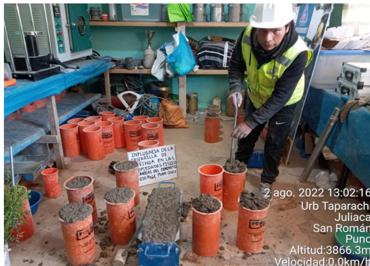
Figura 24: Elaboración de briquetas, varillado de 25 golpes
