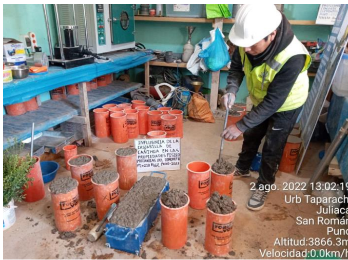
Fotografía N°17: vaciado y varillado de briquetas y viga
