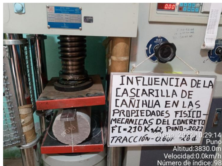
Fotografía N°48: resistencia a la tracción a los 28 días –muestra con adición al 0.60%
