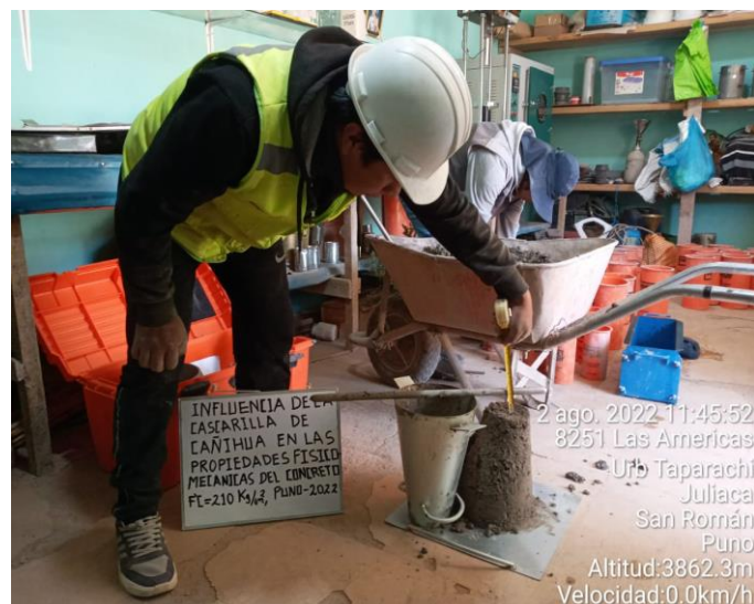
Fotografía N°15: medición del slump
