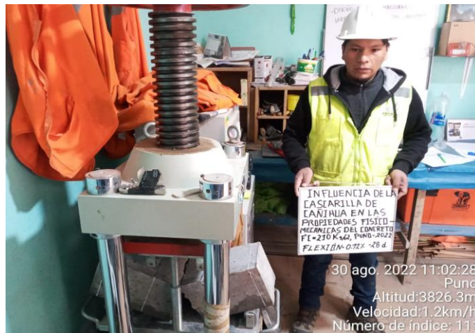
Fotografía N°50: resistencia a la flexión a los 28 días –muestra con adición al 0.12%
