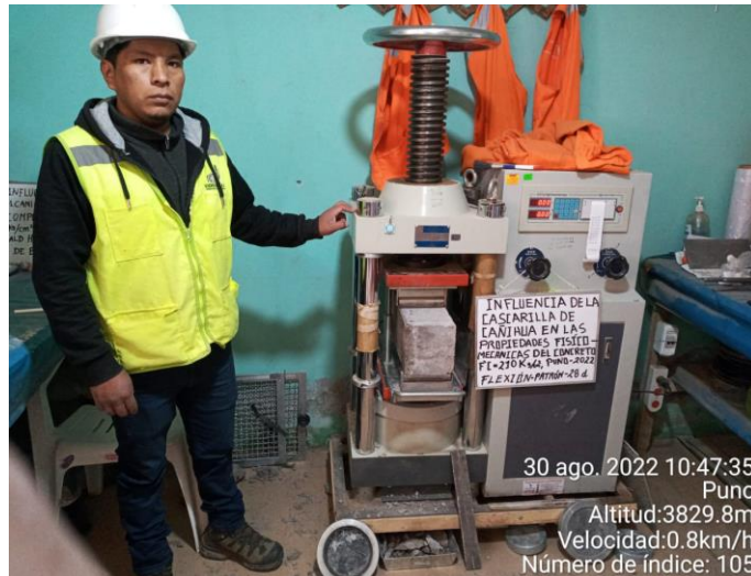
Fotografía N°49: resistencia a la flexión a los 28 días –muestra patrón
