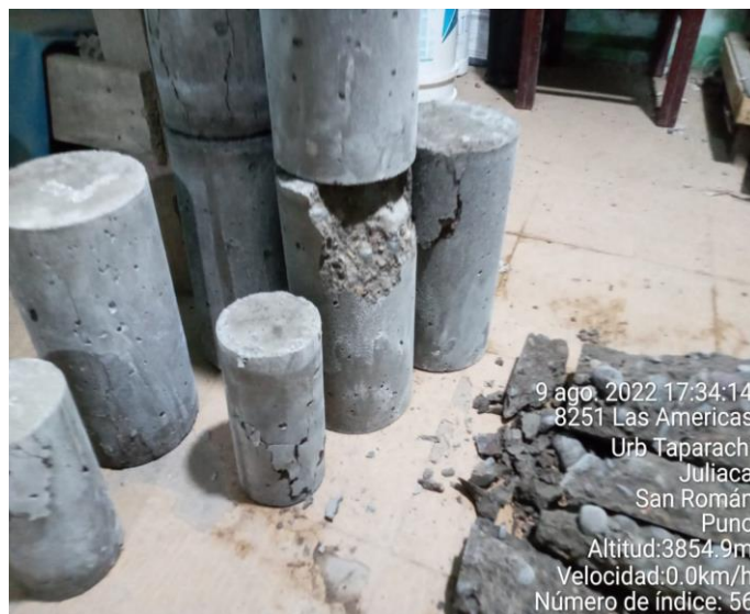
Fotografía N°30: muestras sometidas a esfuerzos a la compresión a los 7 días
