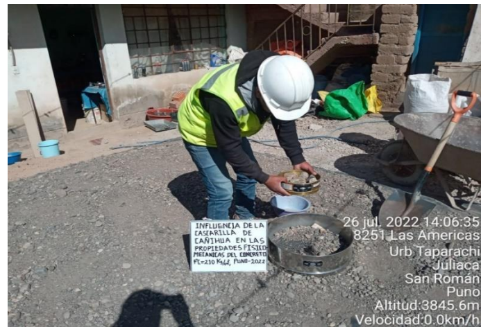
Fotografía N°2: separación del AF y AG
