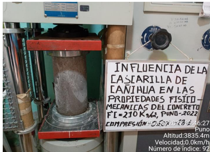
Fotografía N°44: resistencia a la compresión a los 28 días –muestra con adición al 0.60%
