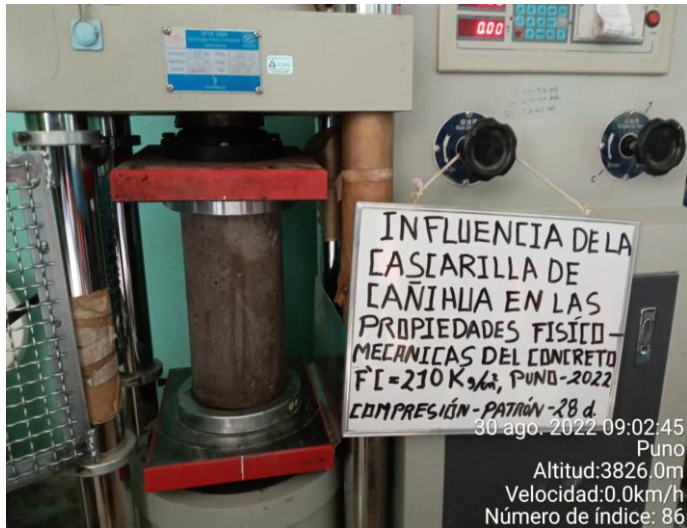
Fotografía N°41: resistencia a la compresión a los 28 días –muestra patrón
