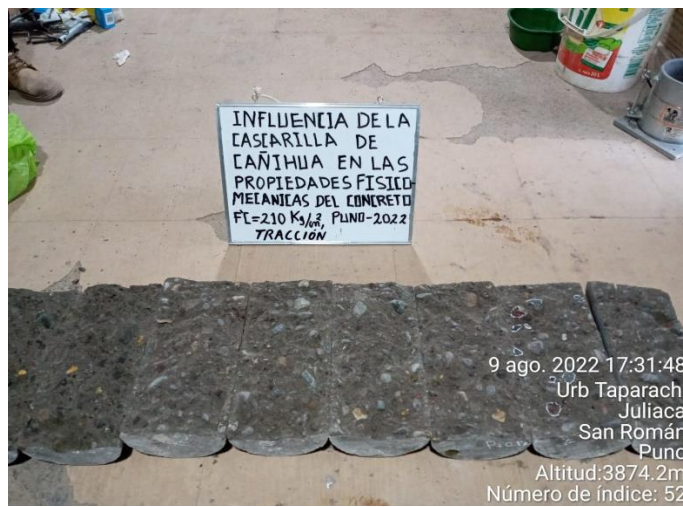
Fotografía N°29: muestras sometidas a esfuerzos a la tracción a los 7 días
