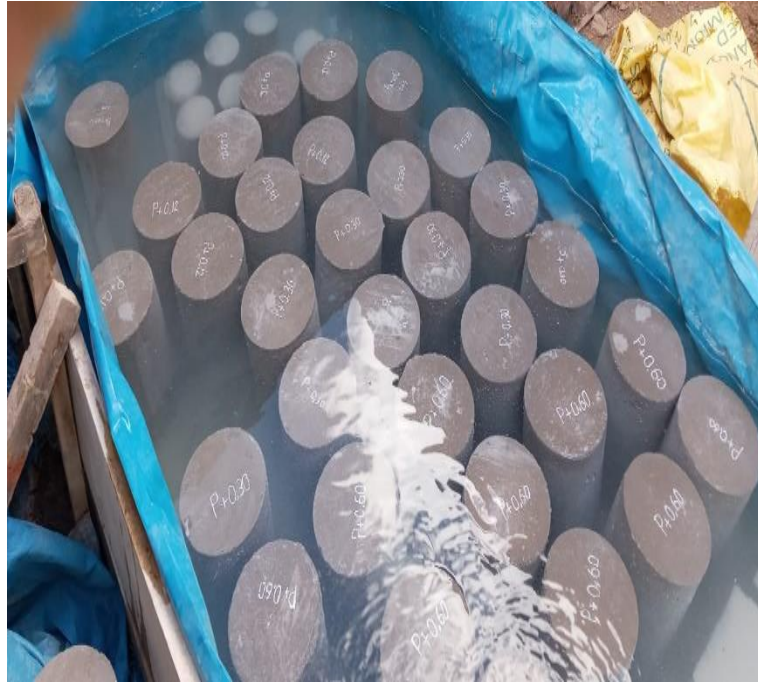
Figura 27: Curado de muestras cilíndricas
