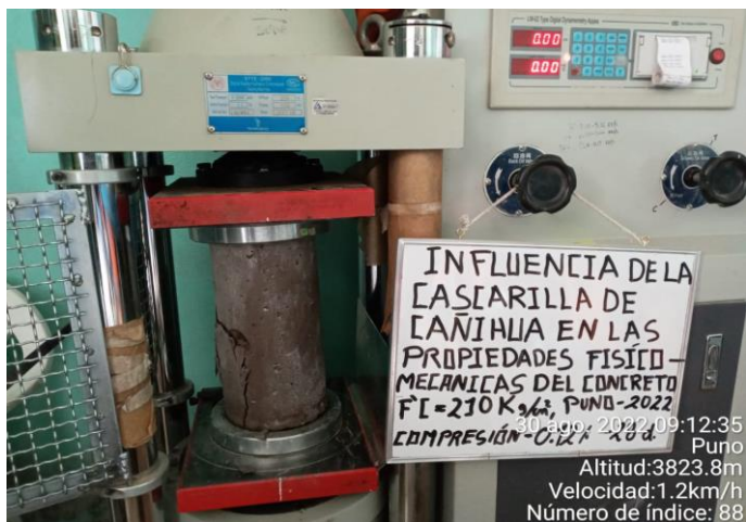
Fotografía N°42: resistencia a la compresión a los 28 días –muestra con adición al 0.12%
