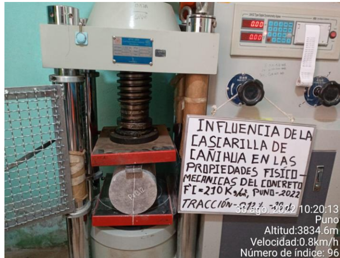
Fotografía N°46: resistencia a la tracción a los 28 días –muestra con adición al 0.12%
