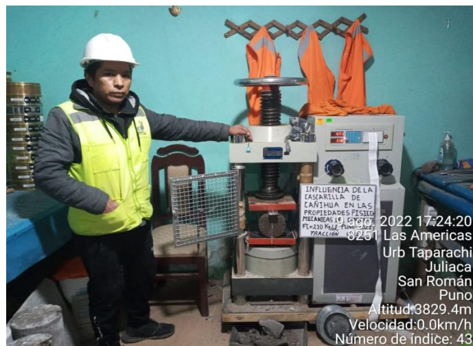
Fotografía N°26: resistencia a la tracción a los 7 días –muestra con adición al 0.12%
