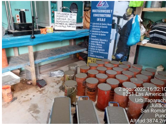
Fotografía N°19: desmoldado de muestras
