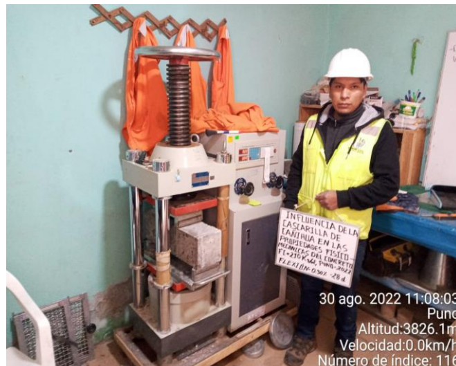
Fotografía N°51: resistencia a la flexión a los 28 días –muestra con adición al 0.30%
