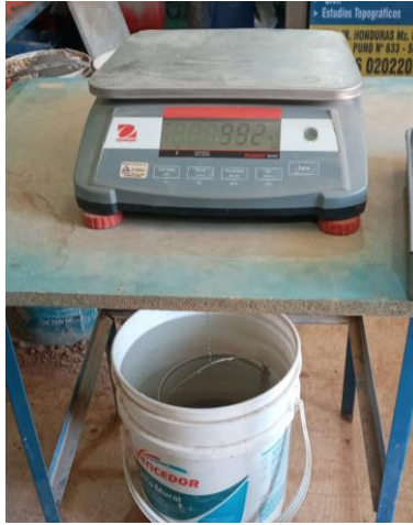
Figura 22: Peso específico del AG sumergido
