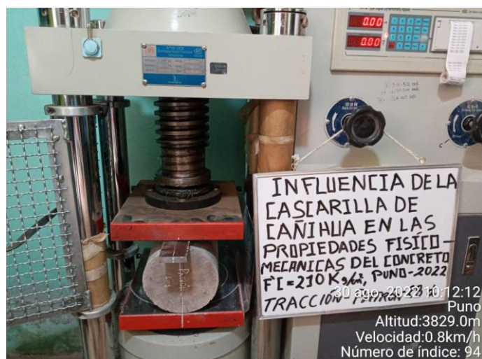
Fotografía N°45: resistencia a la tracción a los 28 días –muestra patrón
