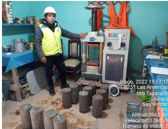
Fotografía N°20: preparado de muestras para el ensayos de resistencia
