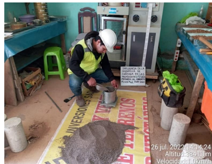
Fotografía N°2: separación del AF y AG
