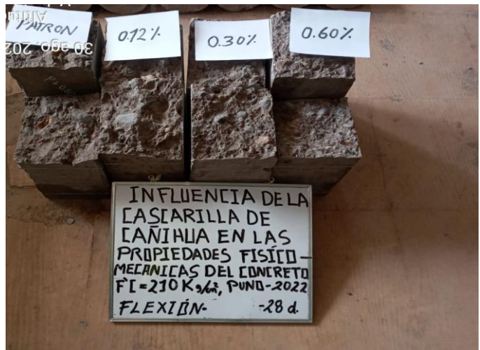
Fotografía N°53:muestras sometidas esfuerzos de resistencia a la flexión a los 28 días
