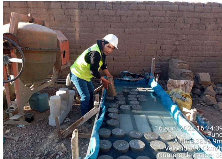
Fotografía N°31: extracción de muestras para ensayos de rotura a los 14 días
