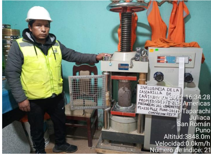
Fotografía N°22: resistencia a la compresión a los 7 días –muestra con adición al 0.12%
