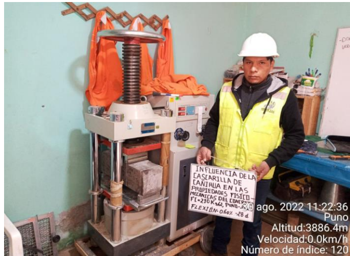
Fotografía N°52: resistencia a la flexión a los 28 días –muestra con adición al 0.60%
