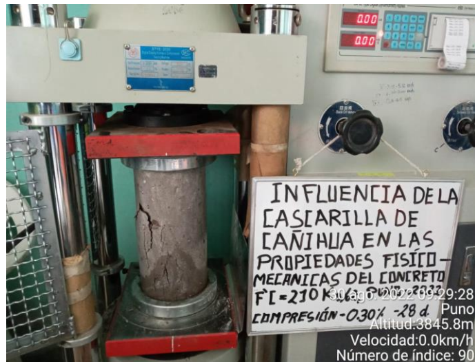
Fotografía N°43: resistencia a la compresión a los 28 días –muestra con adición al 0.30%
