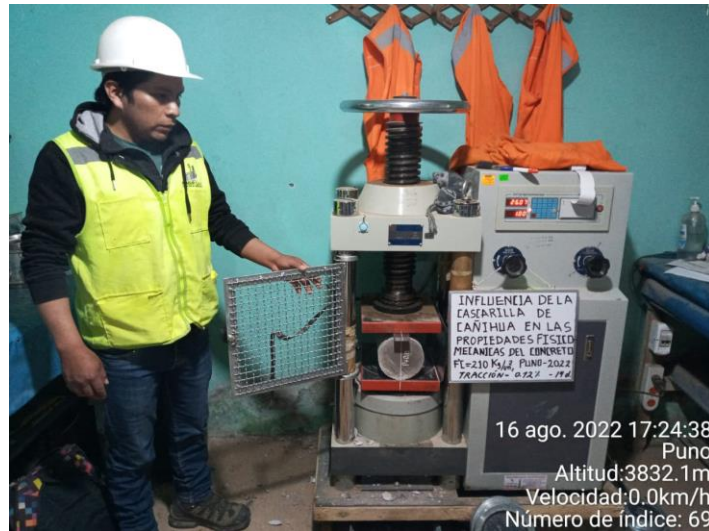
Fotografía N°37: resistencia a la tracción a los14 días –muestra con adición al 0.12%
