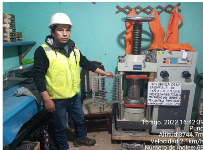
Fotografía N°33: resistencia a la compresión a los 14 días –muestra con adición al 0.12%
