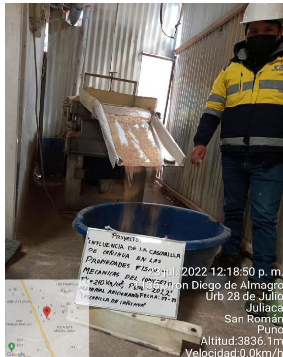
Figura 7: Separación del grano y la cascarilla
