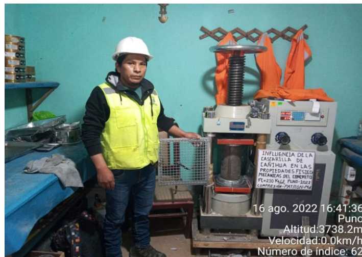
Fotografía N°32: resistencia a la compresión a los 14 días –muestra patrón
