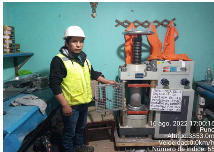
Fotografía N°35: resistencia a la compresión a los 14 días –muestra con adición al 0.60%
