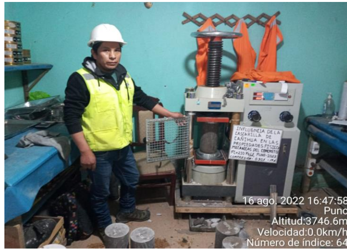
Fotografía N°34: resistencia a la compresión a los 14 días –muestra con adición al 0.30%
