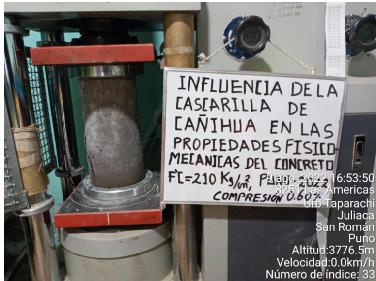
Figura 29: Rotura a la compresión
