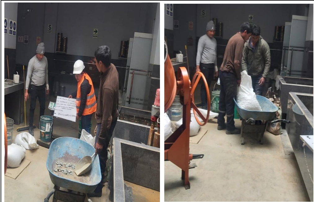
Control de las muestras de agregado grueso y agregado fino
