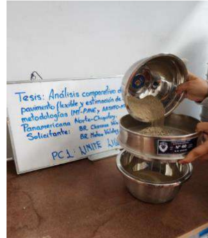
Figura 17: Tamizado de la muestra C-1 por tamiz N°40
