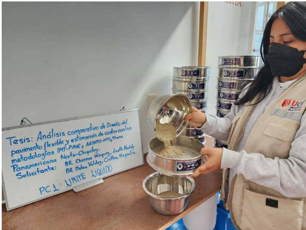
Figura 28: Matías Valdez Cinthia Magnolia realizando el estudio de límite líquido extraído de la calicata C-1.
