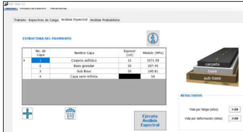
Figura 31: Cálculos del análisis espectral- Software IMT-PAVE.
