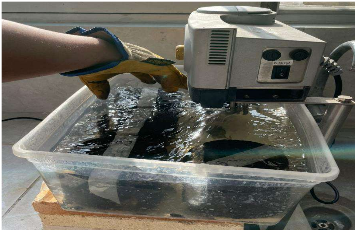
Figura 31: Chirinos Vásquez Liseth Medaly realizando el ensayo de Marshall
