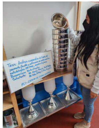
Figura 15: Tamizado de la muestra C-1
