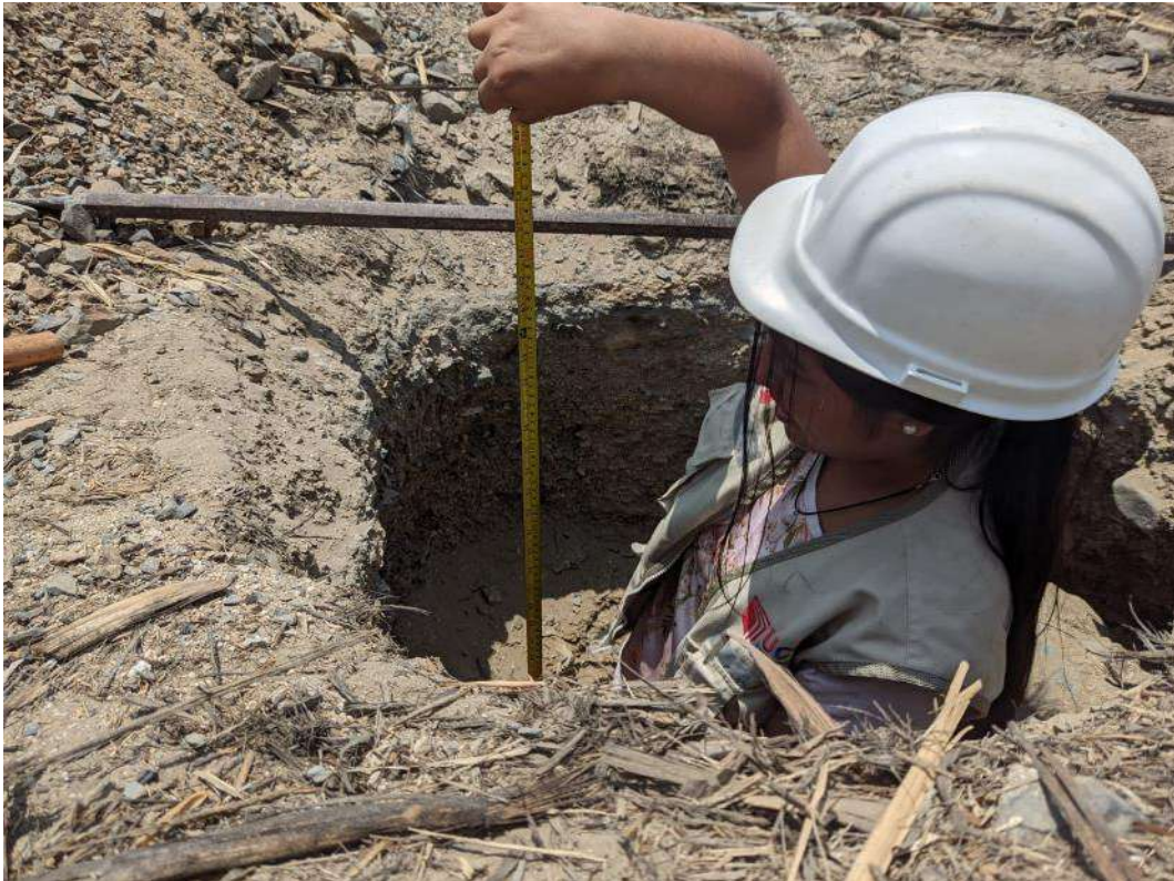
Figura 22: Chirinos Vásquez Liseth Medaly verificando la profundidad de la calicata C-1
