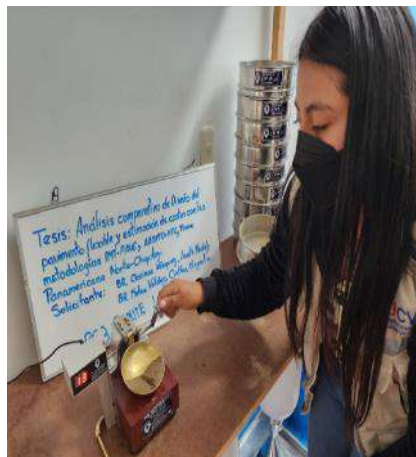
Figura 18: Obtención del Límite líquido de la muestra C-3
