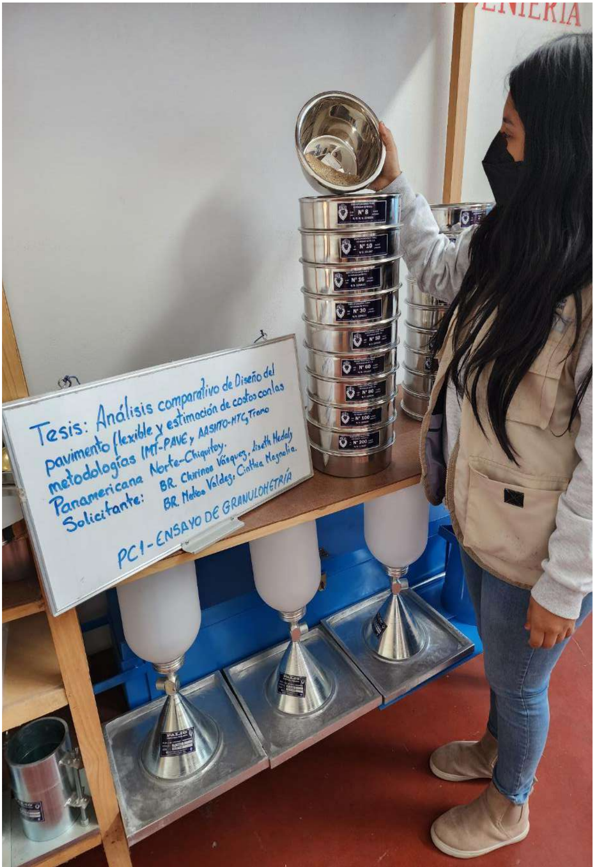
Figura 26: Matías Valdez Cinthia Magnolia realizando el ensayo de granulometría extraído de la calicata C-1.
