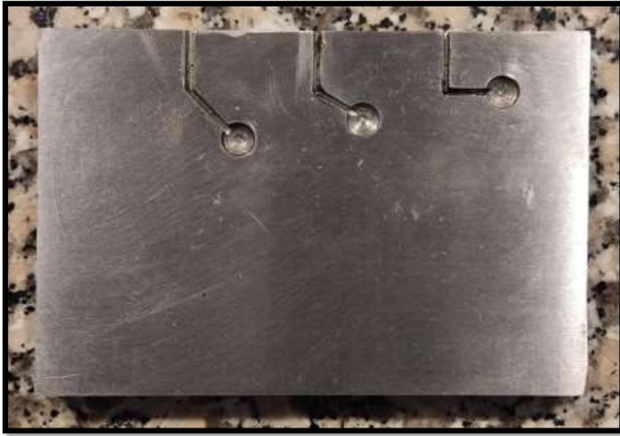
Fotografía 6. Canaleta de acero con angulación de  $60^\circ$  y  $90^\circ$ .<sup>8, 10, 12, 13</sup>
