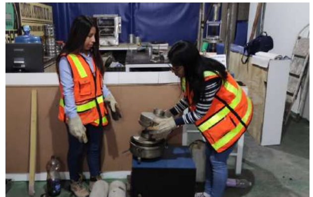
Lavado asfáltico en centrifuga.
