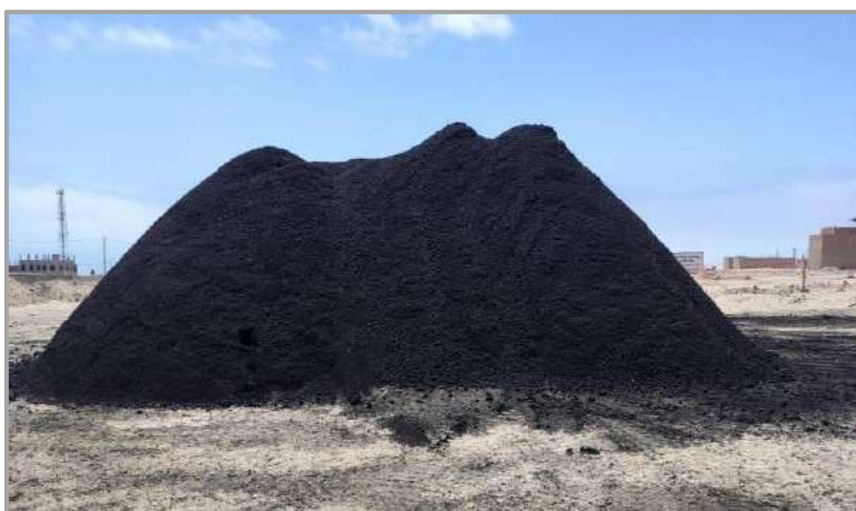
Figura 03. Mezcla asfáltica en frío
