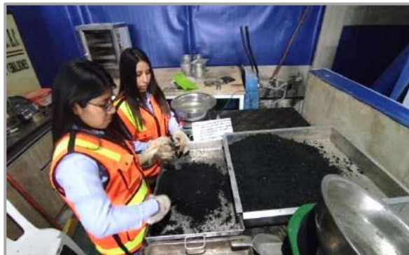
Figura 15. Preparación de material para lavado asfáltico en centrífuga.
