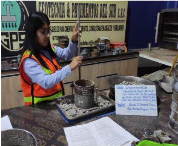
Varillado del agregado
