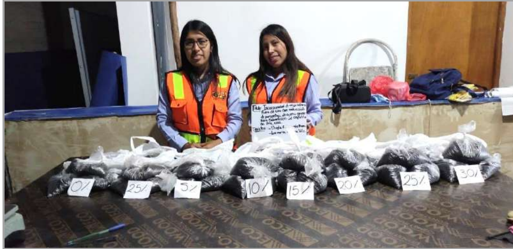
Figura 18. Pesaje de pastillas de asfalto mejorado con caucho.
