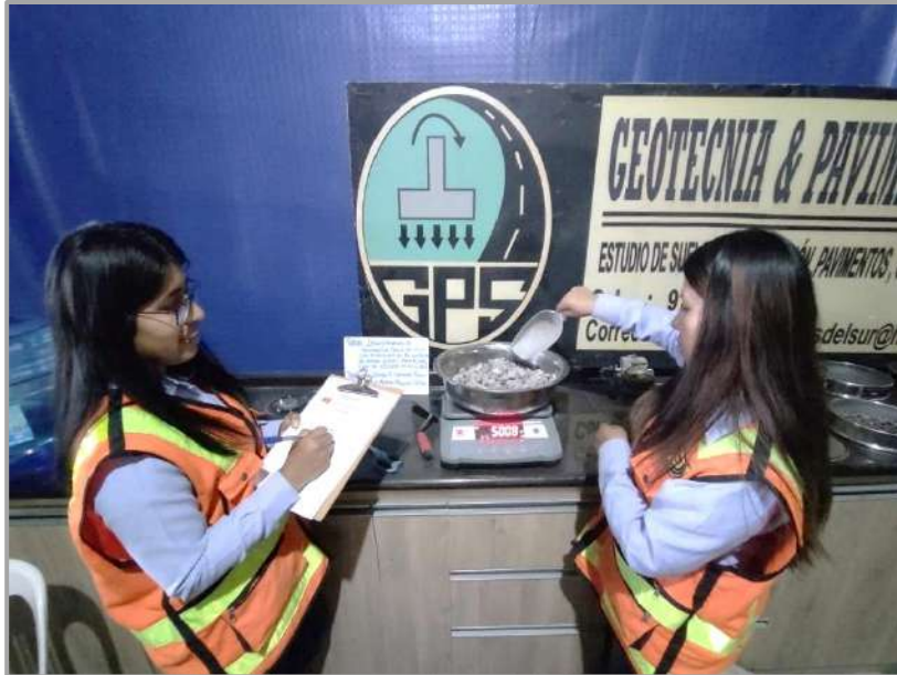
Figura 13. Ensayo de peso específico para el agregado grueso
