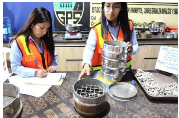
Ensayo Granulométrico del agregado grueso
