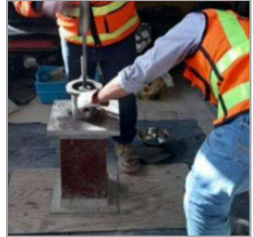
Compactación de pastillas
