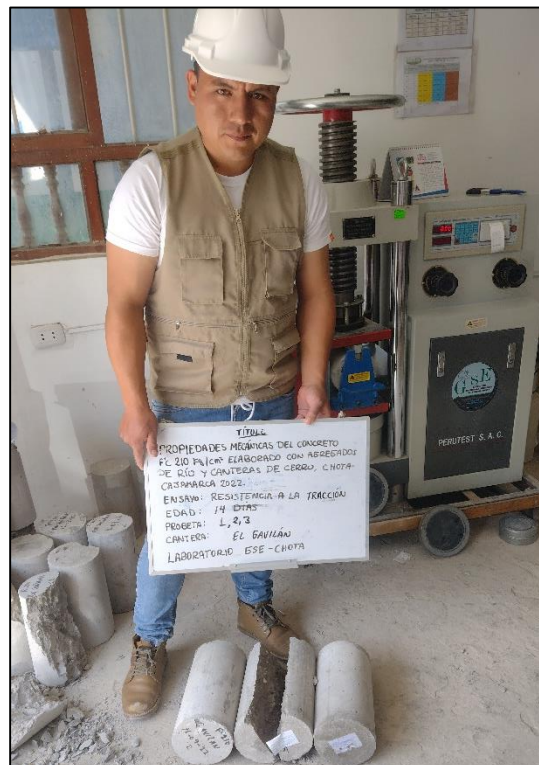
Fotografía 28: Falla de probetas a tracción
