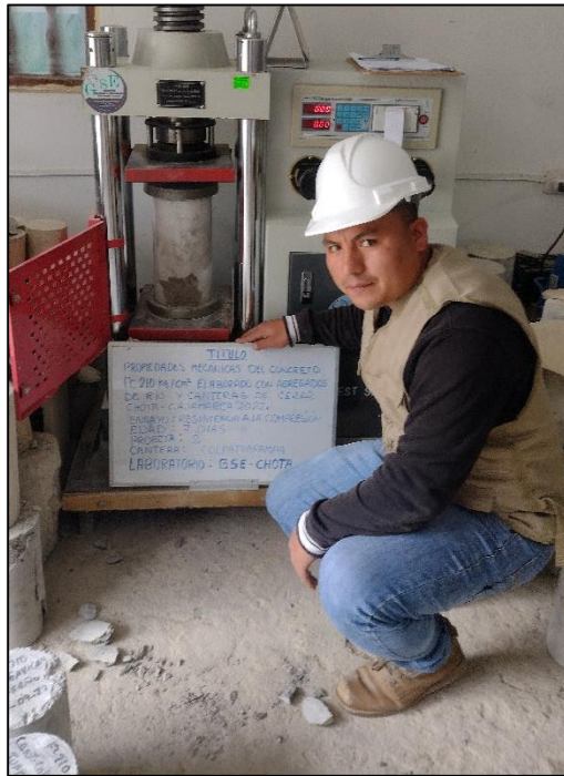
Fotografía 25: Ensayo de resistencia a compresión
