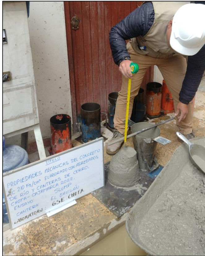
Fotografía 17: Ensayo de Slump
