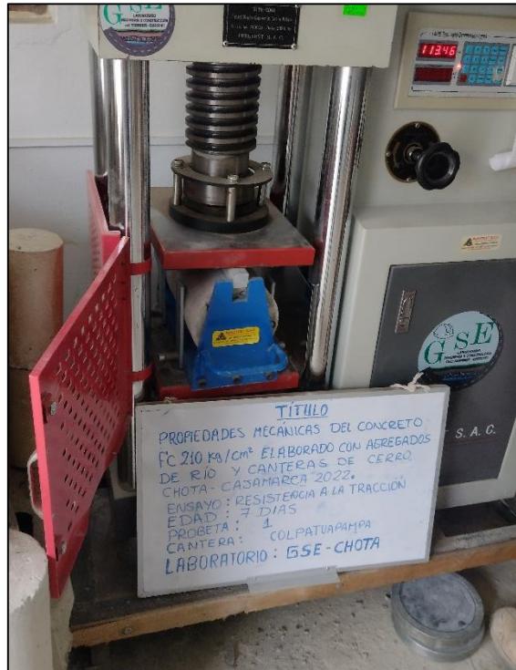
Fotografía 27: Ensayo de probetas a tracción
