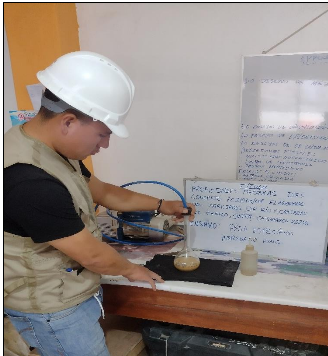
Fotografía 7: Extracción de vacíos
