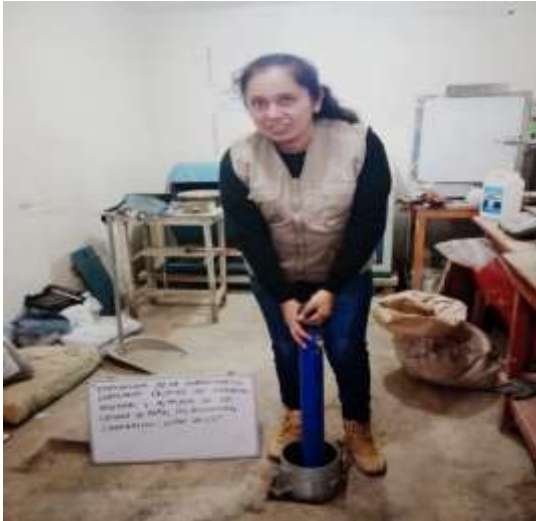
Fotografía 25: Compactación (Proctor Modificado).
