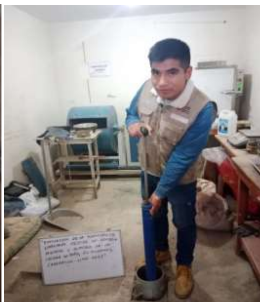
Figura 19. Ensayo de Proctor de Modificado (Compactación)
