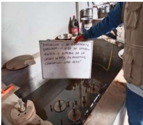
Figura 22: Ensayo de CBR (Moldes sumergidos en el agua)
