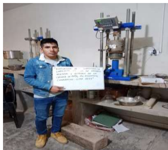
Figura 23: Ensayo de CBR Penetración de energía modificada
