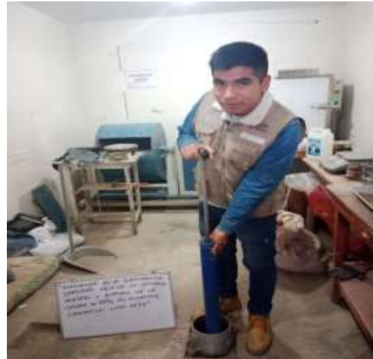
Fotografía 26: Compactación (Proctor Modificado).
