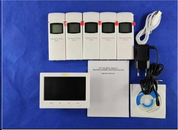
Equipo Termohigrómetro para la aplicación del estudio de campo, con 05 sensores de medición de registros por minuto y un centro de control para el almacenamiento de datos.
