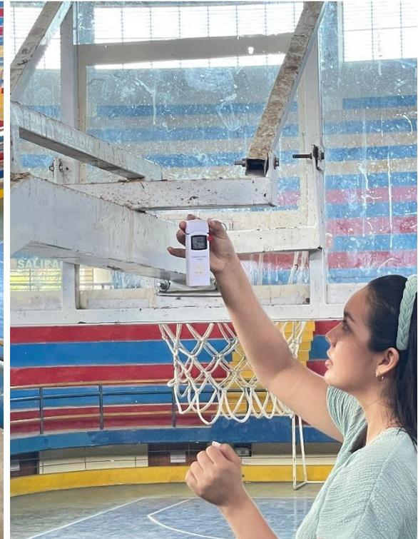
Instalación de los sensores en el interior del Coliseo Cerrado para la medición de la temperatura ( $^{\circ}\text{C}$ ) y la humedad (%).
