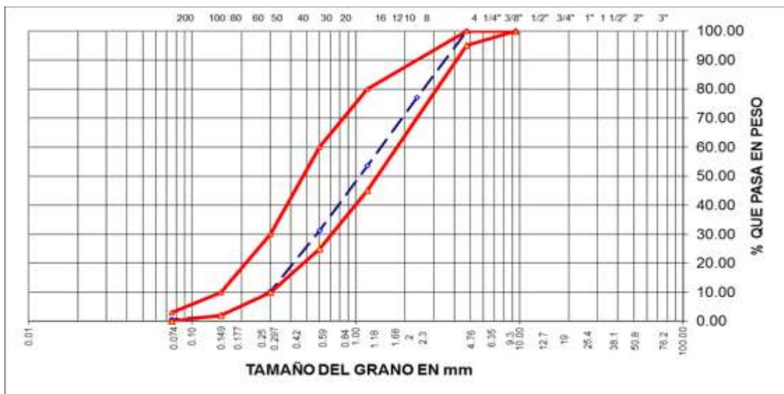
*Figura 2. Representación gráfica del análisis granulométrico del agregado fino*
