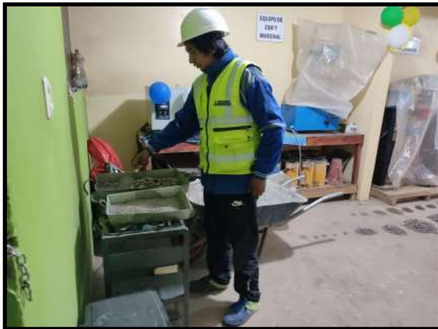
Fotografía 08: Eliminación de humedad del agregado para calcular su contenido de humedad
