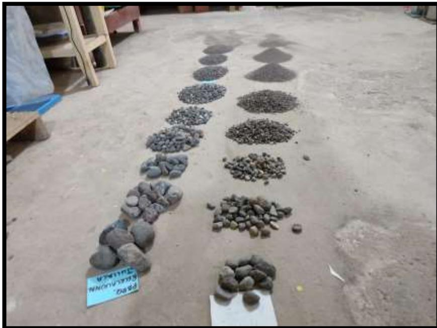
Fotografía 06: Gradación del agregado
