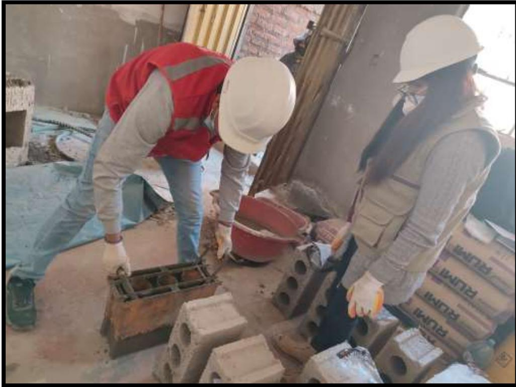
Fotografía 20: desmoldeo de bloques de concreto
