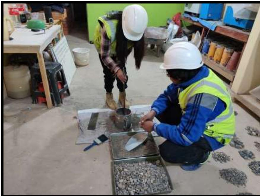
Fotografía 10: Ejecución del ensayo para calcular el peso unitario del agregado con el Proctor Modificado
