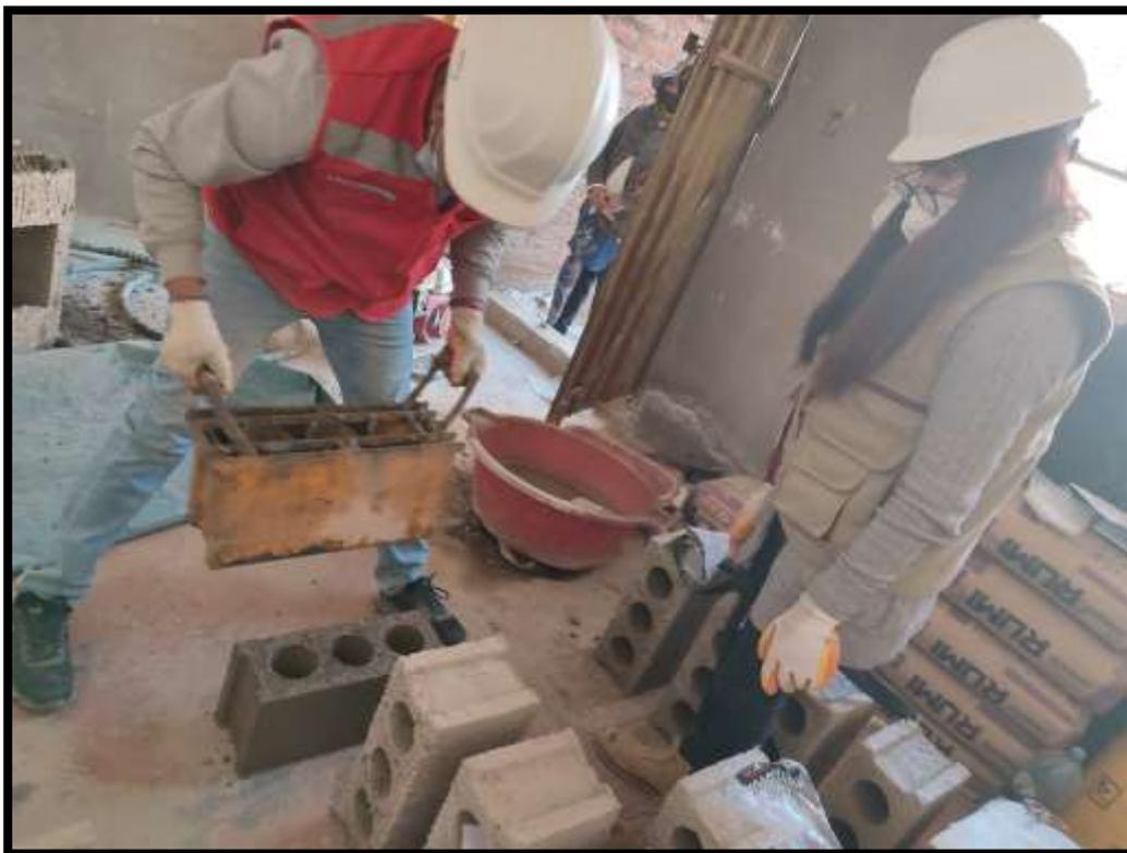
Fotografía 21: desmoldeo de bloques de concreto
