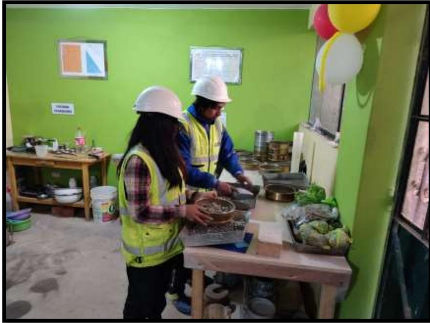
Fotografía 07: Ejecución del ensayo de granulometría para el diseño de mezcla de concreto
