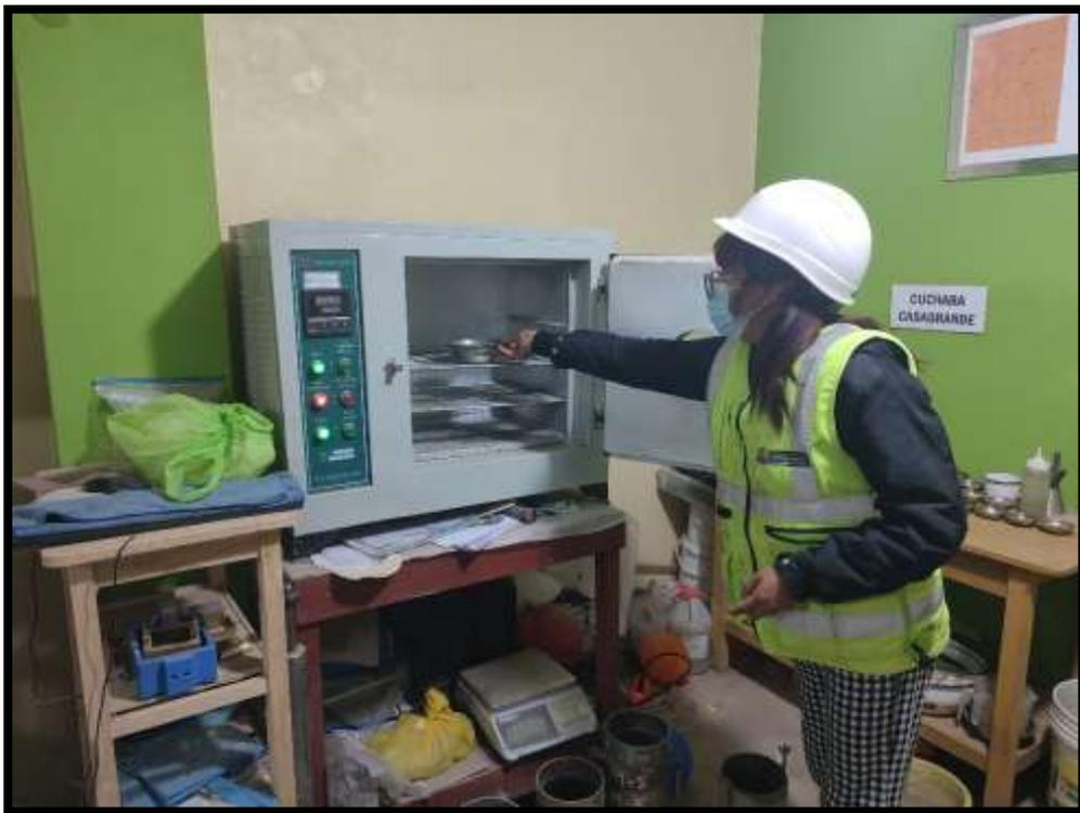
Figura 29: puesta de muestra húmeda para el ensayo de absorción
