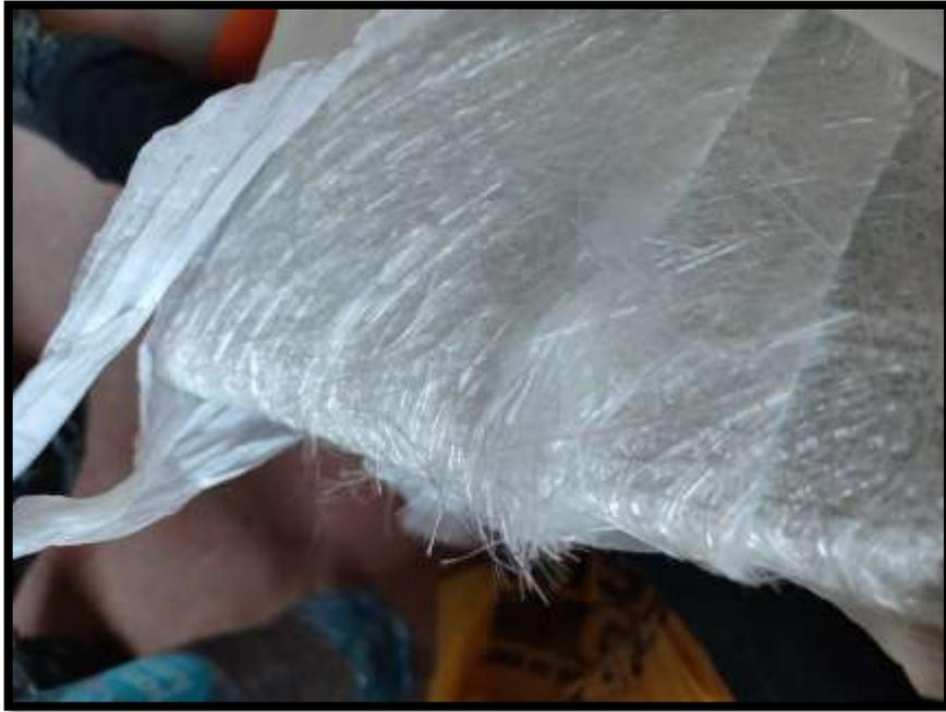
Fotografía 11: Fibra de vidrio para la elaboración de bloques de concreto
