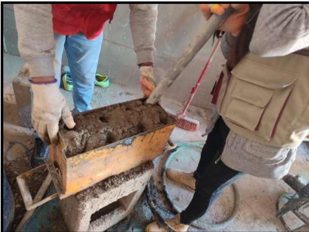
Fotografía 19: Vibrado en el moldeo de bloques de concreto
