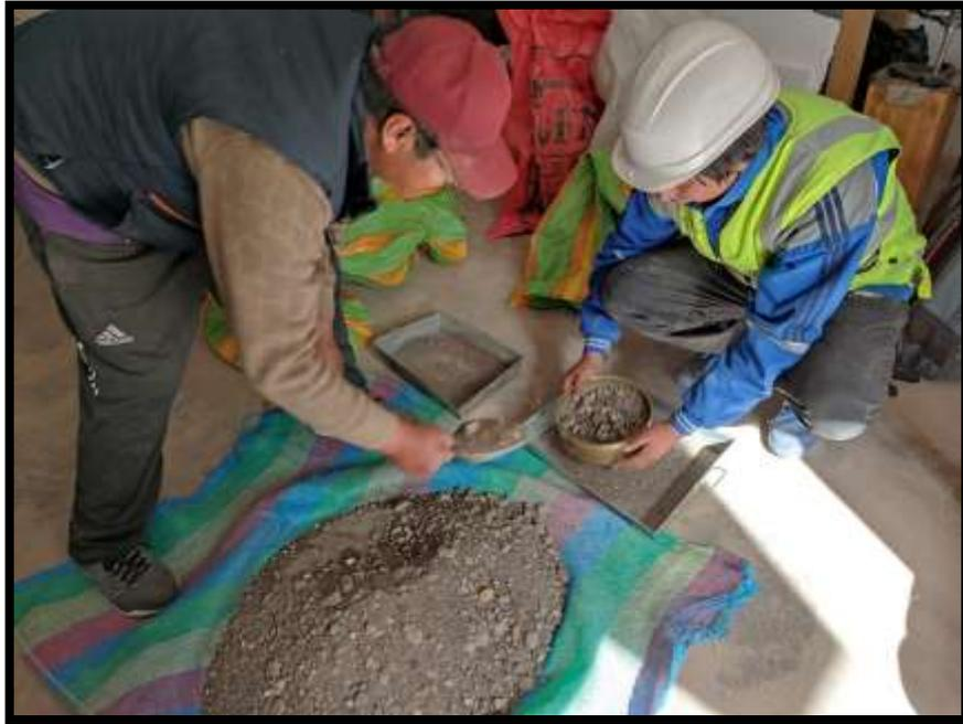
Fotografía 05: Ejecución del ensayo de granulometría para el agregado grueso
