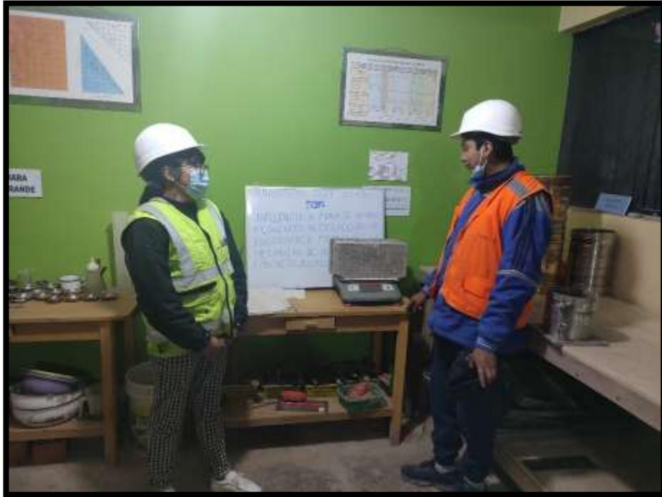
Figura 28: Pesado de bloque de concreto para el ensayo de absorción
