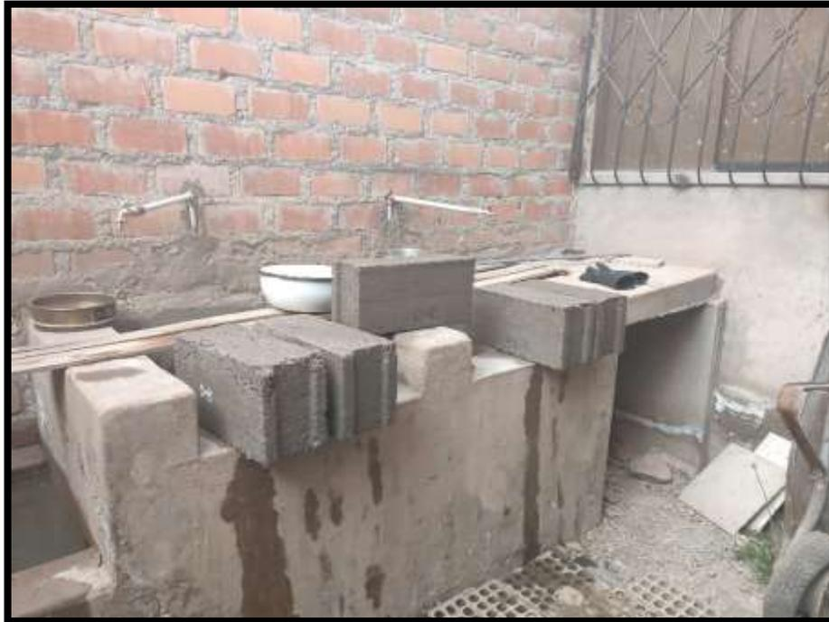
Fotografía 30: sacado de los bloques sumergidos después de 24h
