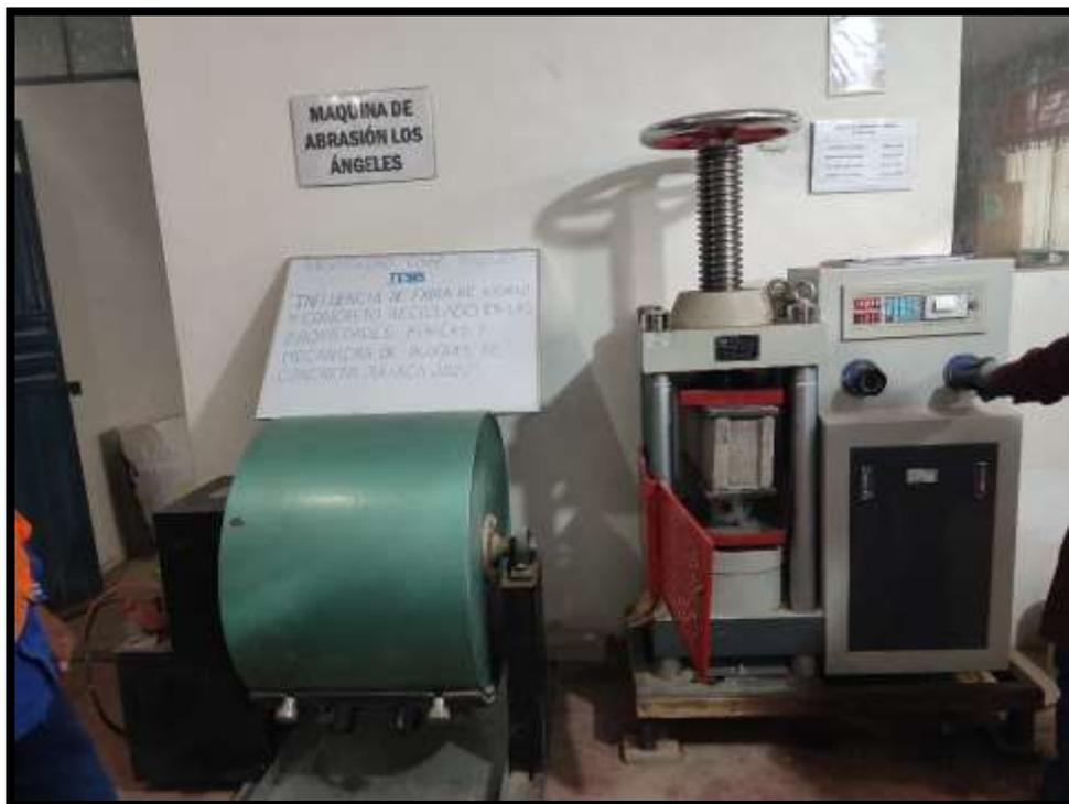
Fotografía 35: máquina de resistencia a la compresión en bloques de concreto
