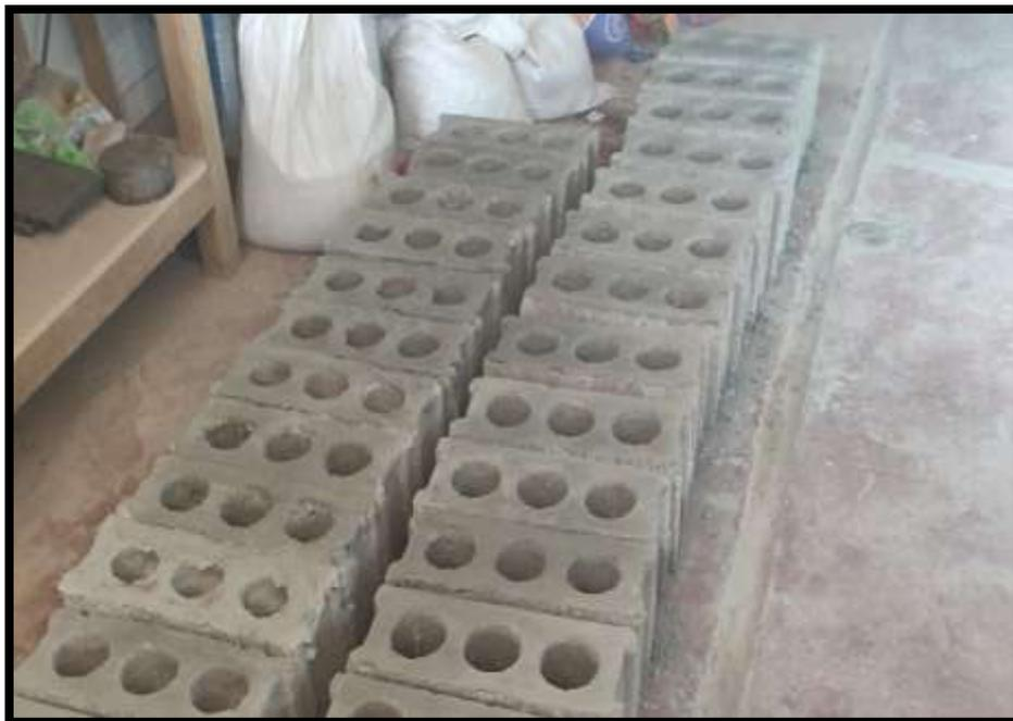
Fotografía 32: Bloques de concreto refrentados para el ensayo de resistencia a la compresión
