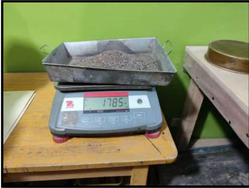
Fotografía 09: Peso del agregado para calcular su contenido de humedad
