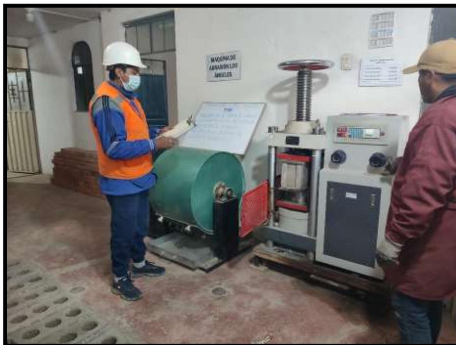
Fotografía 33: resistencia a la compresión en bloques de concreto
