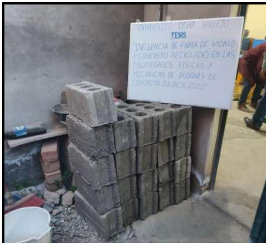
Fotografía 31: Bloques de concreto para el ensayo de absorción y alabeo
