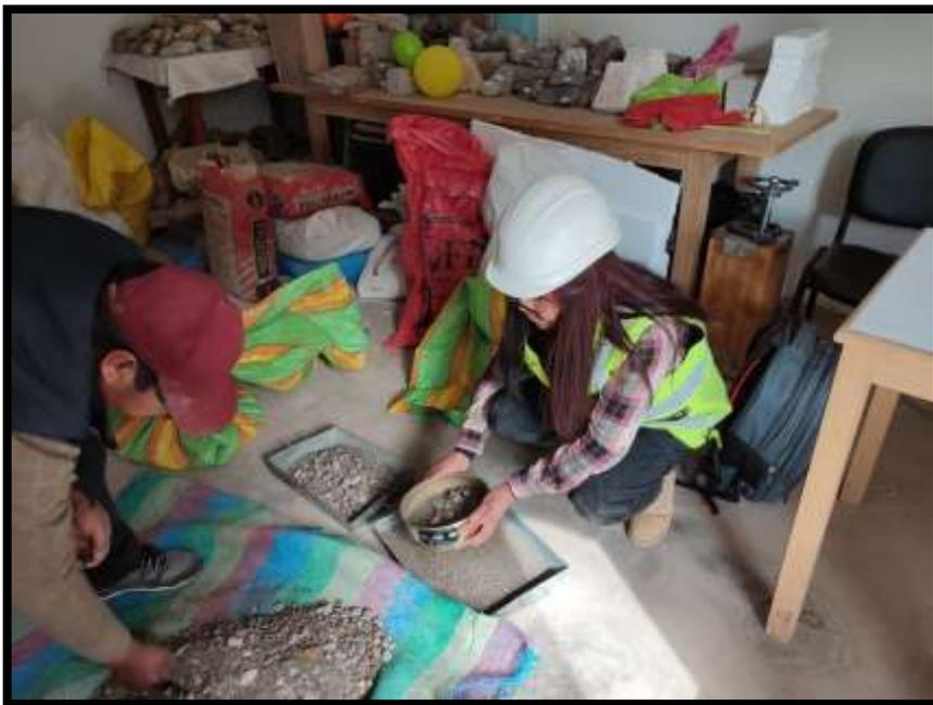
Fotografía 04: Ejecución del ensayo de granulometría para el agregado fino
