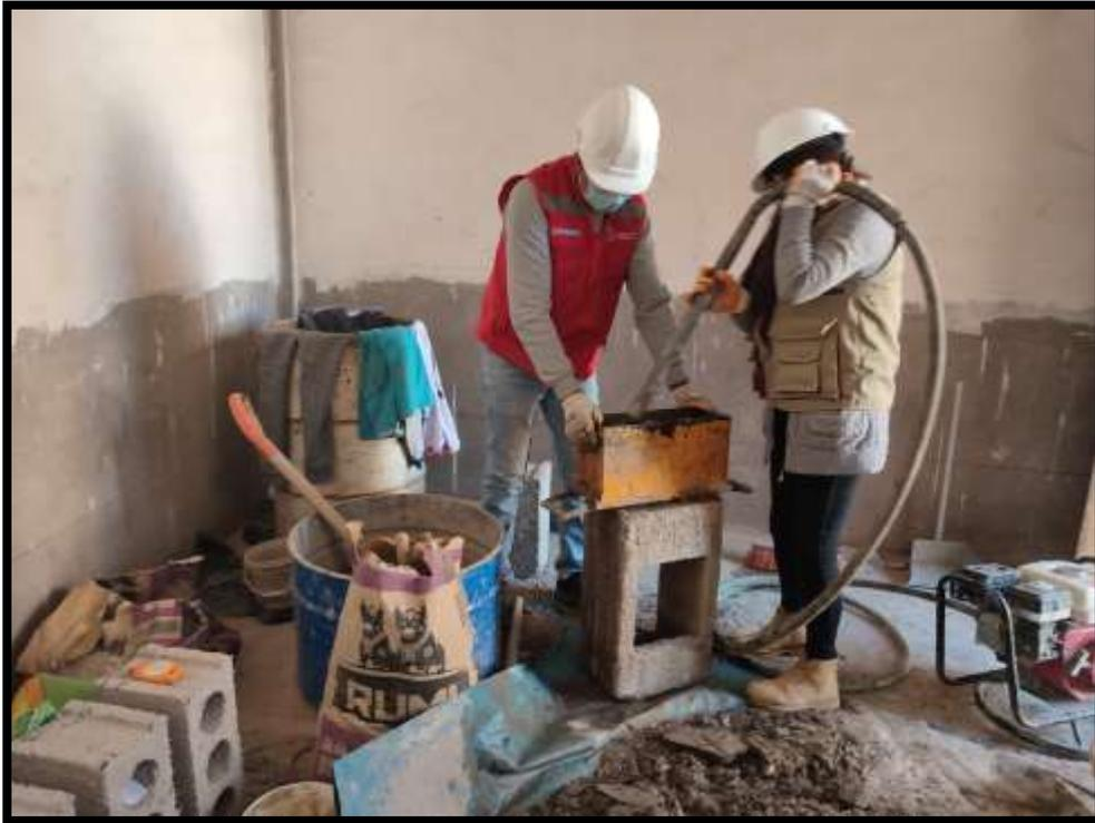
Fotografía 18: Vibrado en el moldeo de bloques de concreto
