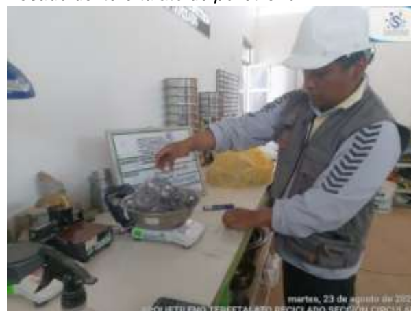
Figura 36: Pesado del tereftalato de polietileno
