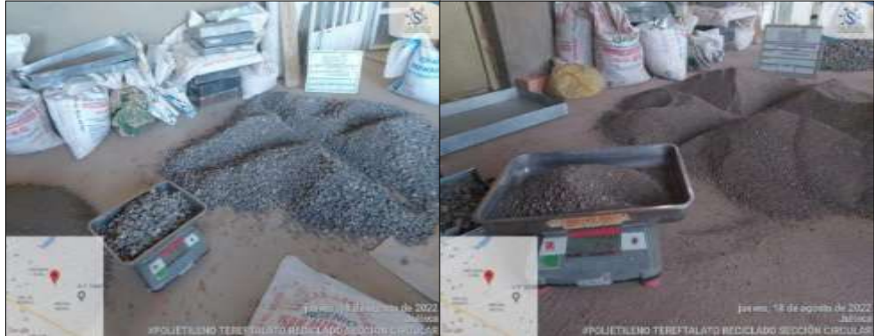
Figura 6: Cuarteo del agregado grueso y fino
