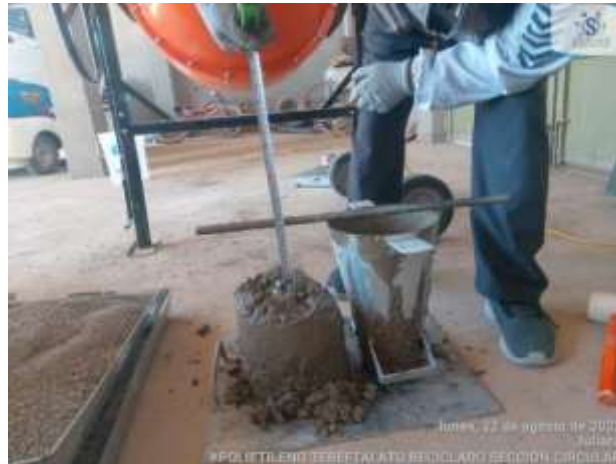
Figura 35: Asentamiento del concreto fresco con adición de 0.75%
