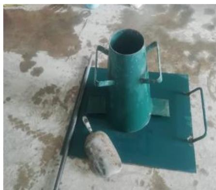
**Figura 19.** Ensayo de consistencia (Slump) **Figura 20.** Cono de abrams
