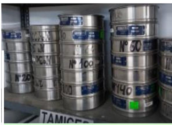
**Figura 8.** Tamices del ensayo de granulometría.
