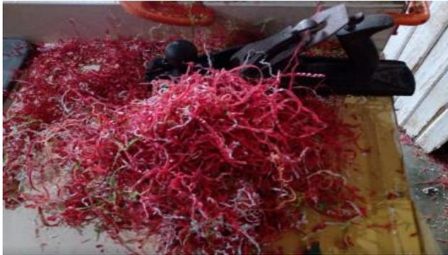
**Figura 5:** Fibra de polipropileno reciclable
