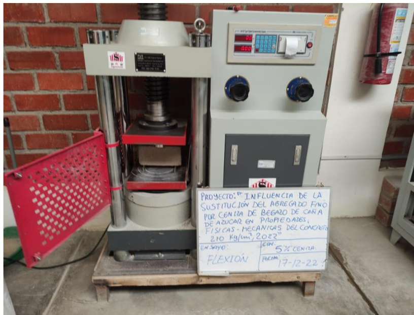
Foto N°06: resistencia a la flexión
