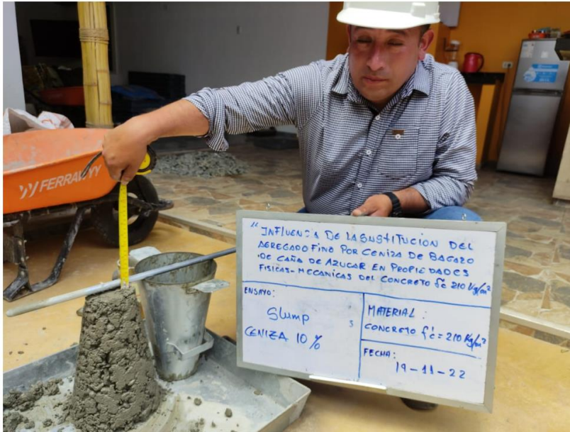
Foto N°01: asentamiento o Slump
