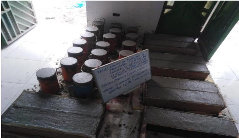
Figura 9. Probetas cilíndricas y prismáticas vaciadas. Fuente: Elaboración propia.
