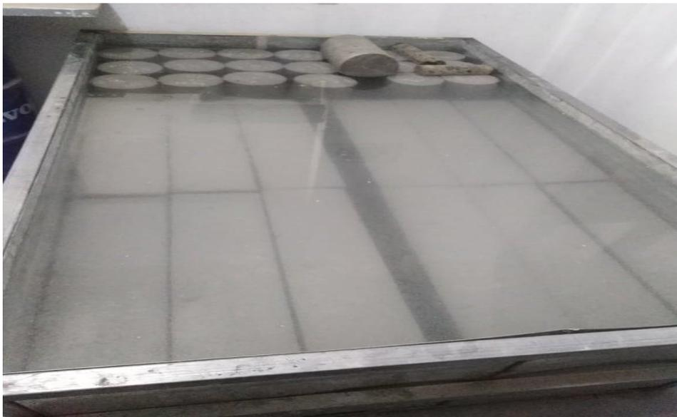
Figura 10. Curado de probetas cilíndricas y prismáticas. Fuente: Elaboración propia.
