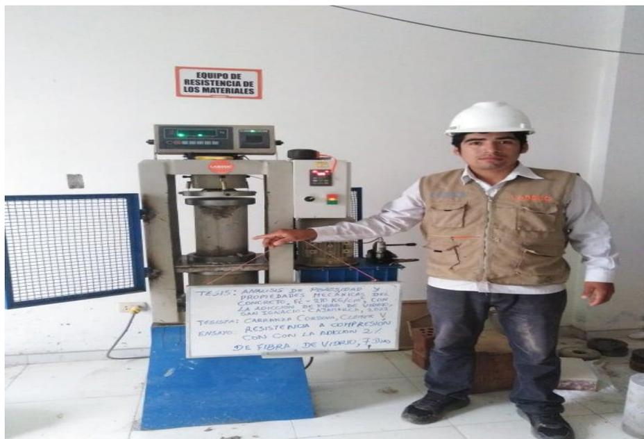
Ensayo de resistencia a compresión a los 7 días concreto con adición 1.5 de fibra de vidrio.
