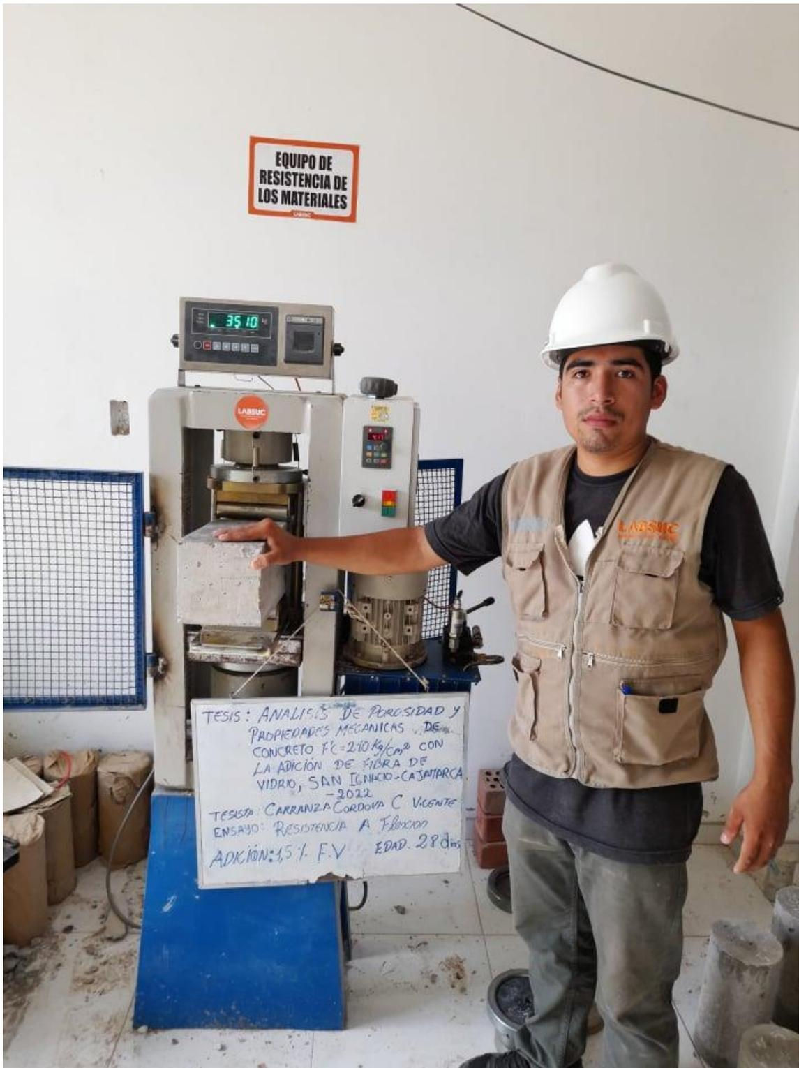
Ensayo de flexión a los 28 días concreto con adición de 1.5 de fibra de vidrio. fuente: Elaboración propia
