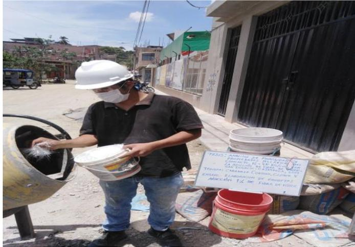
Figura 7. Preparación de mezcla con adición de fibra de vidrio. Fuente: Elaboración propia
