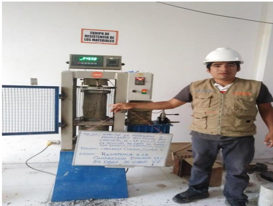
Ensayo de resistencia a compresión a los 7 días concreto con adición 1% de fibra de vidrio.
