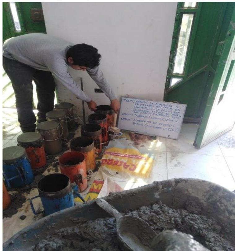
Figura 8. Elaboración de probetas. Fuente: Elaboración propia.
