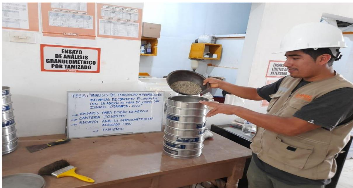
Figura 14. Ensayo de Análisis granulométrico del agregado fin. Fuente: Elaboración propia
