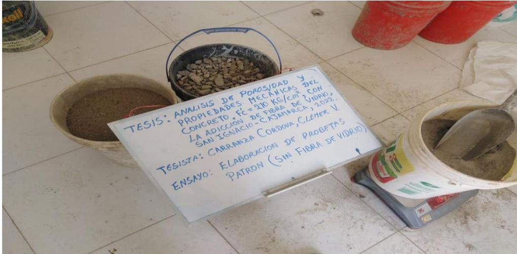
Figura 5. Agregado fino y grueso, cemento para elaboración.
