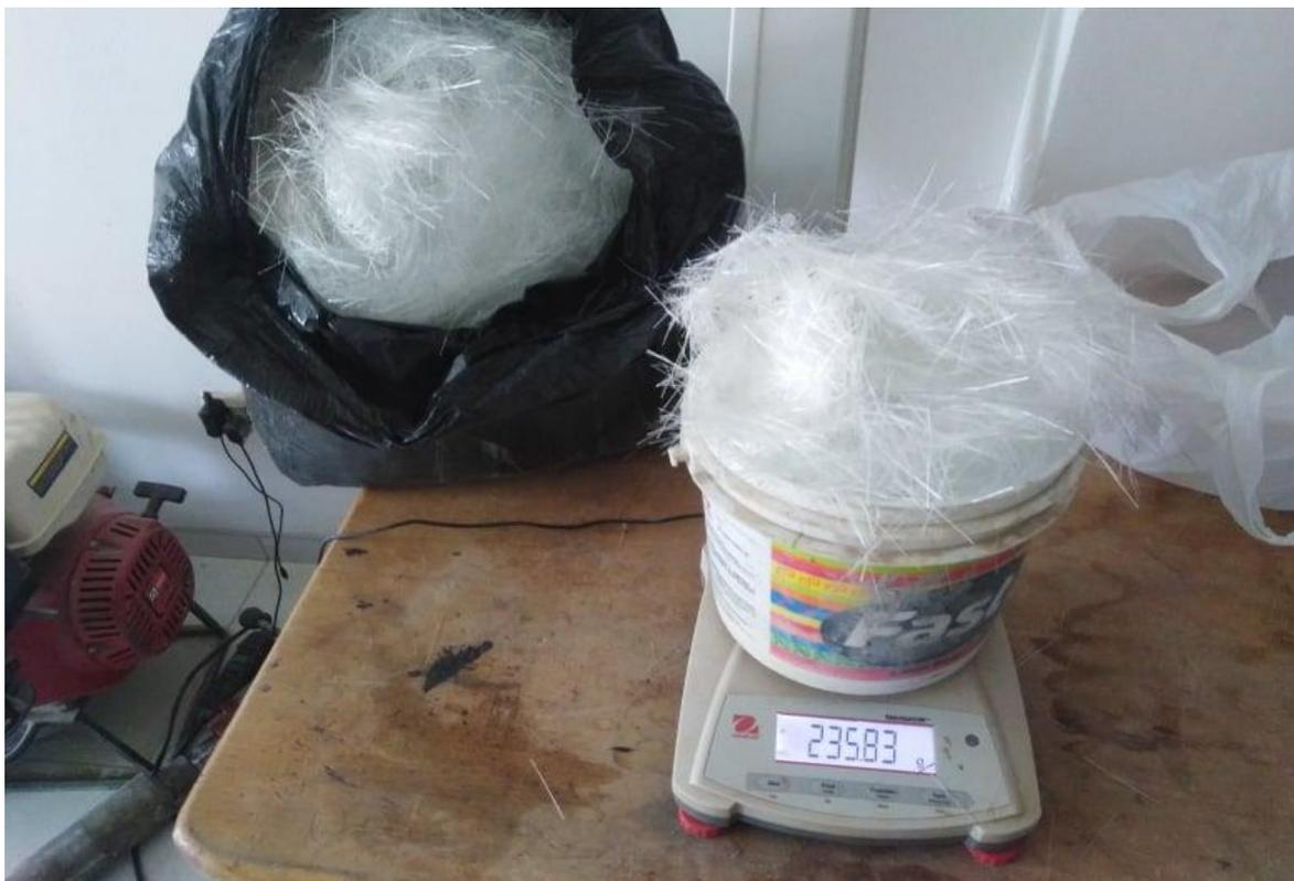
Figura 4. Fibra de vidrio pesada para el concreto. Fuente: Elaboración propia
