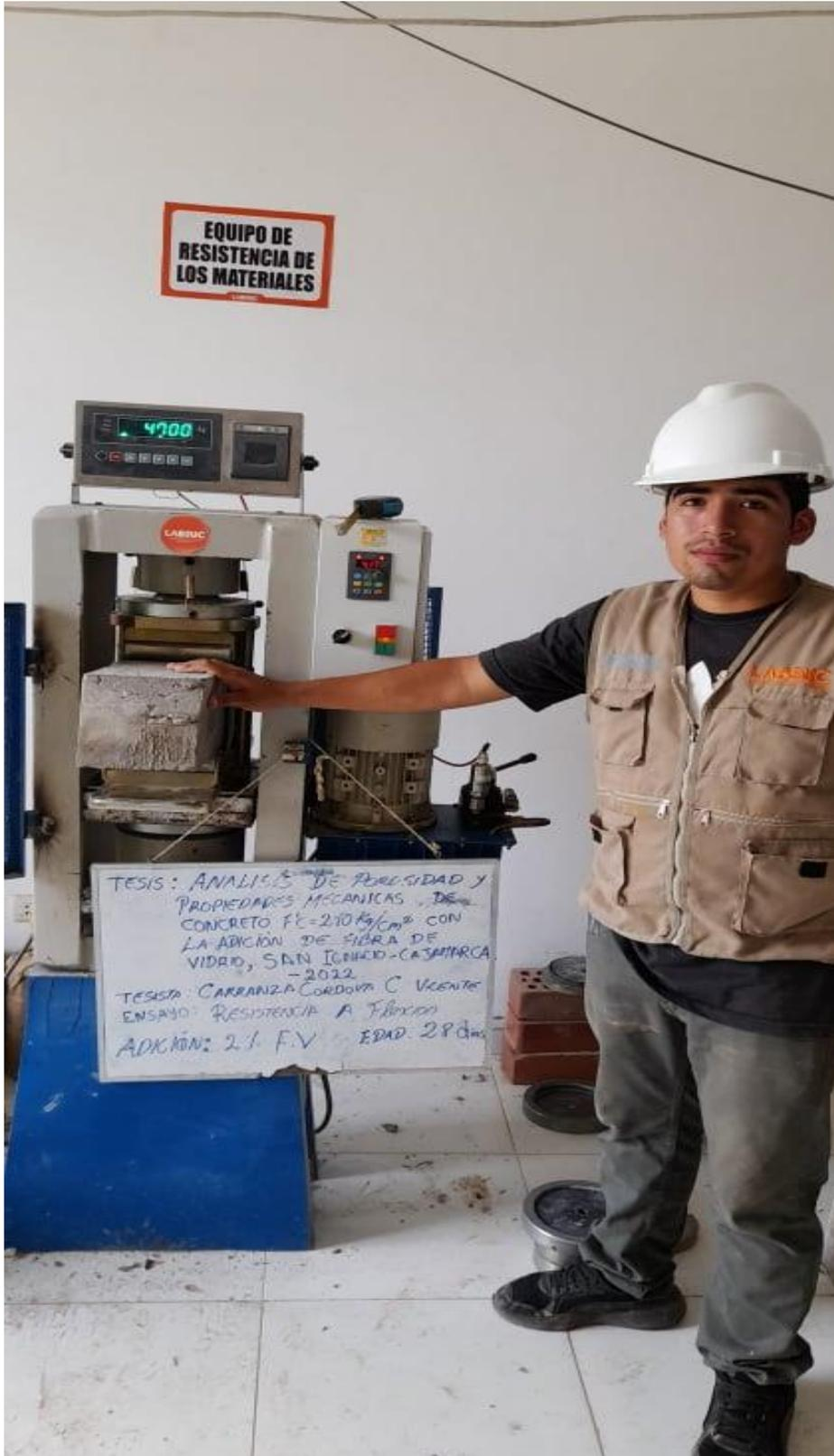
Ensayo de flexión a los 28 días concreto con adición de 2% de fibra de vidrio. Fuente: Elaboración propia
