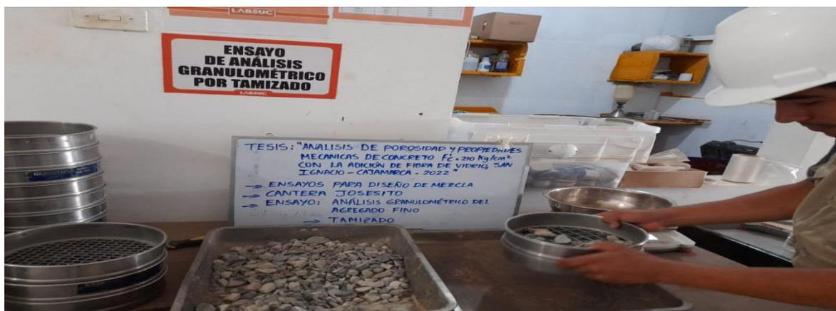
Figura 12. Ensayo granulométrico del agregado grueso. Fuente: Elaboración propia
