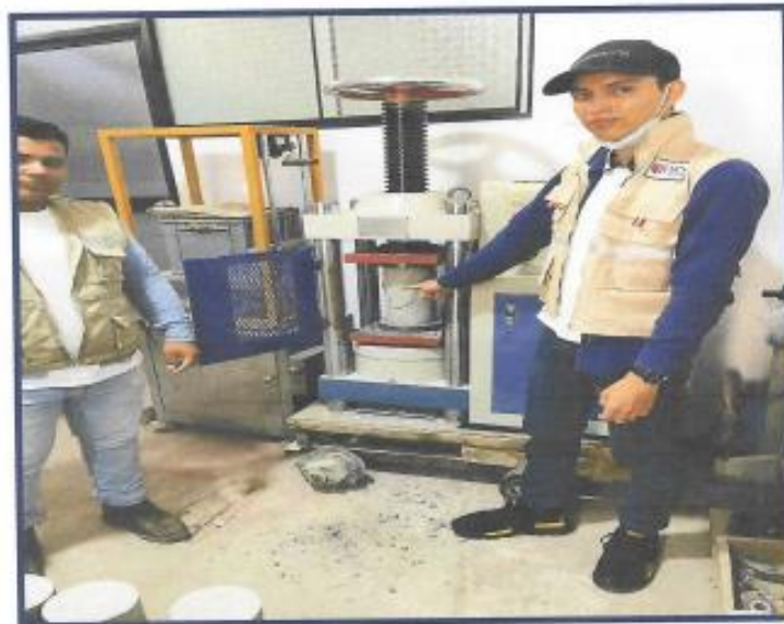
REALIZANDO LA ROTURA DEL DISEÑO
