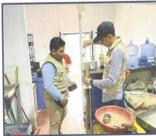
ENSAYO DE EQUIVALENTE DE ARENA
