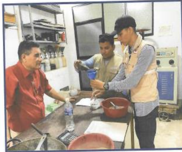
PESO ESPECÍFICO DEL FINO
