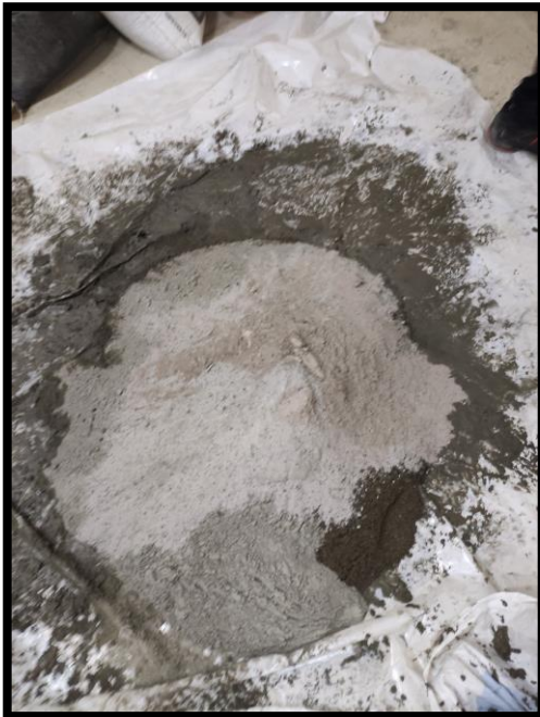
Concreto experimental 2: La sustitución del cemento por la combinación de 3% ceniza de molle y 2% ceniza de eucalipto.
