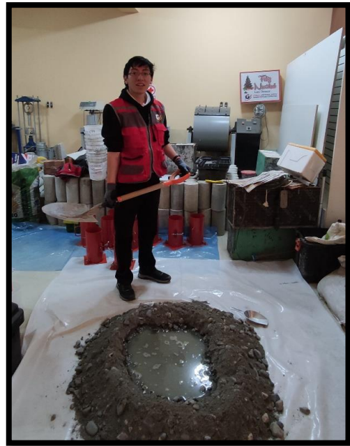
La preparación del concreto para 9 probetas.
