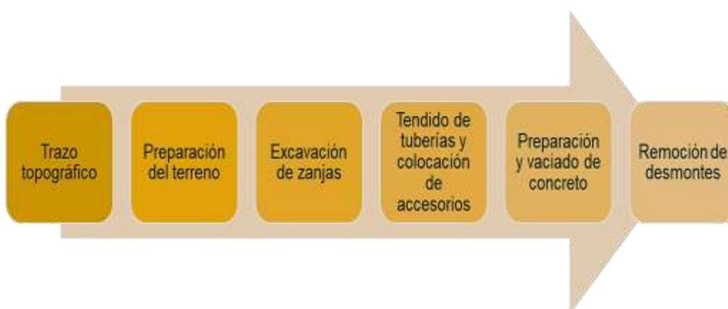
Figura 16. Flujograma a seguir para instalar redes sanitarias y de alcantarillado.
