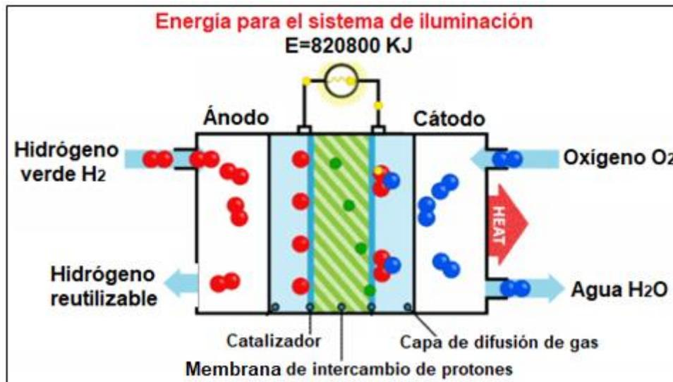
Figura 15: Productos y reactivos en una pila de combustible.
