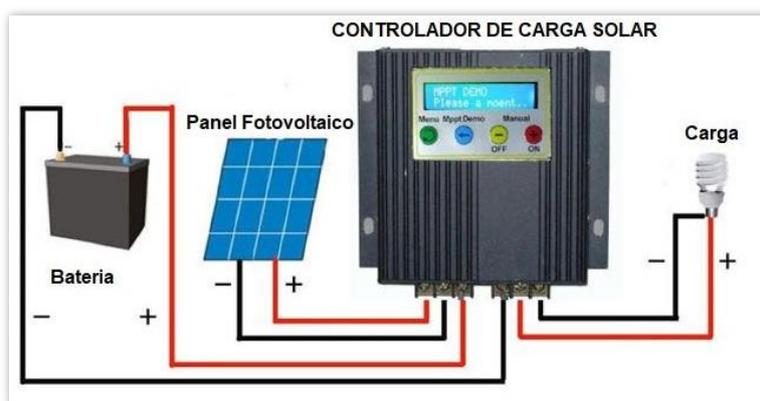
Figura 7: Conexión del regulador de carga solar
