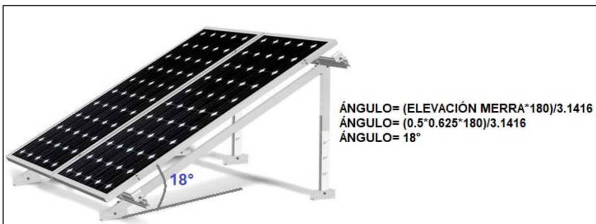
Figura 11: Ángulo de inclinación de los paneles fotovoltaicos
