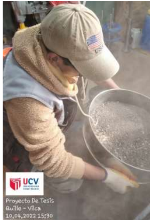
Tamizado del agregado fino por la malla N°4
