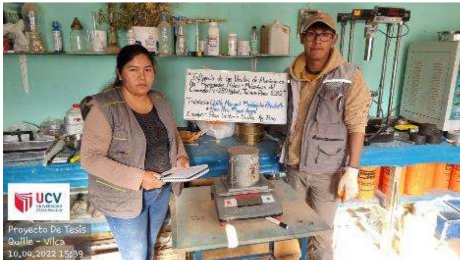
Peso del agregado fino suelto
