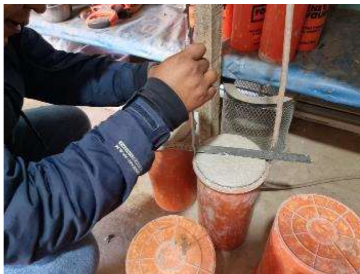
Se ve la expansión del concreto luego de pasar las 24 horas
