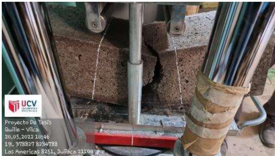
Ensayo de resistencia a la flexión
