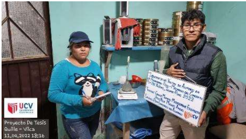
Peso del picnómetro con viruta de aluminio
