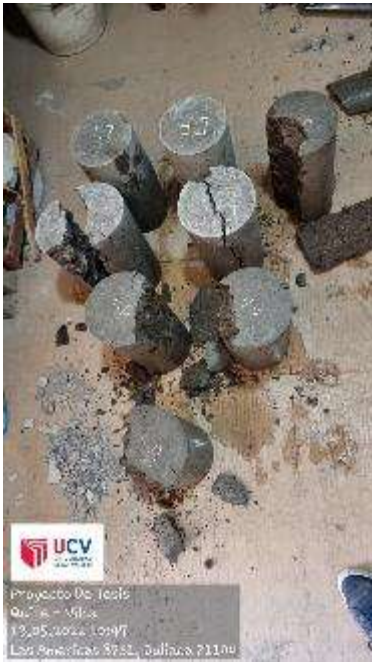
Ruptura de probetas cilíndricas y vigas del concreto patrón y modificada edad de 28 días.
