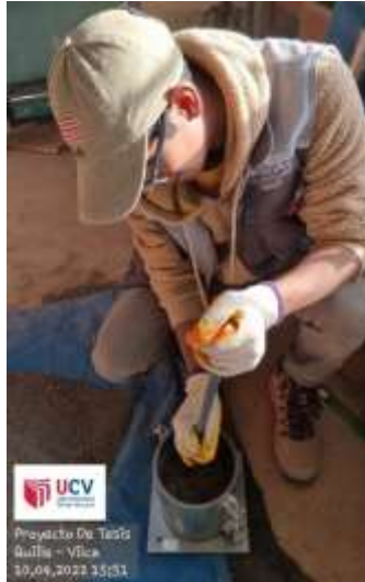
Se compacta con una varilla 5/8"
