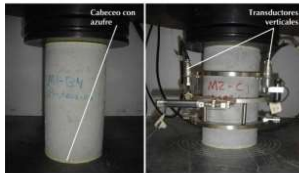
Figura 4. Ensayo de resistencia a compresión
