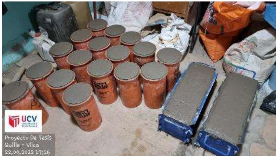
Probetas y vigas con adición de virutas
