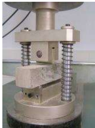
Figura 5. Ensayo (Resistencia a flexion)
