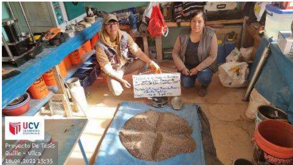
Cuarteo del agregado fino
