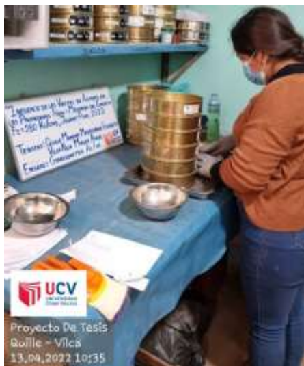
Tamizado del agregado fino
