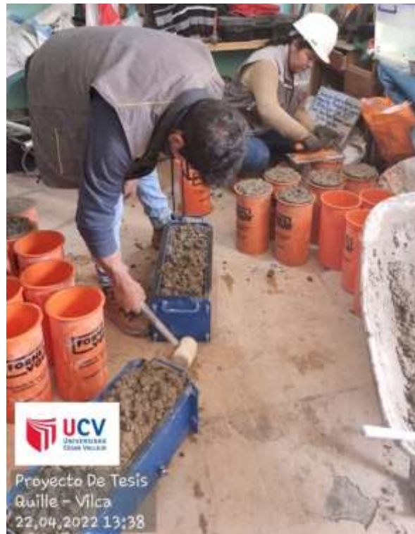
Enrasado de probetas y vigas
