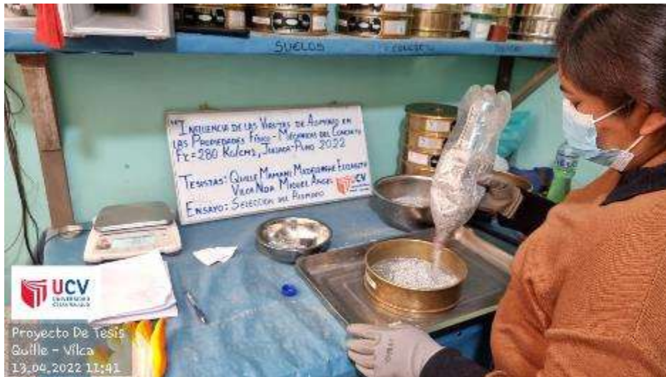
Tamizado de la viruta de aluminio
