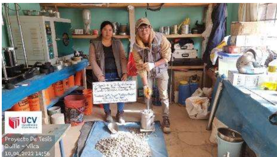
Peso unitario compactado del agregado grueso
