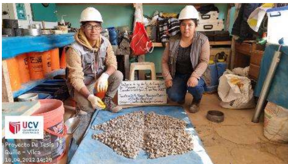
Cuarteo del agregado fino
