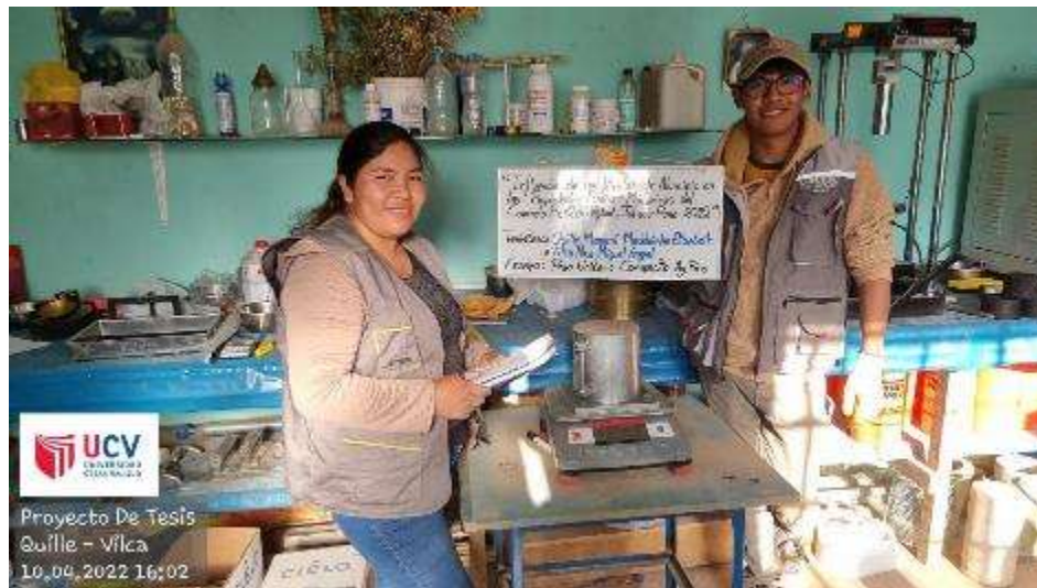
Peso unitario compactado del agregado fino
