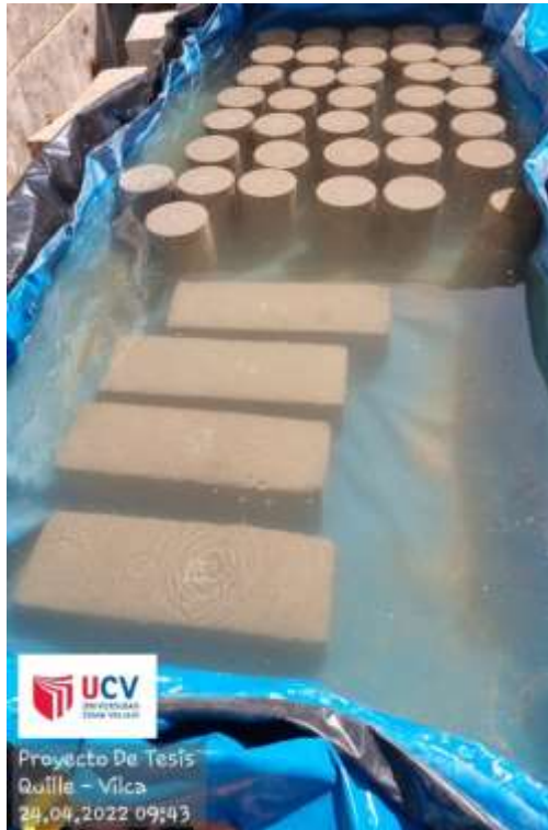
Curado de probetas
