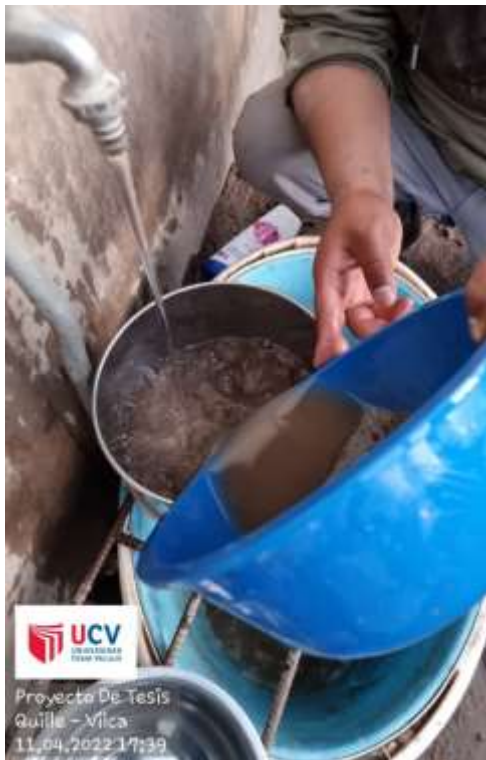
Lavado del agregado fino
