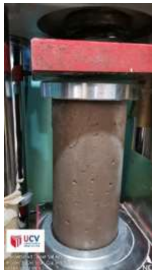
Ensayo de resistencia a la compresión a los 7 días
