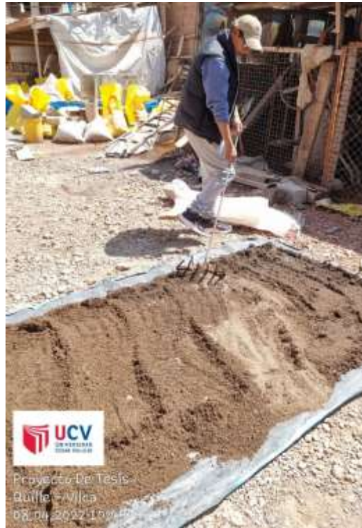
Secado de agregado fino
