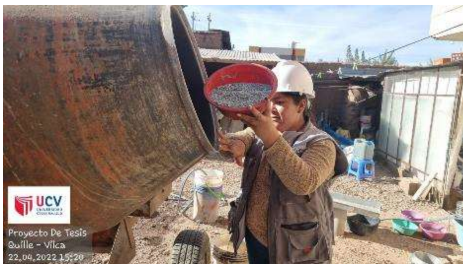
Se añade aluminio a la mezcladora
