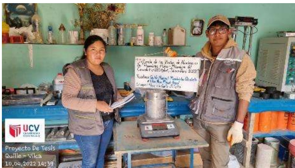
Peso unitario suelto del agregado grueso
