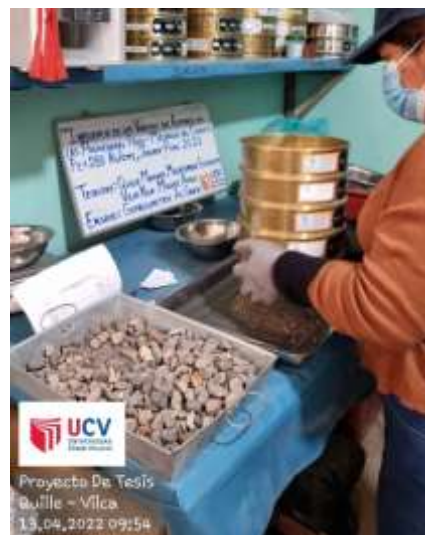
Tamizado del agregado grueso
