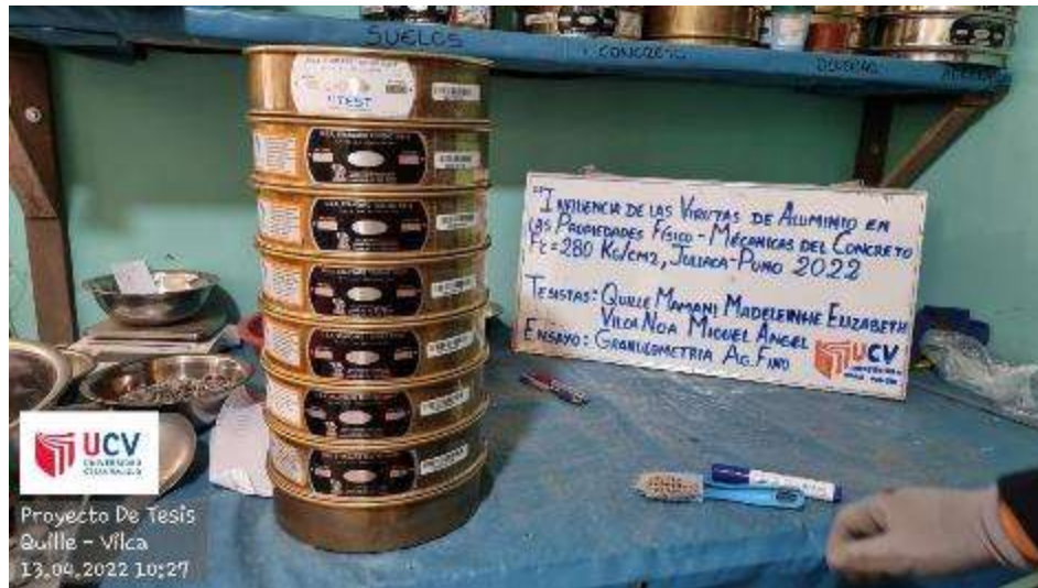
Tamices para realizar el ensayo de granulometría del agregado fino
