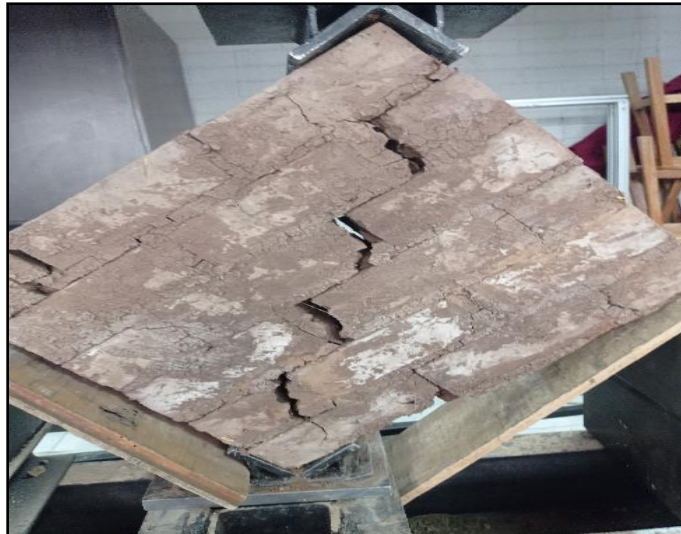
Figura 17. Resistencia al corte diagonal
