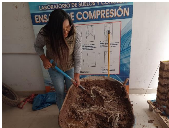
IMAGEN 19: Preparado de mezcla para junta con adición de cabuya.
