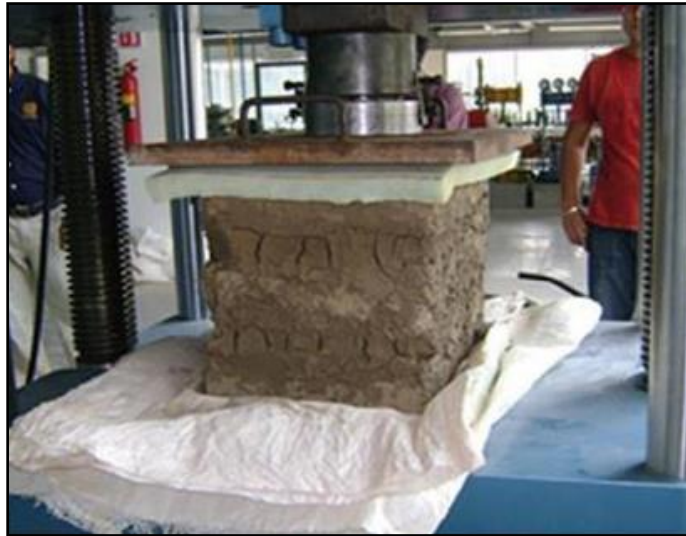
Figura 18. Ensayo a la resistencia a la compresión
