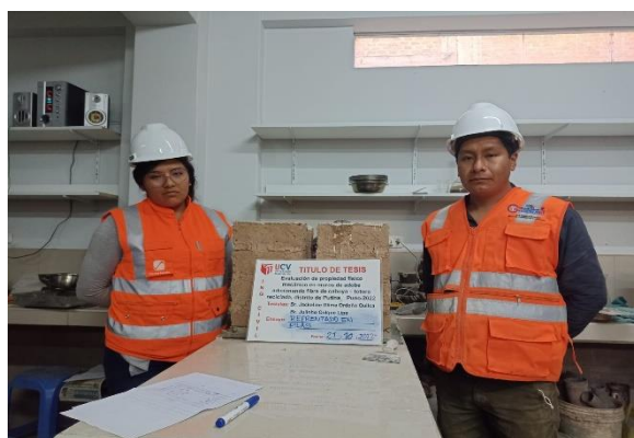
IMAGEN 21: Refrentado de muros en pila y bloques para el correcto ensayo.
