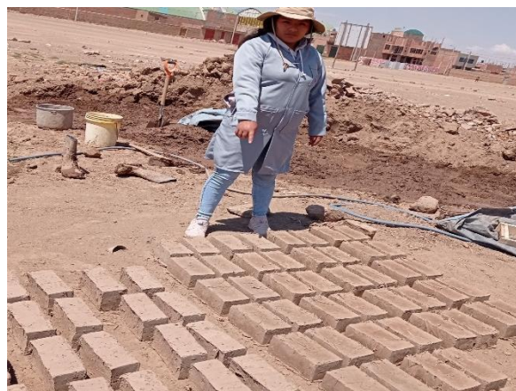
IMAGEN 17: Secado de bloques de adobe
