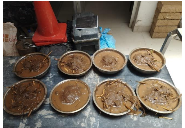
IMAGEN 12: Contenido de absorción de en unidades de bloques de adobe de 10*10*10
