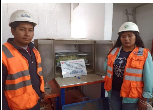
IMAGEN 10: Contenido de humedad de fibra de cabuya en 6 a 7%
