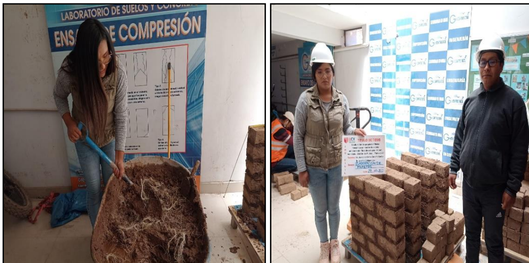
Figura 30. Armados de muretes de 0.65 \times 0.65 con juntas de cabuya
