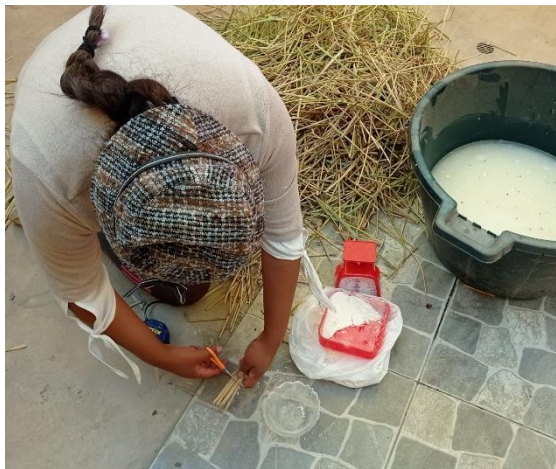
IMAGEN 4: Troceado de totora, en medidas de 4cm.
