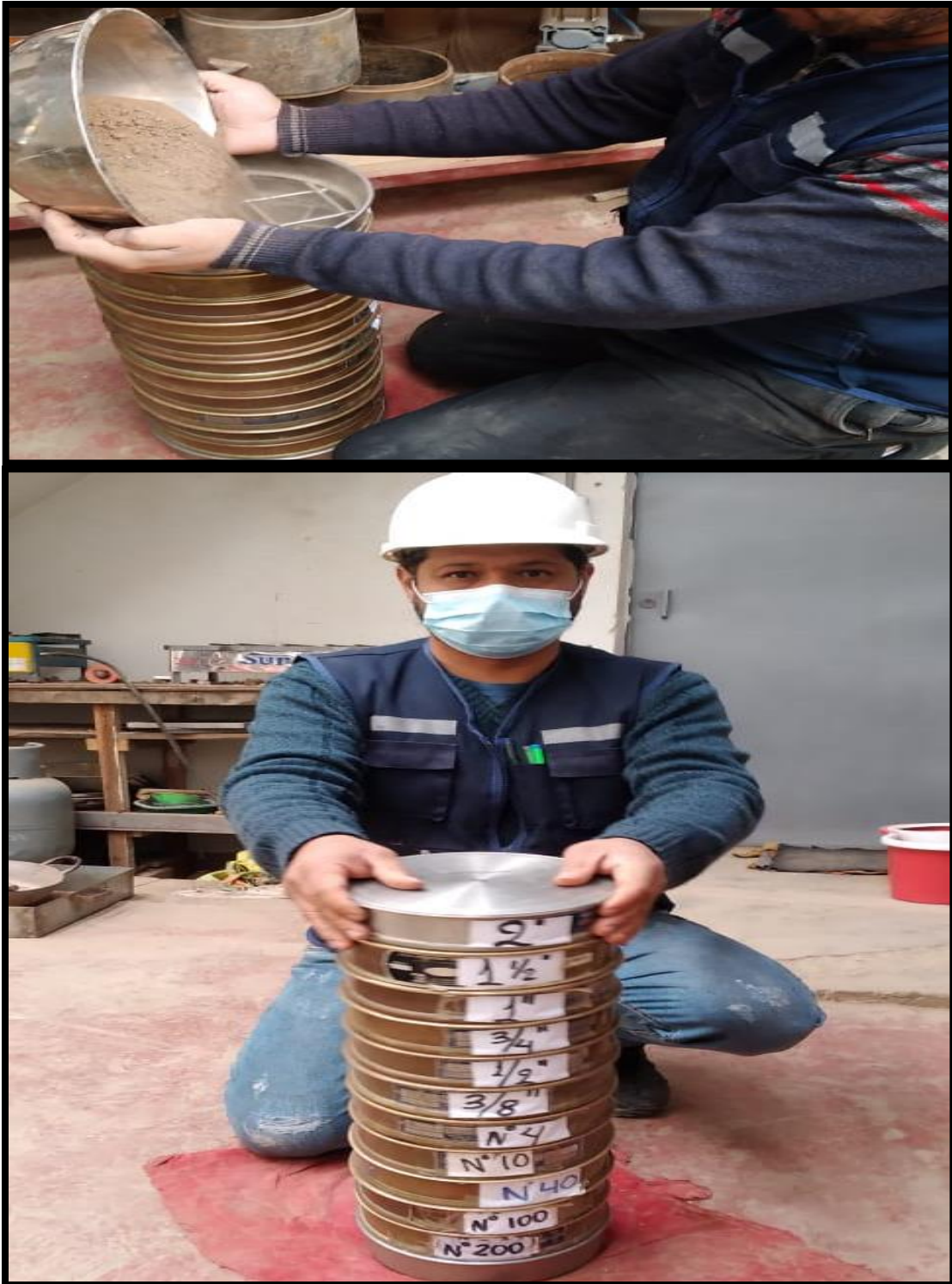
Figura 24. Tamizado, análisis granulométrico.
