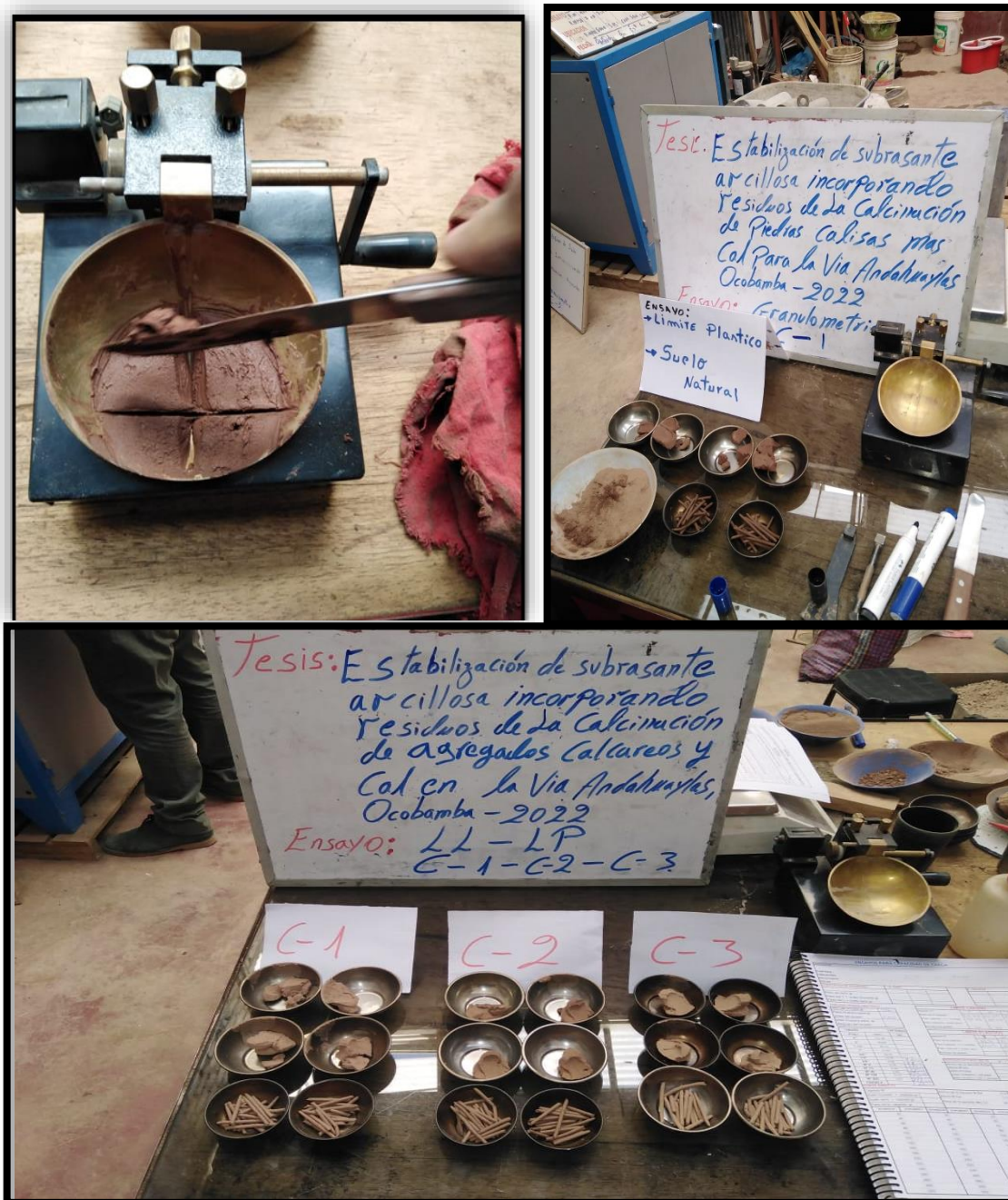
Figura 26. Proceso de LL, LP Y LC. Después de 24 horas
