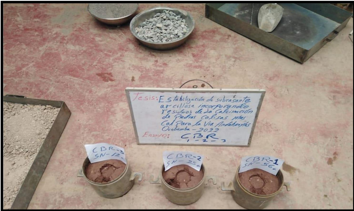
Figura 32. Ensayo de CBR con adición de cal 2% y RC 3%.
