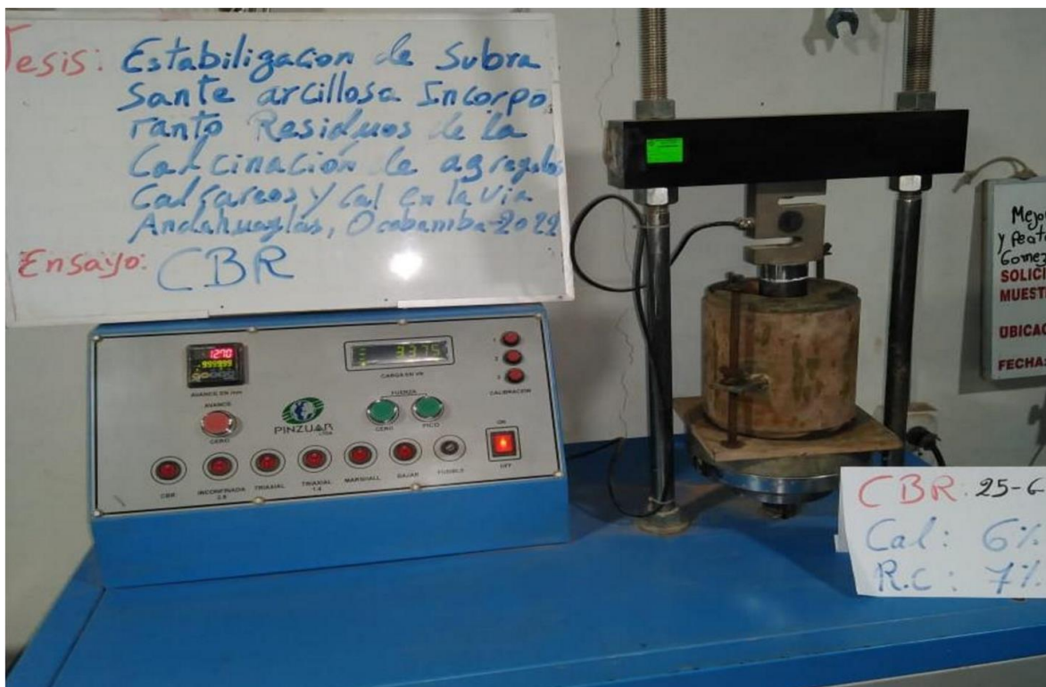
Figura 34. Ensayo de CBR con adición de cal 6% y RC 7%.
