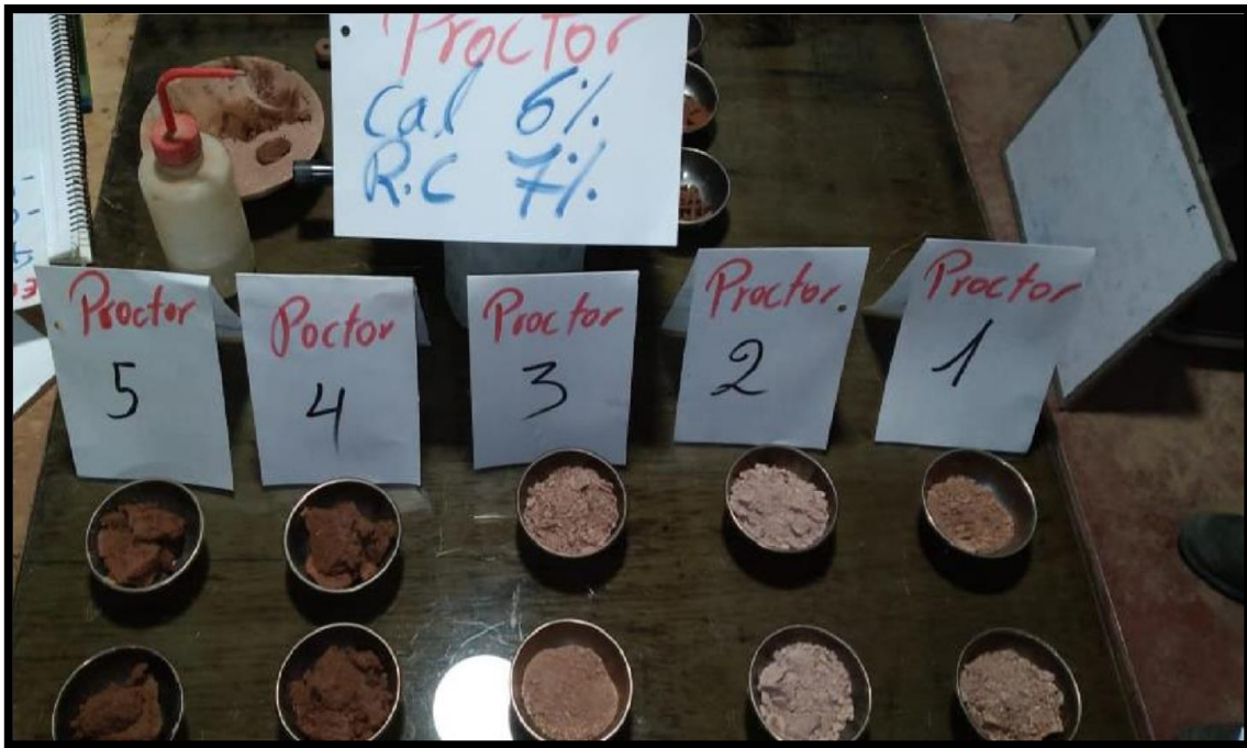
Figura 31. Proctor modificado con adición de cal 6% y RC 7%.
