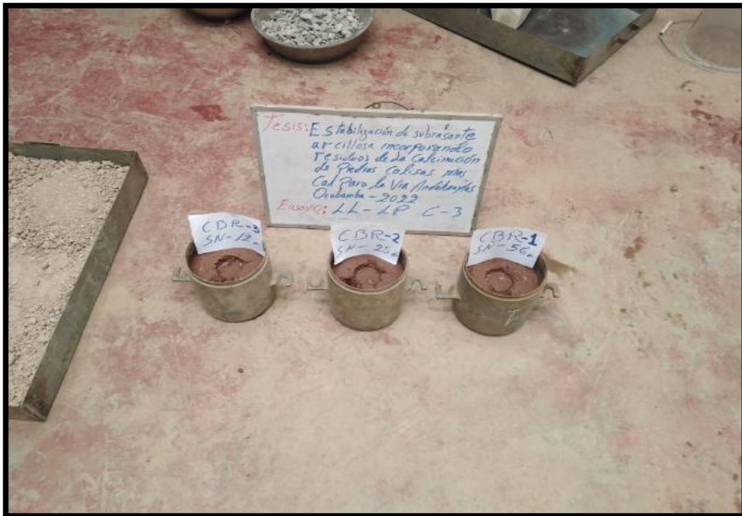
Figura 36. Ensayo de LL, LP muestra con adición de Cal 6%, RC 7%,
