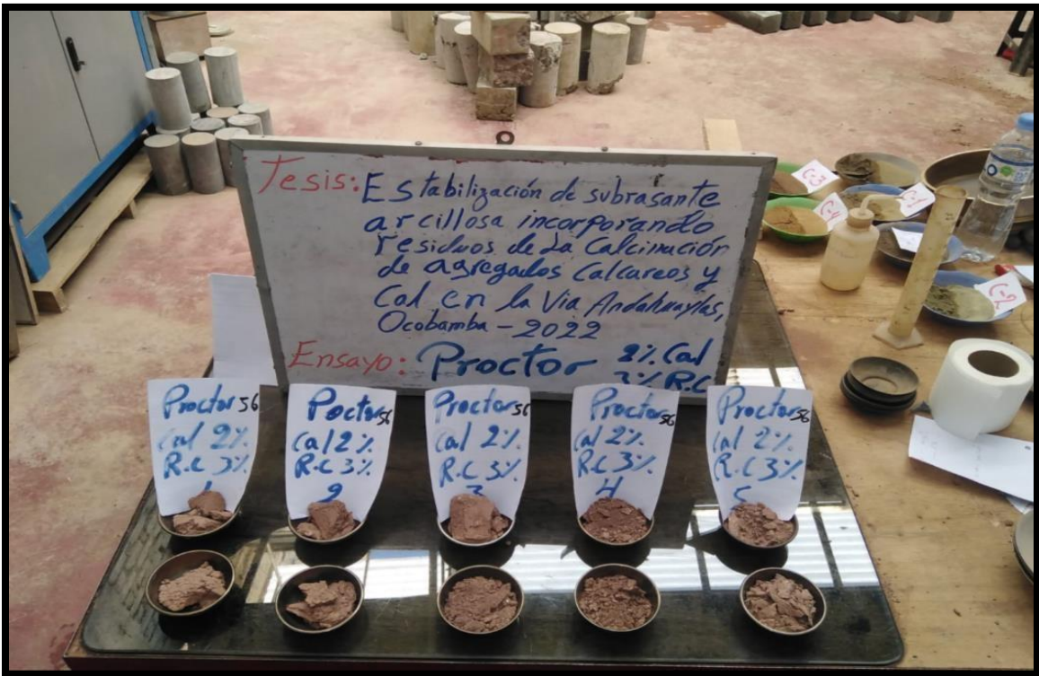
Figura 29. Muestra natural y con cal 2% y RC 3% para proctor.
