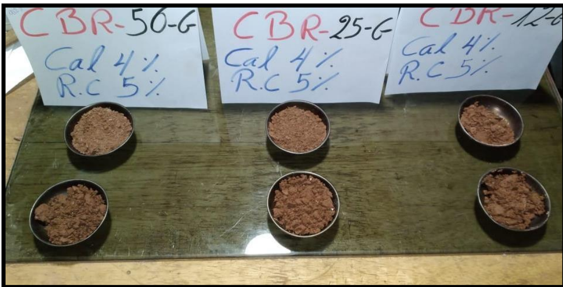
Figura 33. Ensayo de CBR con adición de cal 4% y RC 5%
