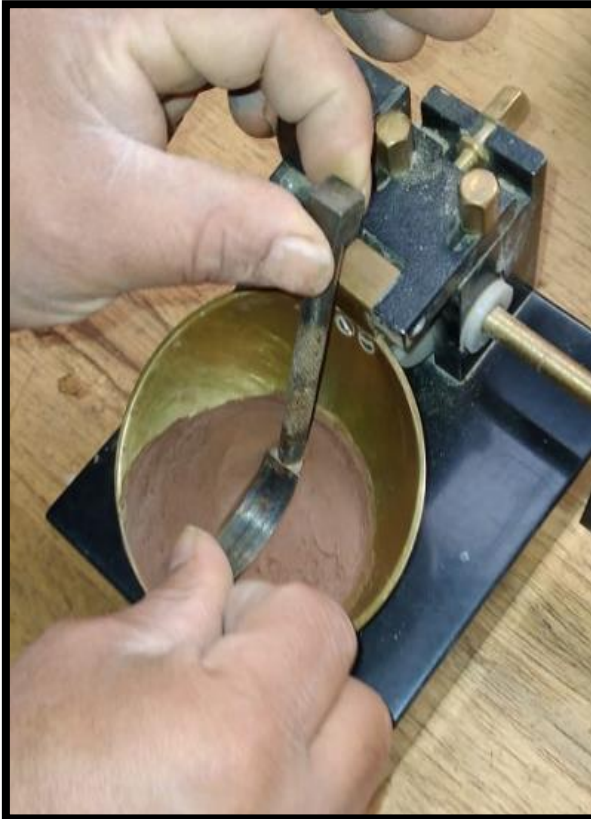
Figura 28. Determinación de límites de consistencia Fuente: propia, 2022
