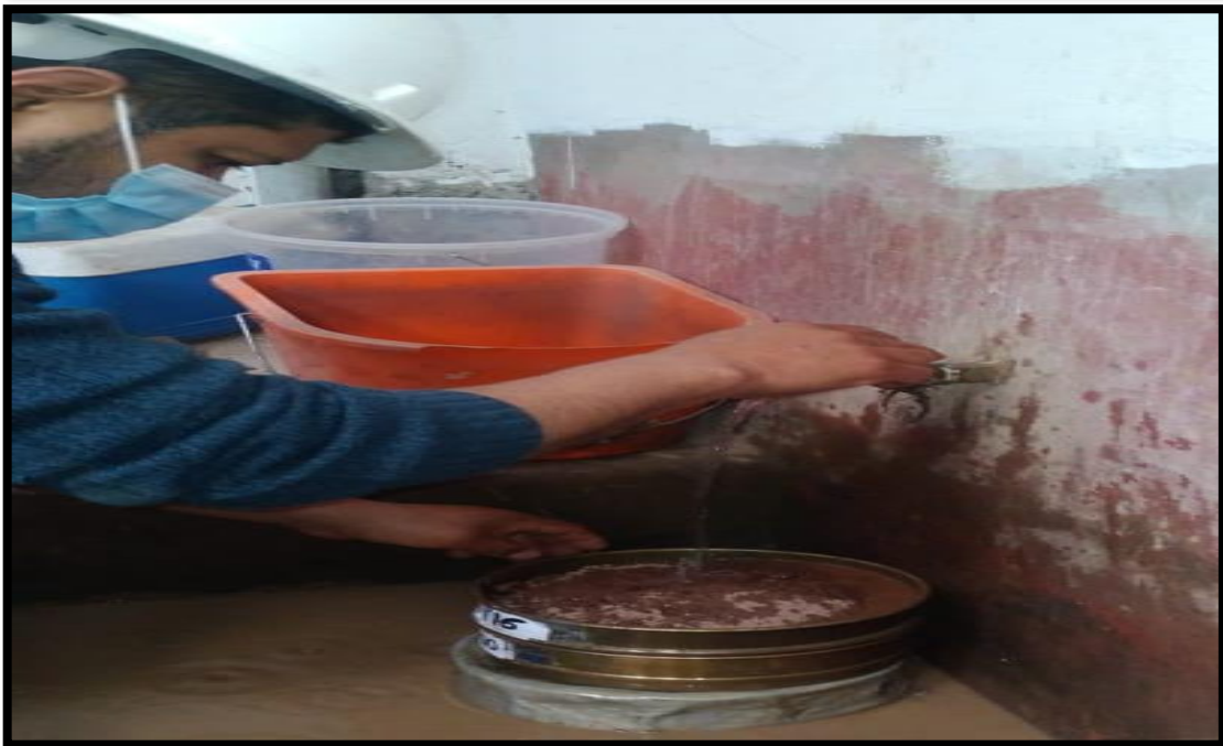
Figura 23. Lavado para análisis granulométrico
