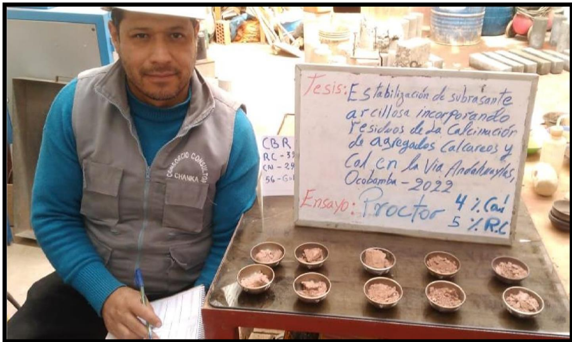
Figura 30. Proctor modificado con adición de cal 4% y RC 5%.
