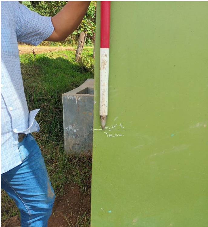
Figura 7-8. Marcación de BMs. Fuente: Elaboración propia.
