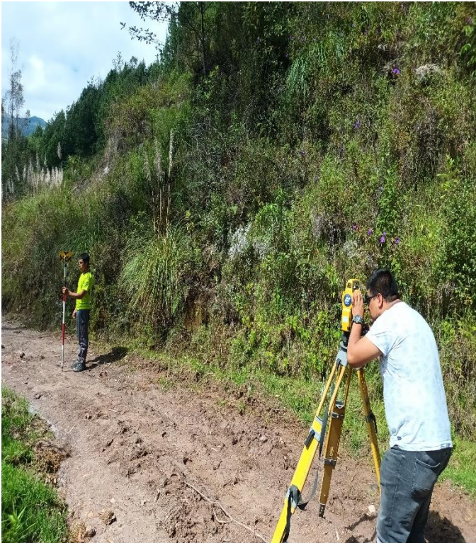
Figura 9-10. Toma de puntos de eje de trocha existente. Fuente: Elaboración propia.
