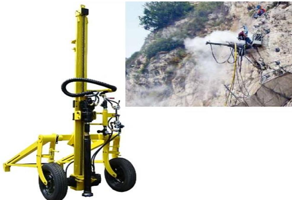
Figura 40: Perforadora AIRMOBIL432 tipo Wagon Dril
