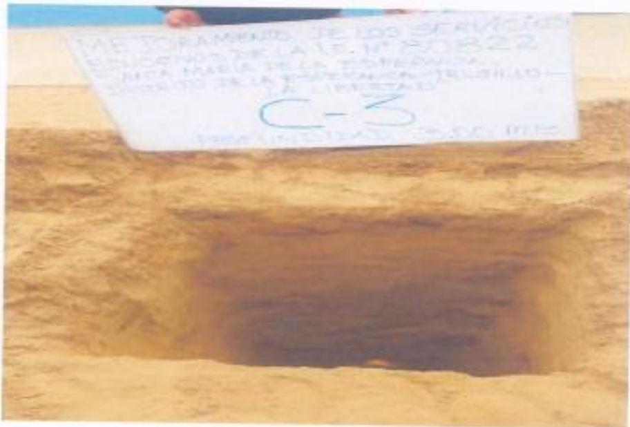
Fotos 10: Vista Panorámica de la Excavación de la calicata C-03, con un primer estrato superficial de 0.30 mts de suelo contaminado con material de relleno y orgánico, un segundo estrato de 2.70 mts de suelo de arena fina, de color beige
