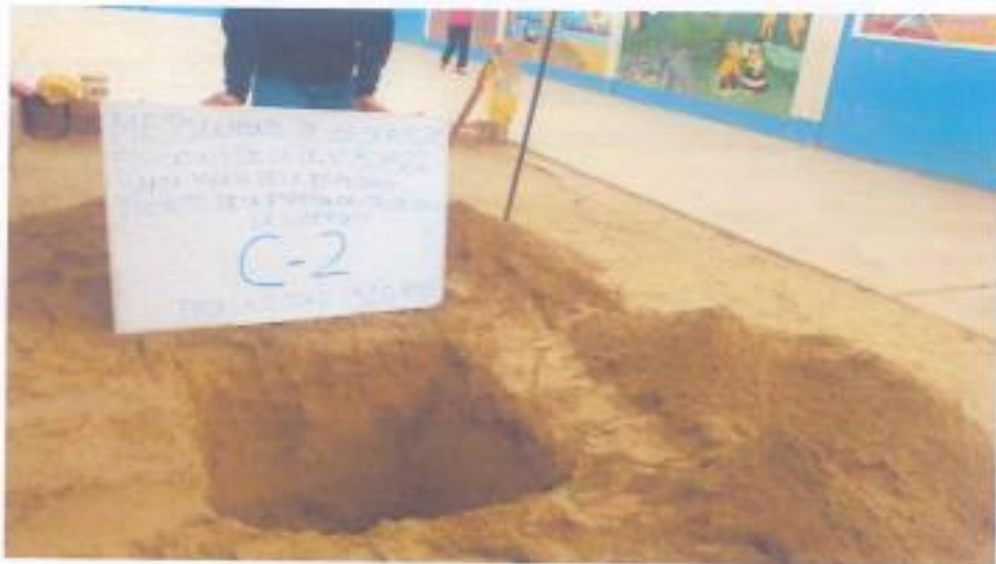
Fotos 08: Vista Panorámica de la Excavación de la calicata C-02, con un primer estrato superficial de 0.30 mts de suelo contaminado con material de relleno y orgánico, un segundo estrato de 2.70 mts de suelo de arena fina, de color beige
