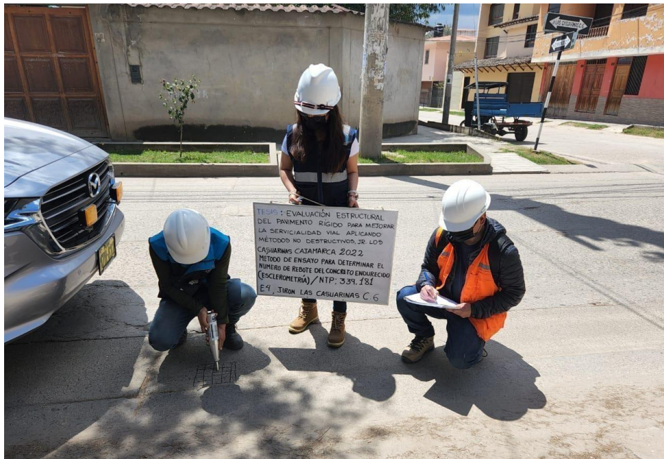
Foto N° 3: Ubicación del Ensayo estándar N°03 del número de rebote en concreto endurecido– Pavimento - Jr. Las Casuarinas Cuadra 7 (E-3).
