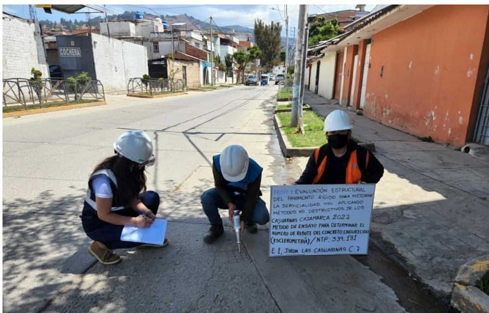
Foto N° 1: Ubicación del ensayo estándar N° 01 del número de rebote en concreto endurecido - pavimento - Jr. Las Casuarinas cuadra 7 (E-1).
