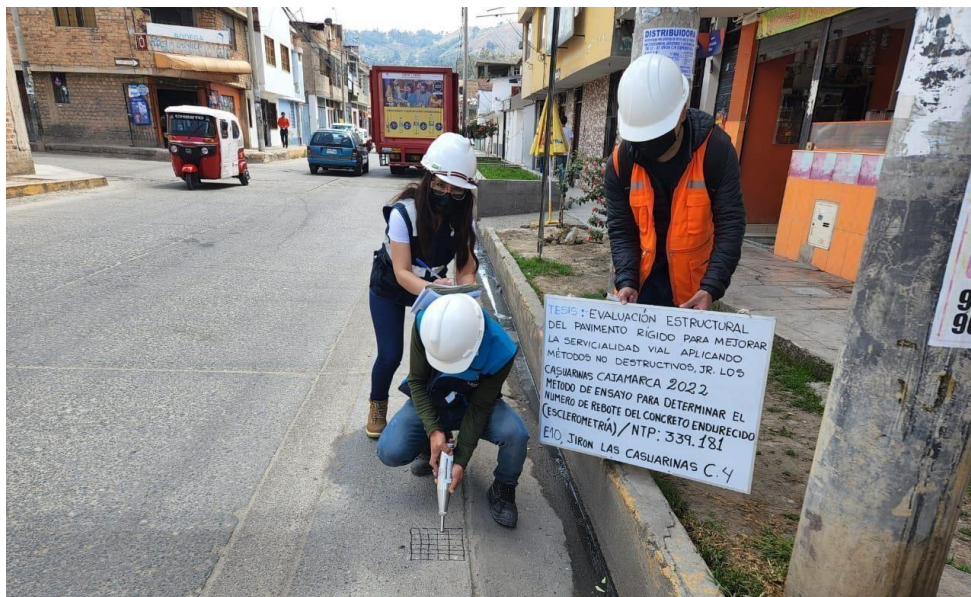
Foto N° 9: Ubicación del Ensayo estándar N°09 del número de rebote en concreto endurecido– Pavimento - Jr. Las Casuarinas Cuadra 5 (E-9).
