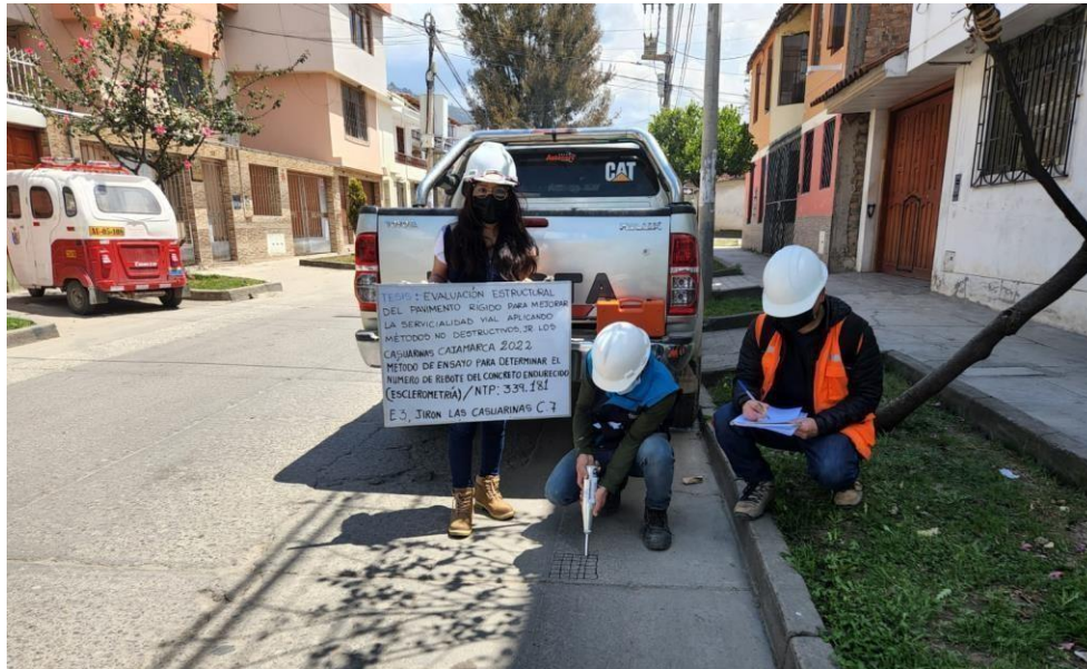
Foto N° 3: Ubicación del Ensayo estándar N°03 del número de rebote en concreto endurecido– Pavimento - Jr. Las Casuarinas Cuadra 7 (E-3).
