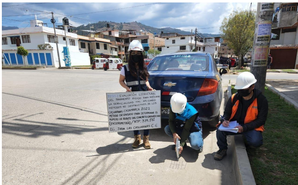
Foto N° 5: Ubicación del Ensayo estándar N°05 del número de rebote en concreto endurecido– Pavimento - Jr. Las Casuarinas Cuadra 6 (E-5).
