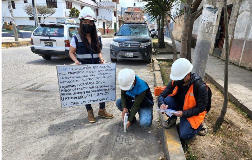
Foto N° 7: Ubicación del Ensayo estándar N°07 del número de rebote en concreto endurecido– Pavimento - Jr. Las Casuarinas Cuadra 5 (E-7).
