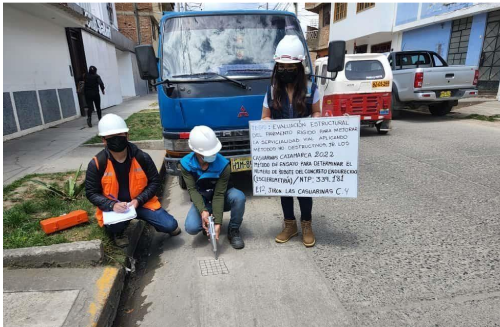
Foto N° 11: Ubicación del Ensayo estándar N°11 del número de rebote en concreto endurecido – Pavimento - Jr. Las Casuarinas Cuadra 4 (E-11).
