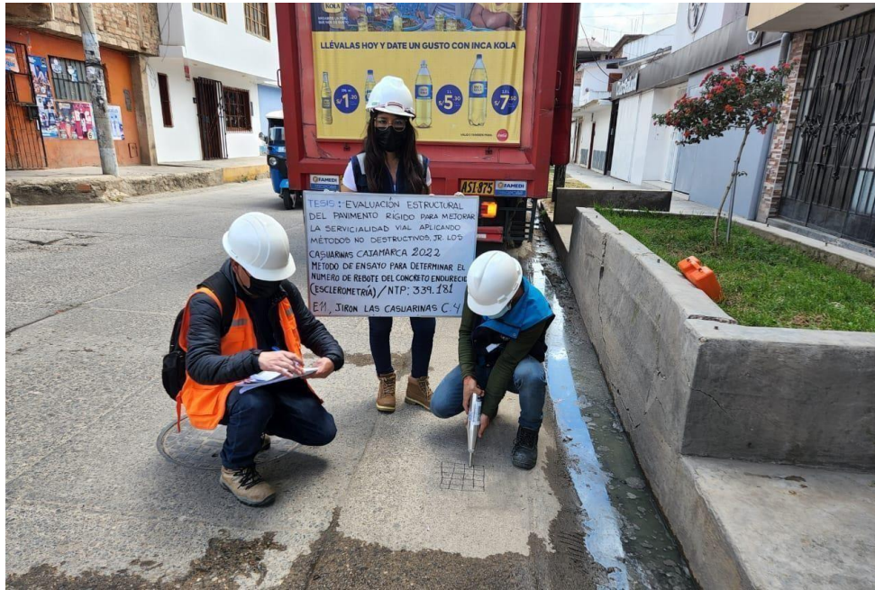
Foto N° 11: Ubicación del Ensayo estándar N°11 del número de rebote en concreto endurecido – Pavimento - Jr. Las Casuarinas Cuadra 4 (E-11).
