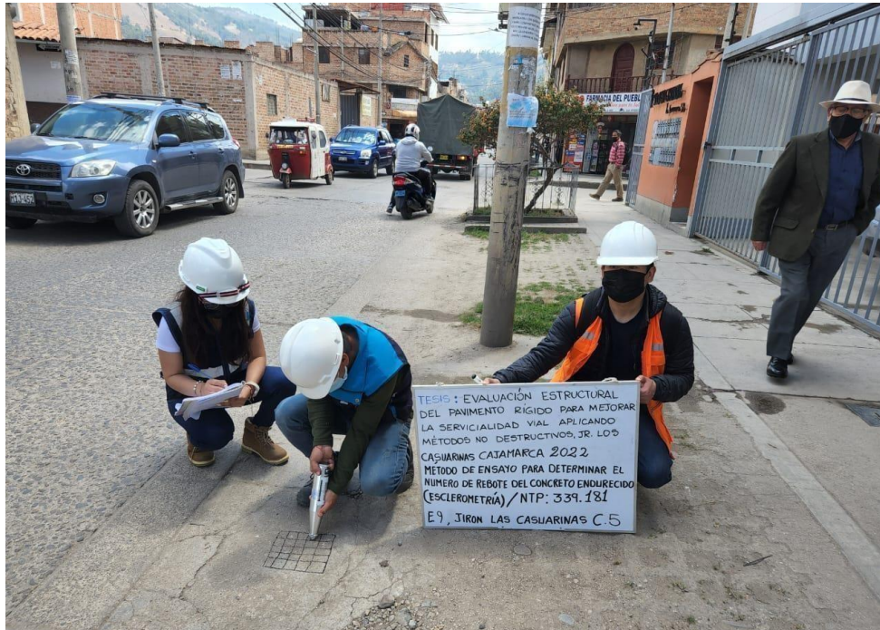
Foto N° 9: Ubicación del Ensayo estándar N°09 del número de rebote en concreto endurecido– Pavimento - Jr. Las Casuarinas Cuadra 5 (E-9).
