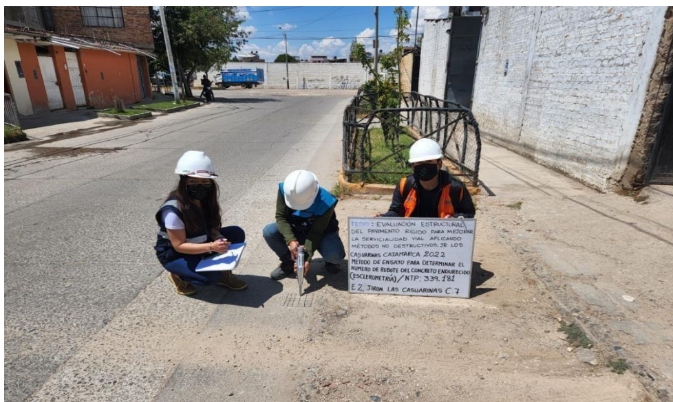
Foto N° 1: Ubicación del ensayo estándar N° 01 del número de rebote en concreto endurecido - pavimento - Jr. Las Casuarinas cuadra 7 (E-1).
