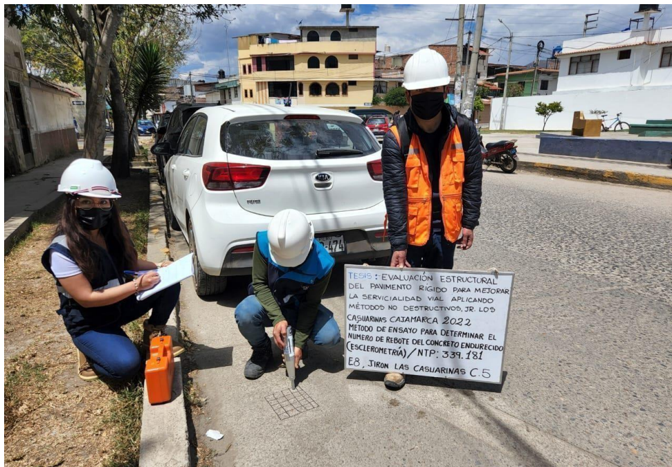
Foto N° 7: Ubicación del Ensayo estándar N°07 del número de rebote en concreto endurecido– Pavimento - Jr. Las Casuarinas Cuadra 5 (E-7).
