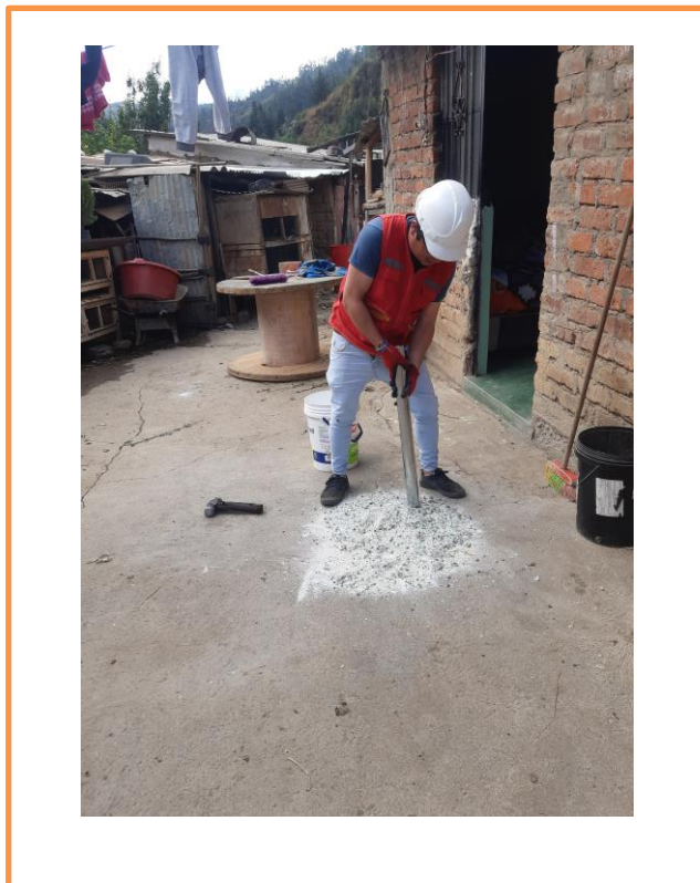
Fotografía 6. Triturando el vidrio hasta ser pulverizado
