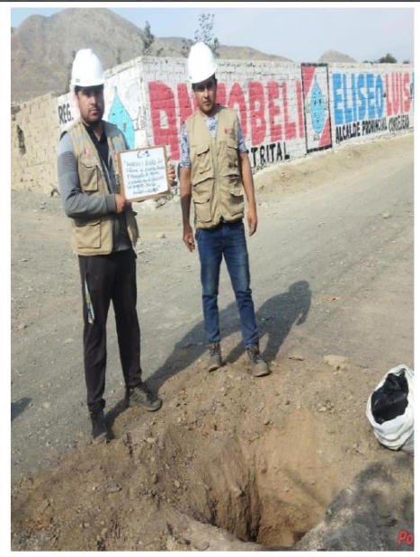
Foto N°01: Vista de ubicación de la C-01, presencia de Grava Mal Graduada con Limo y Arena (GP-GM) de compactidad compacta, ligeramente húmeda y de color beige claro de 0.00 a 1.50m.
