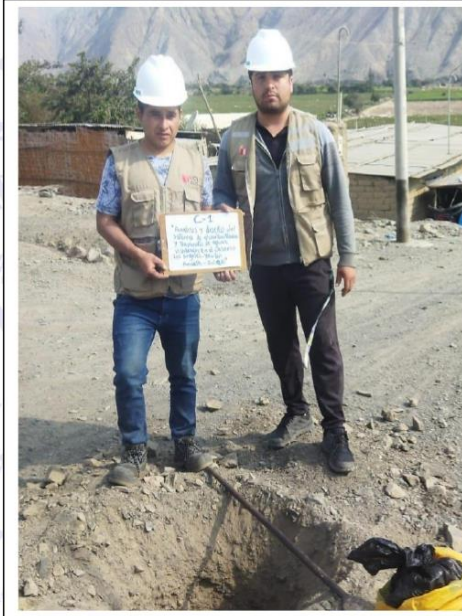
Foto N°01: Vista de ubicación de la C-01, presencia de Grava Mal Graduada con Limo y Arena (GP-GM) de compactidad compacta, ligeramente húmeda y de color beige claro de 0.00 a 1.50m.
