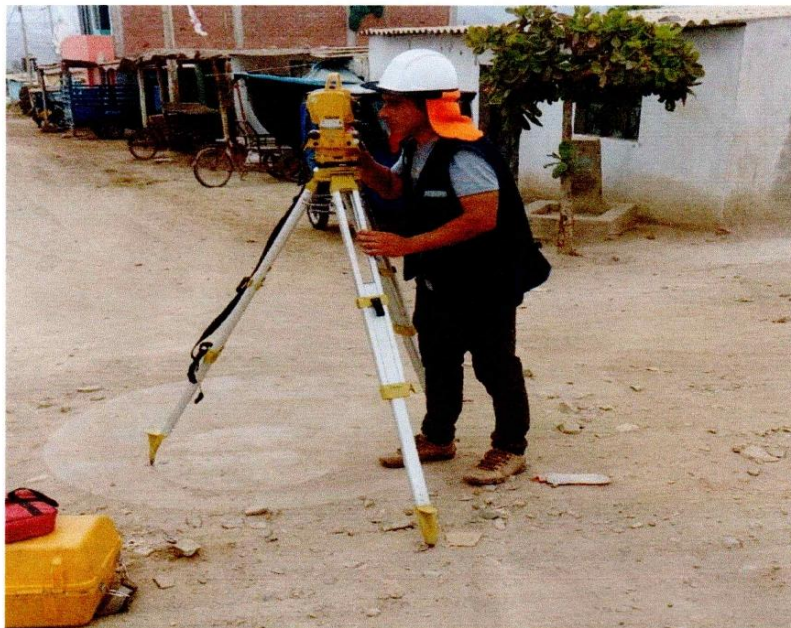
Foto N° 01: Trabajo de campo con Estación Total Leica.
