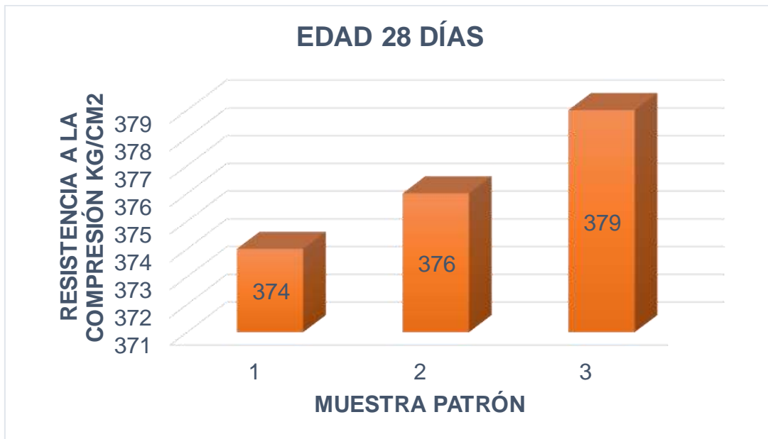
Figura 14: Ensayo de resistencia a la compresión porcentaje de sustitución 0% - muestra patrón
