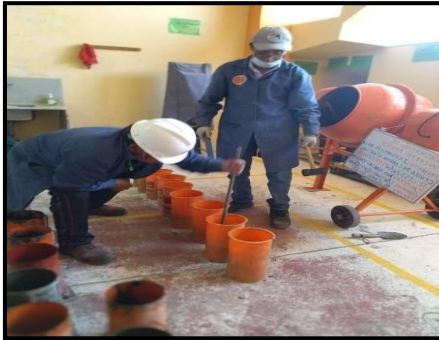
IMAGEN 07: 25 GOLPES CON BARILLA DE ACERO
