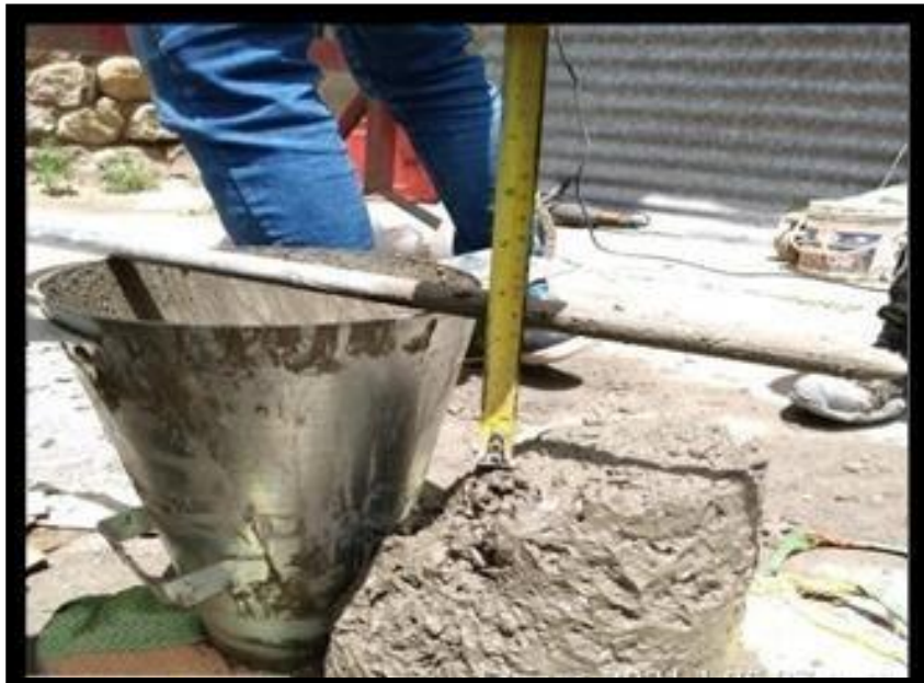
IMAGEN 06: PRUEBA DE ASENTAMIENTO
