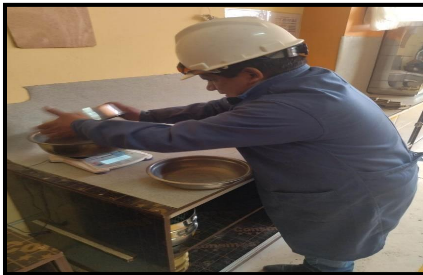
IMAGEN 02: DETERMINANDO EL PESO DEL AGREGADO
