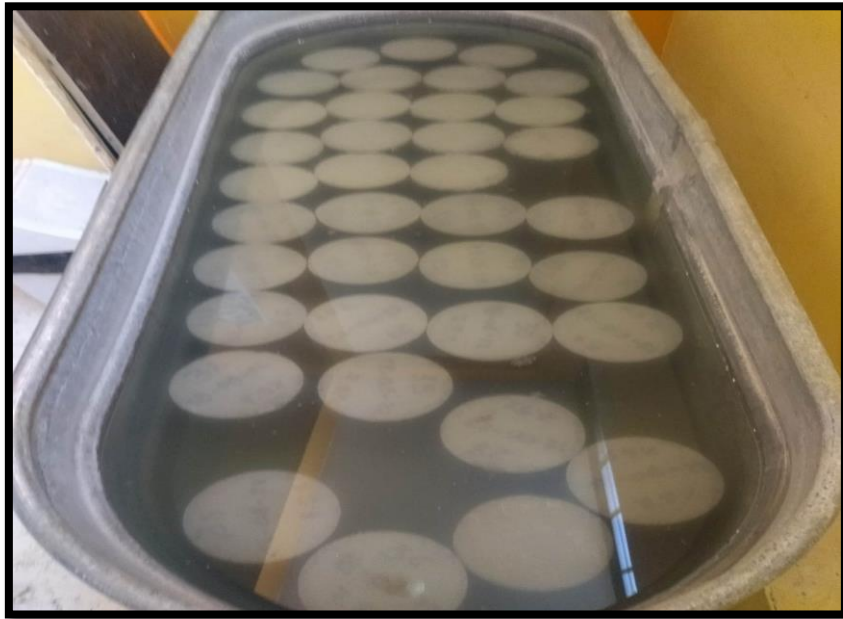
IMAGEN 09: CURADO DE PROBETAS
