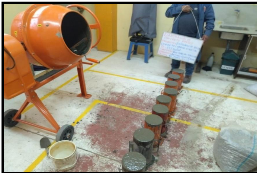
IMAGEN 08: CONCRETO EN ESTADO FRESCO
