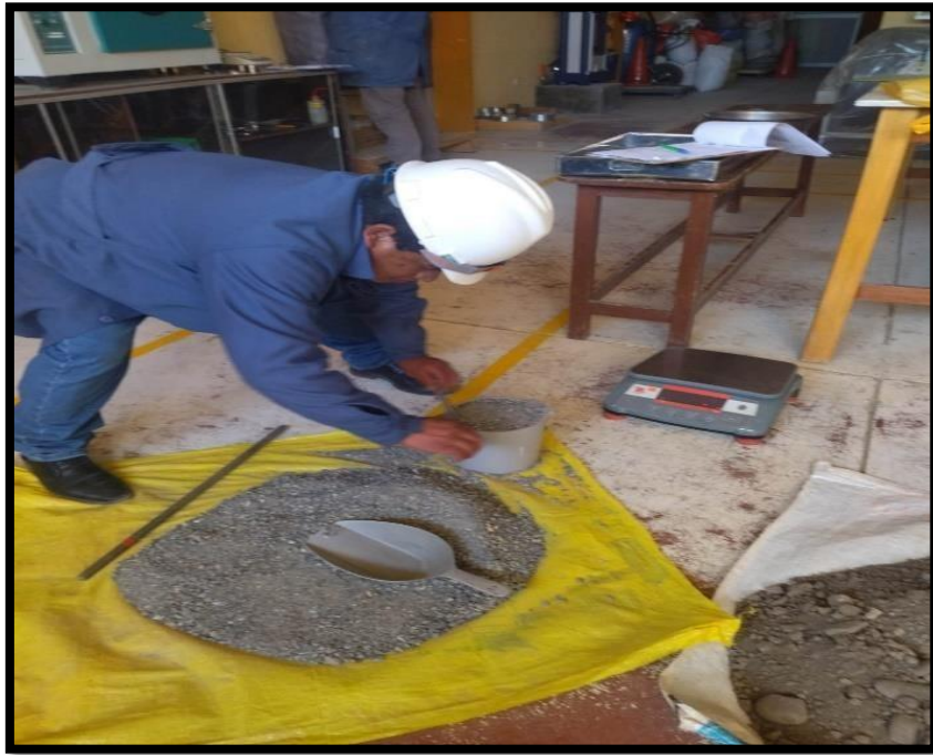
IMAGEN 05: PESADO DE AGREGADO FINO
