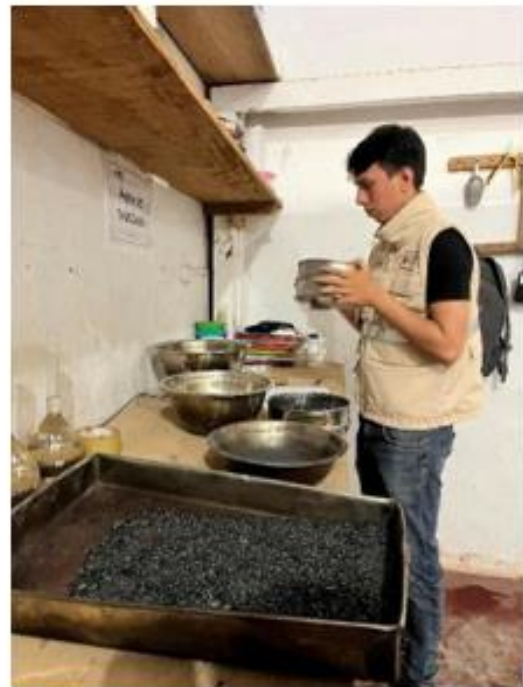
Tamizado de la ceniza de cascarilla de arroz, para ver el porcentaje de ceniza que retiene la malla y el porcentaje que pasa para ver la finura de la cascarilla de arroz
