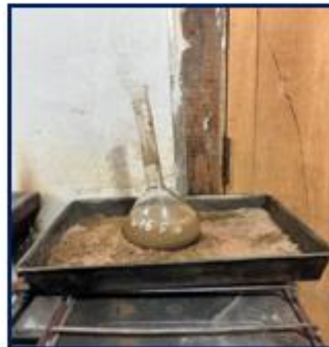
GRAVEDAD ESPECIFICA Y ABSORCION
