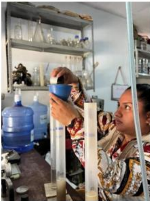
Ensayo de sales solubles del agregado fino para ver la disipación y los componentes de composiciones que no puedan afectar al concreto
