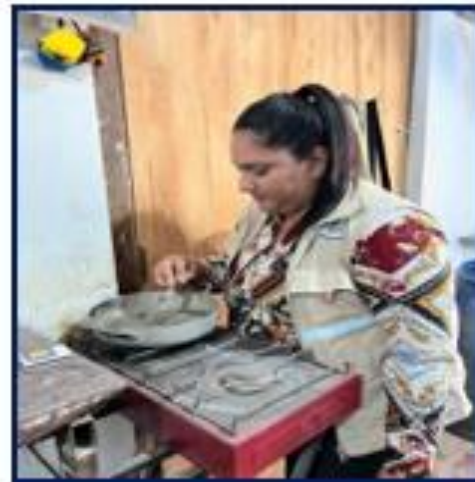
REALIZANDO EL LAVADO Y SECADO DE LOS AGREGADOS
