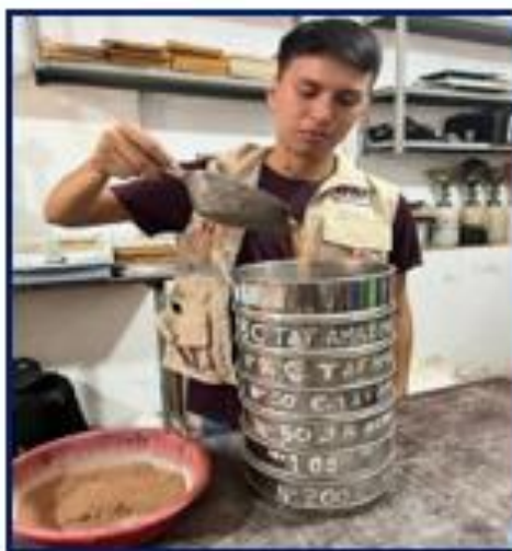
REALIZANDO EL ANALISIS GRANULOMETRICO DE LA COMBINACION DE AGREGADOS (ARENA NATURAL Y ARENA TRITURADA).
