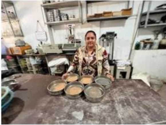
Ensayo de granulometría de los agregados, arena triturada y arena fina para ver el encaje de la curva granulométrica.
