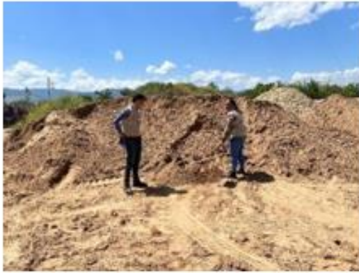
Recopilación de los agregados para las muestras y encaje de la curva granulométrica (arena fin, arena triturada)
