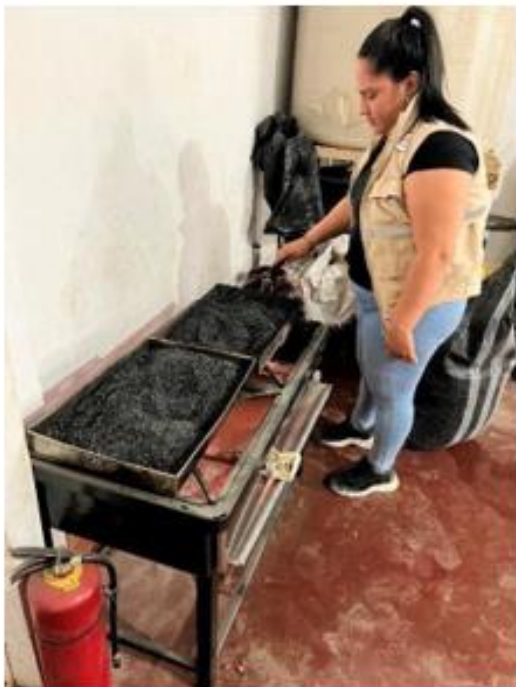
Calcinación de la cascarilla de arroz, a un estado de ceniza, haciendo uso de fuentes y una cocina
