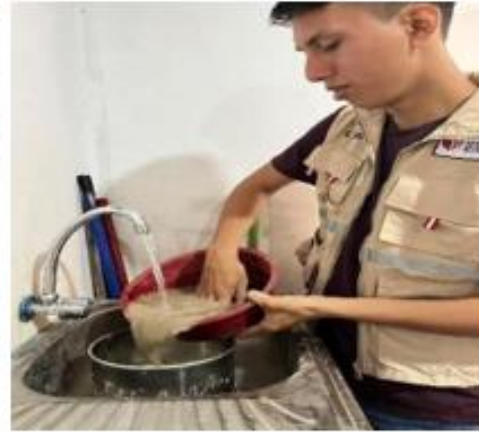
Lavado del material fino para ver porcentaje de impurezas y la calidad del material para sus respectivos ensayos mecánicos.
