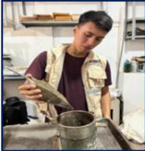
PESO UNITARIO SUELTO DEL AGREGADO FINO
