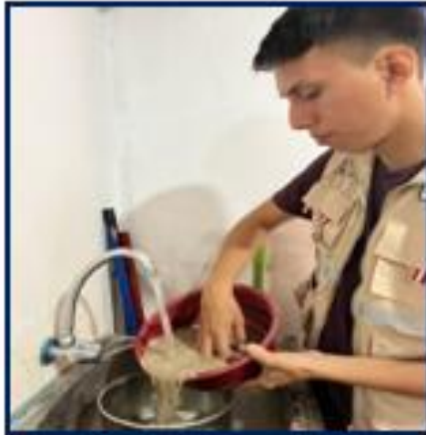
REALIZANDO EL LAVADO Y SECADO DE LOS AGREGADOS
