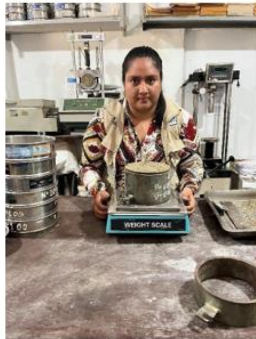
Ensayo de peso específico del agregado para tener en cuenta los porcentajes que encajaran en la curva granulométrica
