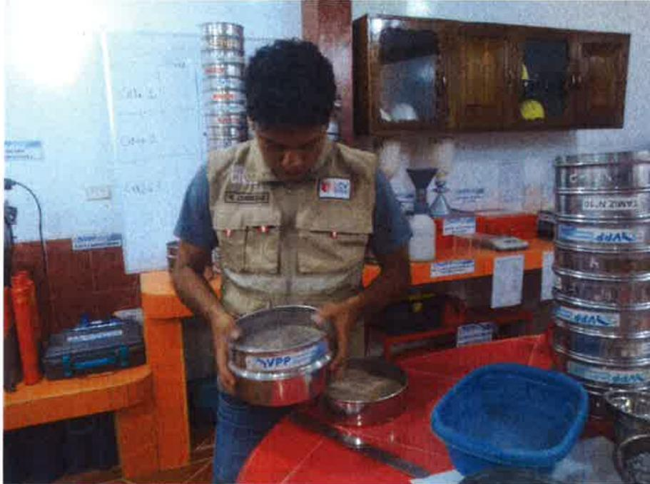
**SE OBSERVA A LOS TESISTAS, REALIZANDO LOS ENSAYOS EN EL LABORATORIO DE MECÁNICA DE SUELOS, CONCRETO Y ASFALTO – PESO UNITARIO SUELTO DEL AGREGADO FINO**
