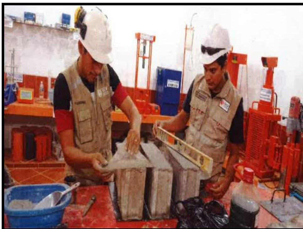
**Anexo 11:** En la imagen se muestra el capeado de los bloques de concreto
