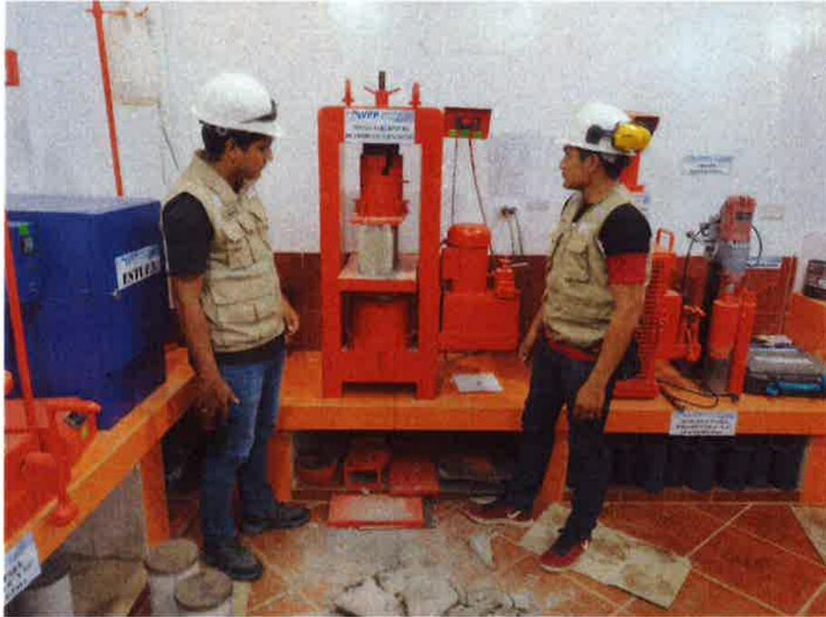
SE OBSERVA A LOS TESISISTAS, REALIZANDO EL ENSAYO DE RESISTENCIA A LA COMPRESION DEL BLOQUE DE CONCRETO
