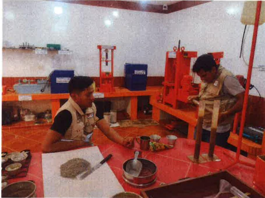
**SE OBSERVA A LOS TESISISTAS, REALIZANDO LOS ENSAYOS EN EL LABORATORIO DE MECÁNICA DE SUELOS, CONCRETO Y ASFALTO – EQUIVALENTE DE ARENA - AGREGADO FINO**
