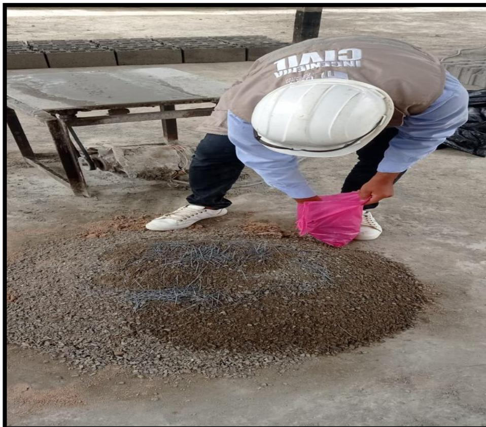
**Anexo 13:** En la imagen se muestra los bloques de concreto con adición de dramix 3D
