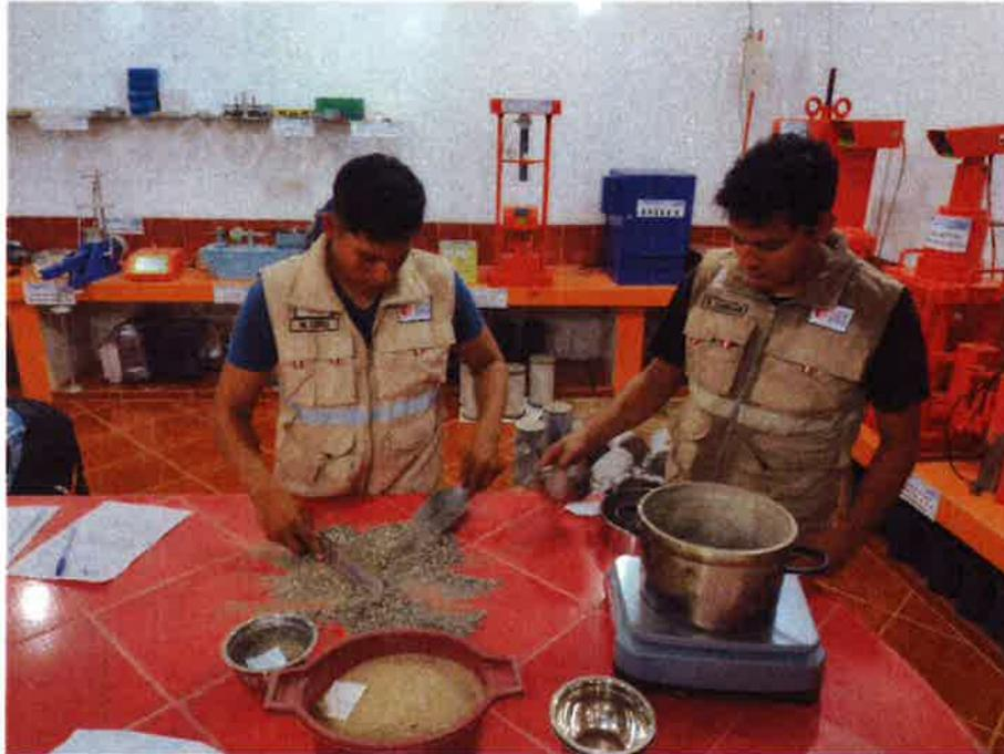
**SE OBSERVA A LOS TESISISTAS, REALIZANDO LOS ENSAYOS EN EL LABORATORIO DE MECÁNICA DE SUELOS, CONCRETO Y ASFALTO, CONCRETO Y ASFALTO – CUARTEO Y PESO DE MUESTRAS PARA POSTERIOR REALIZAR EL LAVADO DE MUESTRAS.**
