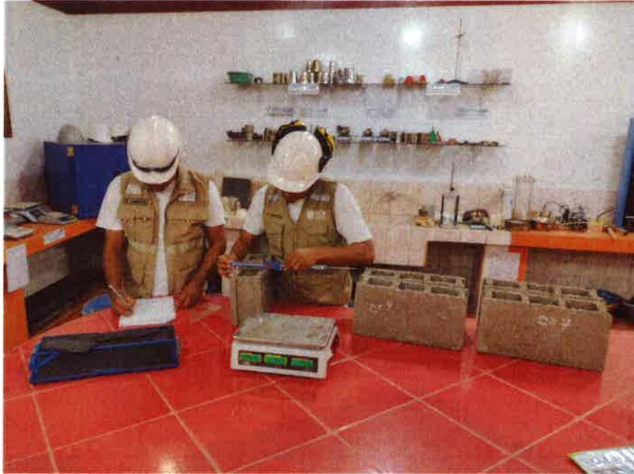
SE OBSERVA A LOS TESISTA, MIDIENDO LOS BLOQUES DE CONCRETO
