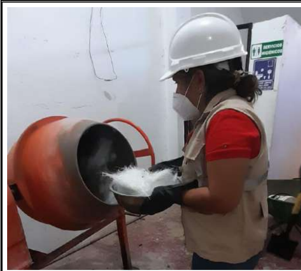
Fotos n° 09-10: En las imágenes podemos apreciar los materiales a utilizar para el diseño de concreto con adición fibra de vidrio Tipo "e"
