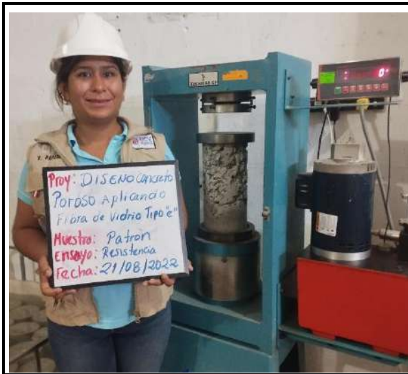
Fotos n° 19-20: En las imágenes podemos observar la resistencia a la compresión axial de los testigos de concreto
