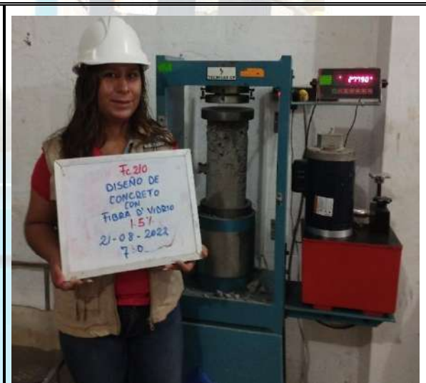
Fotos n° 17-18: En las imágenes podemos observar la resistencia a la compresión axial de los testigos de concreto
