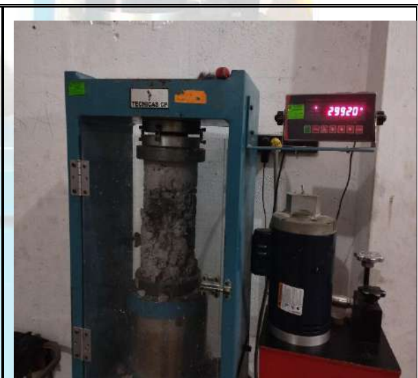
Fotos n° 25-26: En las imágenes podemos observar la resistencia a la compresión axial de los testigos de concreto.
