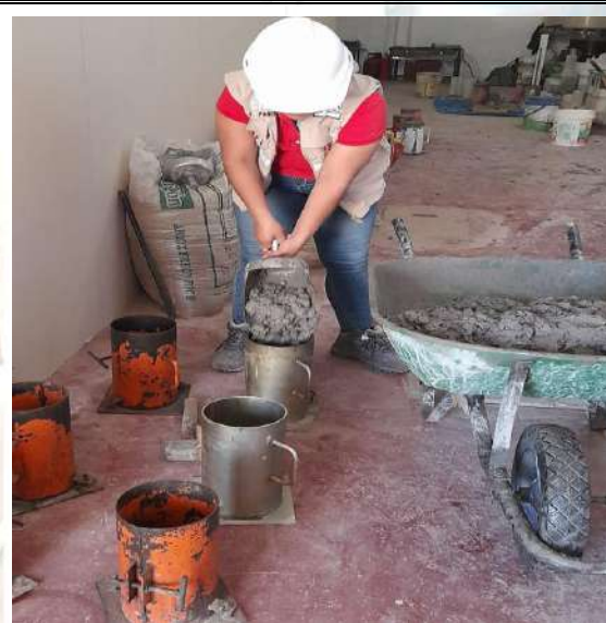
Fotos n° 13-14: En las imágenes podemos observar al personal realizando el moldeo de los testigos de concreto.
