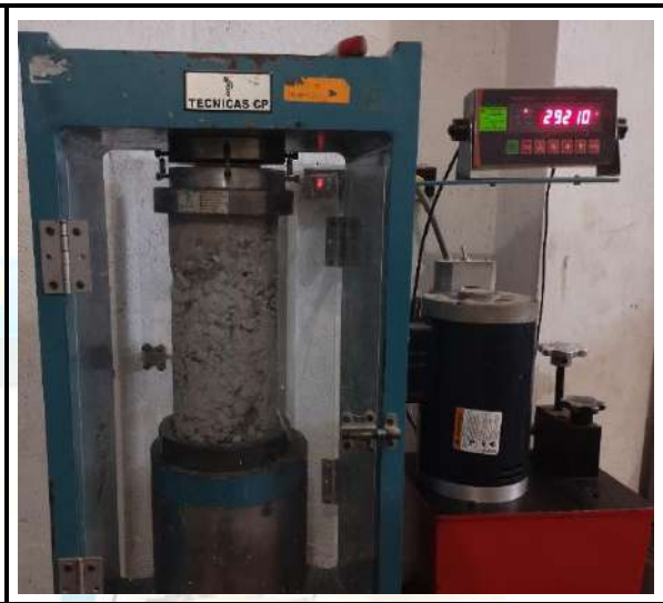
Fotos n° 19-20: En las imágenes podemos observar la resistencia a la compresión axial de los testigos de concreto
