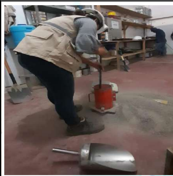
Fotos n° 07-08: En las imágenes podemos observar realización del ensayo de peso unitario.
