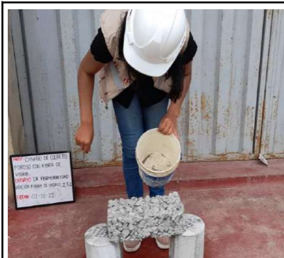
Fotos n° 33-34: En las imágenes podemos observar el ensayo de permeabilidad
