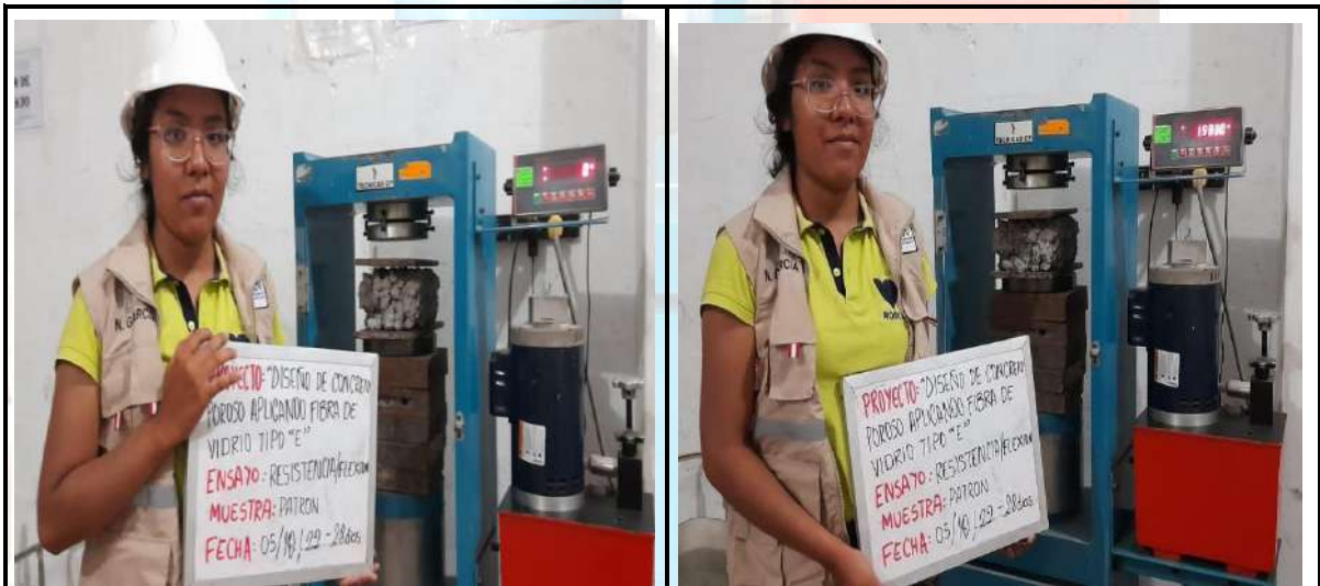
Fotos n° 27-28: En las imágenes podemos observar la resistencia a la Flexión de los testigos de concreto
