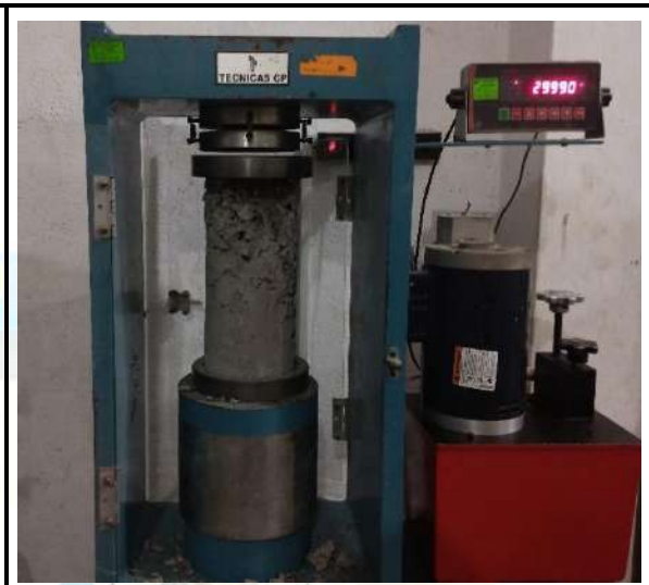
Fotos n° 23-24: En las imágenes podemos observar la resistencia a la compresión axial de los testigos de concreto
