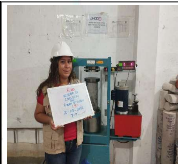
Fotos n° 17-18: En las imágenes podemos observar la resistencia a la compresión axial de los testigos de concreto
