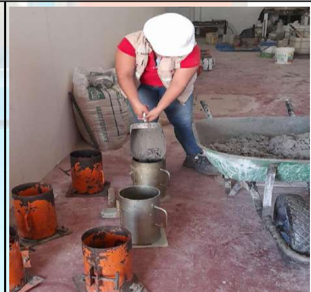
Fotos n° 13-14: En las imágenes podemos observar al personal realizando el moldeo de los testigos de concreto.
