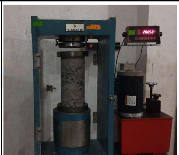
Fotos n° 15-16: En las imágenes podemos observar la resistencia a la compresión axial de los testigos de concreto
