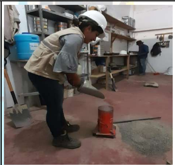
Fotos n° 07-08: En las imágenes podemos observar realización del ensayo de peso unitario.
