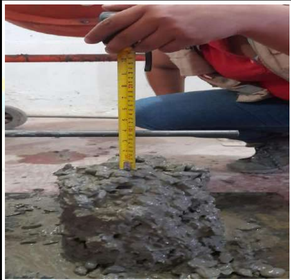
Fotos n° 11-12: En las imágenes podemos observar al personal realizando la prueba de asentamiento para los diseños de Mezclas.
