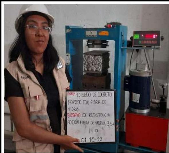
Fotos n° 31-32: En las imágenes podemos observar la resistencia a la Flexión de los testigos de concreto
