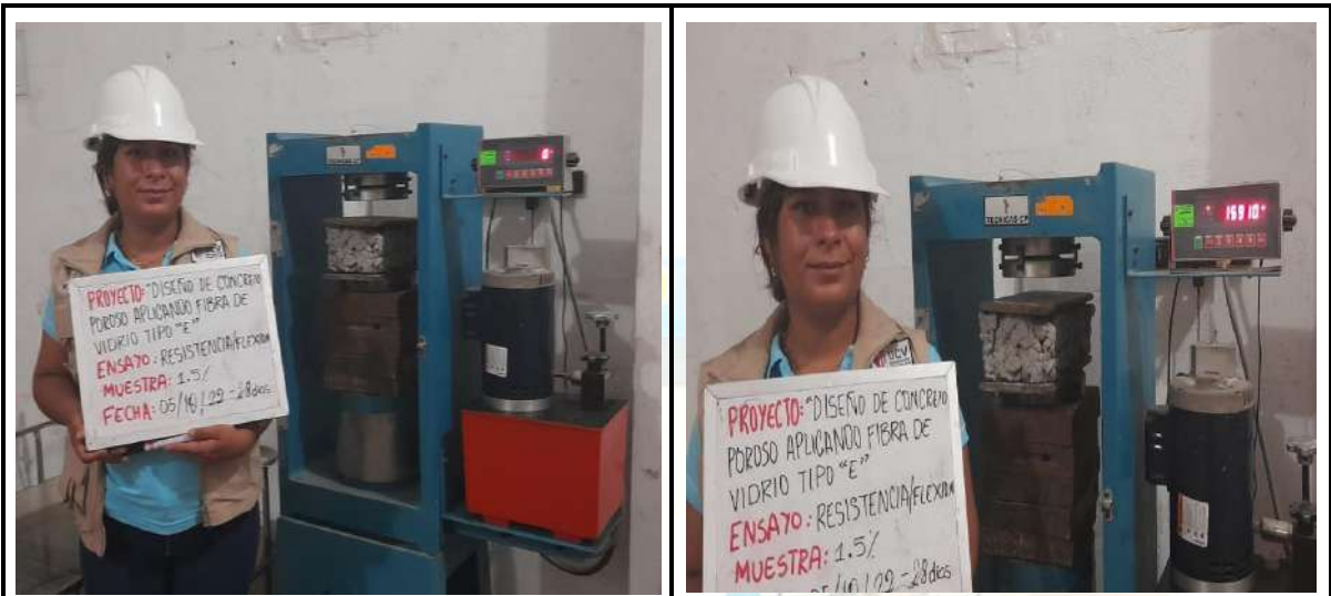
Fotos nº 29-30: En las imágenes podemos observar la resistencia a la Flexión de los testigos de concreto
