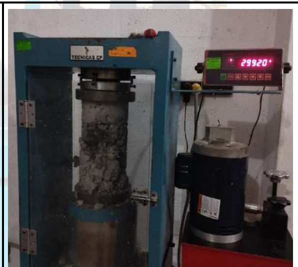
Fotos n° 21-22: En las imágenes podemos observar la resistencia a la compresión axial de los testigos de concreto
