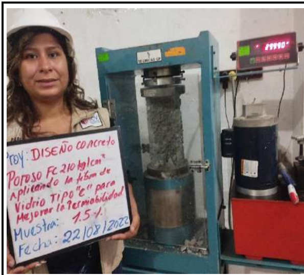
Fotos n° 23-24: En las imágenes podemos observar la resistencia a la compresión axial de los testigos de concreto
