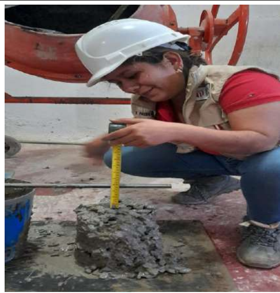
Fotos n° 11-12: En las imágenes podemos observar al personal realizando la prueba de asentamiento para los diseños de Mezclas.
