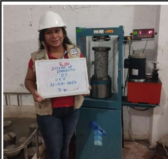
Fotos n° 15-16: En las imágenes podemos observar la resistencia a la compresión axial de los testigos de concreto
