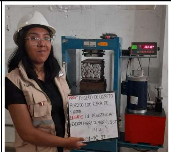
Fotos n° 31-32: En las imágenes podemos observar la resistencia a la Flexión de los testigos de concreto
