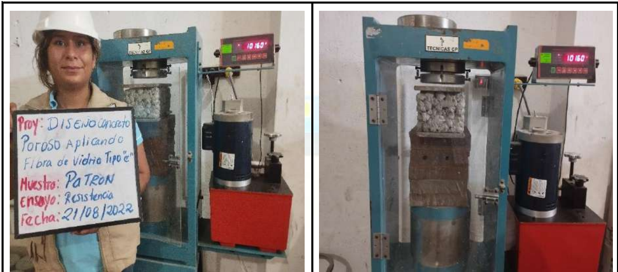
Fotos n° 25-26: En las imágenes podemos observar la resistencia a la Flexión de los testigos de concreto
