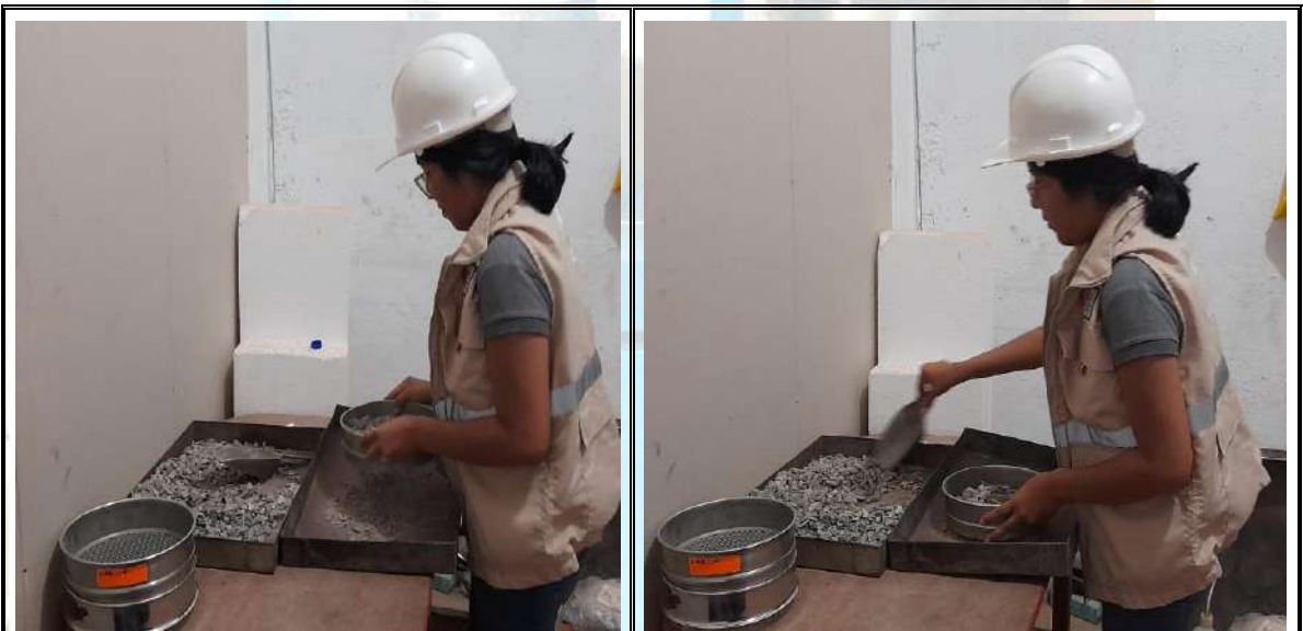
Fotos n° 03-04: En las imágenes se puede apreciar el ensayo de análisis granulométricos.
