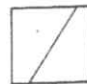
Tipo 5 Fracturas en los lados en las partes superior e inferior; cabezales no adheridos
