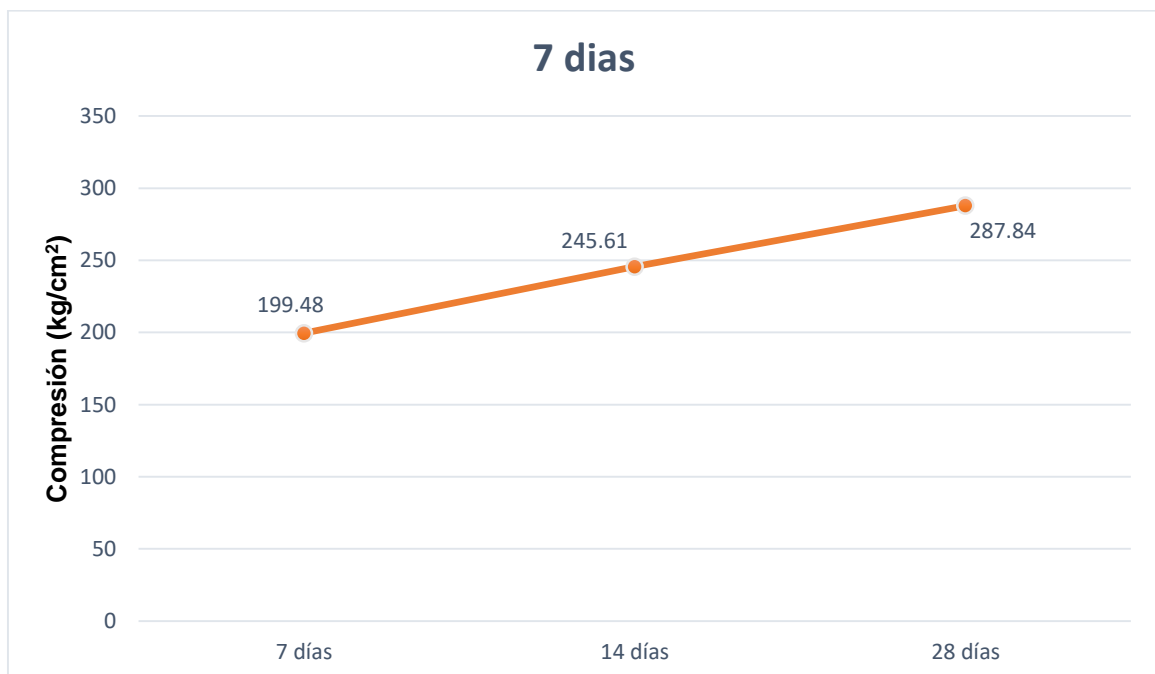
Figura 5 Aguante a ser comprimido del concreto con aditamento de cristal reciclado al 5% en sustitución del agregado fino.
