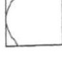
Tipo 7 Fisuras verticales encolumnadas a través de ambos extremos, conos no bien formados
